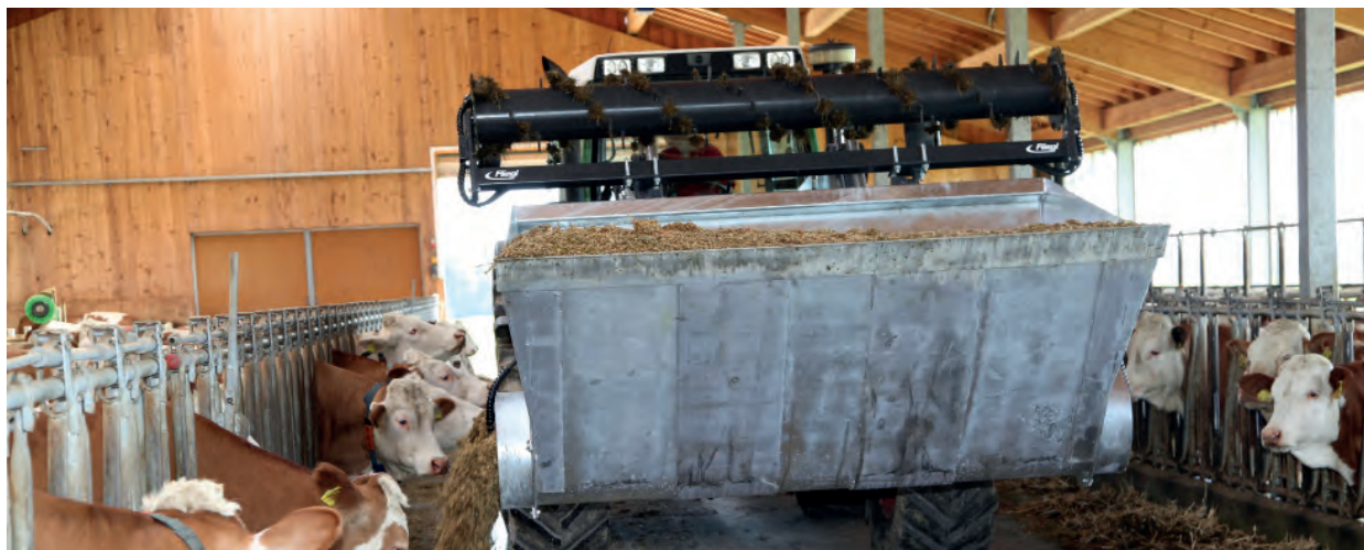
Ábrán takarmányozó kanállal (aprítóhenger külön vásárolható)
