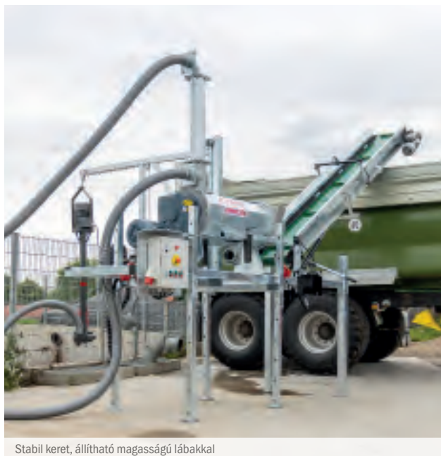
Stabil keret, állítható magasságú lábakkal
