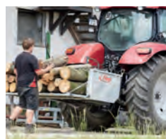
A kihajtható mobil fal meghosszabbítja a vályút
