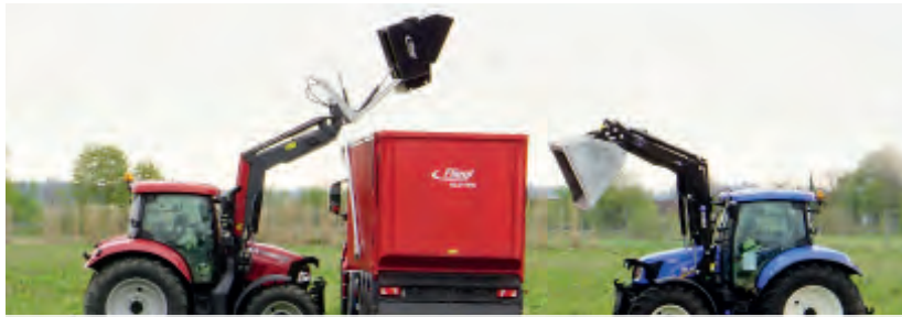
A különböző billentési magasságok szemléltetése azonos homlokrakodónál
