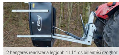
2 hengeres rendszer a legjobb 111°-os billentési szöghöz
