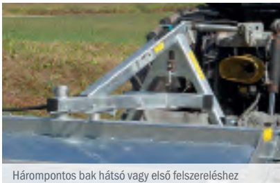
Hárompontos bak hátsó vagy első felszereléshez
