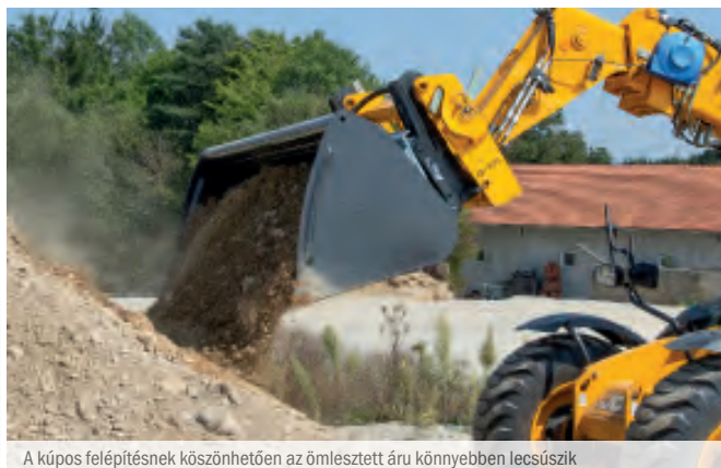
A kúpos felépítésnek köszönhetően az ömlesztett áru könnyebben lecsúszik
