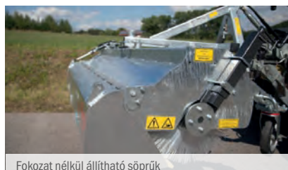
Fokozat nélkül állítható söprű
