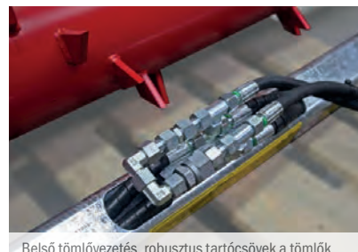
Belső tömlővezetés, robusztus tartócsövek a tömlők legjobb védelméért
