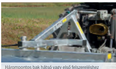
Hárompontos bak hátsó vagy első felszereléshez
