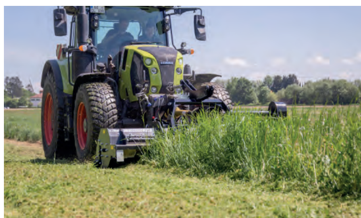
Állítható fedél a mulcs biztos lerakásához
