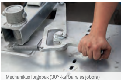
Mechanikus forgóbak (30°-kal balra és jobbra)
