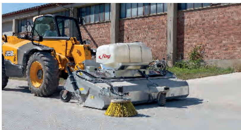
Fokozat nélkül állítható söprű, a legszélső kopáshatárig koptatható
