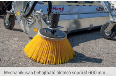
Mechanikusan behajtható oldalsó söprű Ø 600 mm
