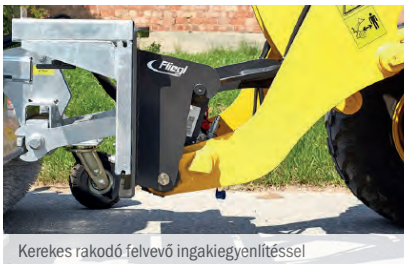
Kerekes rakodó felvevő ingaki egyenlítéssel
