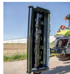
Rendkívül kopásálló kalapácscsapok
