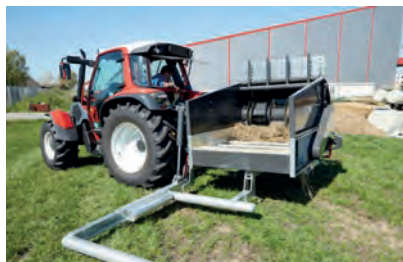
Ábrán a felvevőkar hidraulikus beállítás
