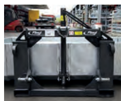
Felvételi lehetőségek: Euronorm- és hárompont-, valamint targoncafellevő
