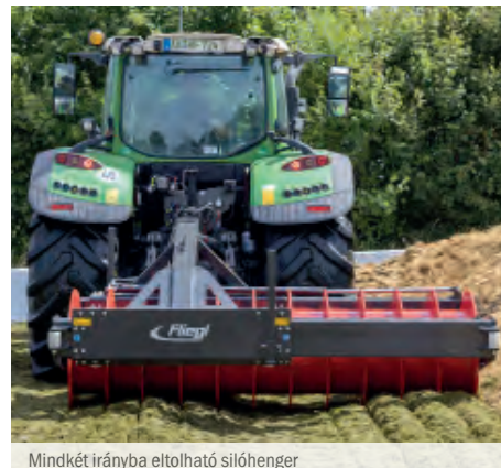
Mindkét irányba eltolható silóhenger
