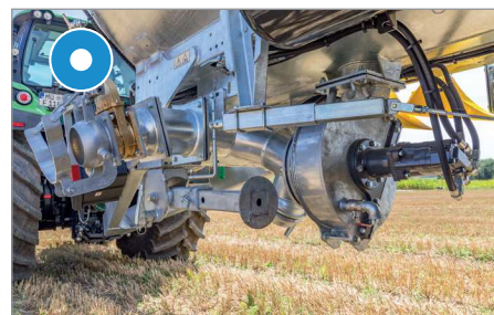
Vákuumos tartálykocsi esetén: turbótöltő a tartály alatt középen – mindkét oldali szíváshoz
