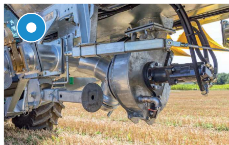
Vákuumos tartálykocsik esetén: turbótöltő a tartály alatt középen – mindkét oldali felszíváshoz
