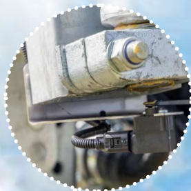
Dőlésszögmérő szenzorok mindkét oldalon a szárnyak megfelelő kinyitásához és becsukásához lejtőn
