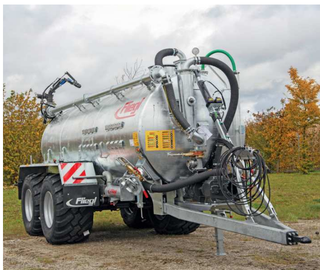
VFW 14000 Individual Garda-szivattyúval
