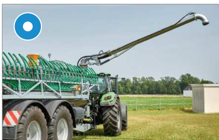
Csak pumpás tartálykocsik esetén: 8"-os szívókar, hossza 5 m
