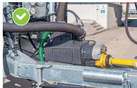
Hőálló kompresszor Opció: vízhűtéses kompresszor
