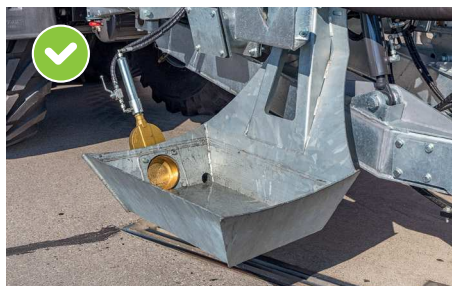
Csepegtető edény feltöltő szívócsőhöz automatikus ürítéssel a szántóföldön
