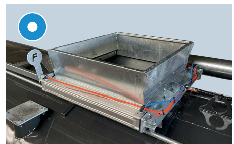
Pneumatikus tolótető a felső töltéshez
