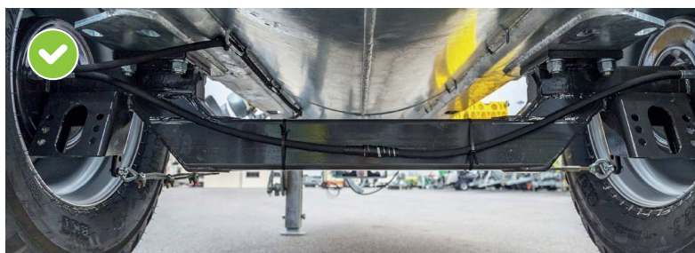
Hajlított tengely 5.000 liter és 8.600 liter közötti tartálykocsiknál Alacsony súlypont az emelkedőn/lejtőn való jobb menettulajdonságért
