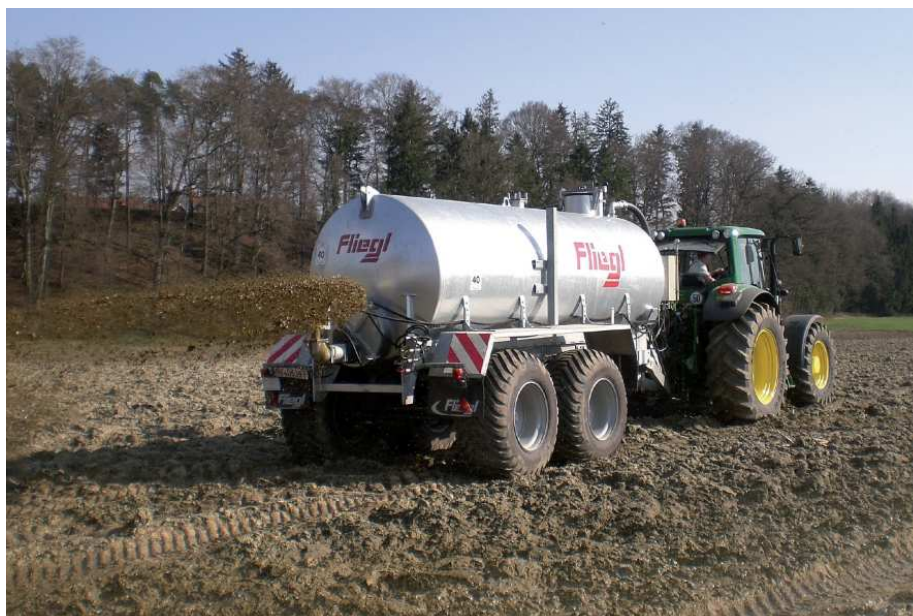
Csóváló terítő a nagy cseppekben történő kijuttatáshoz
