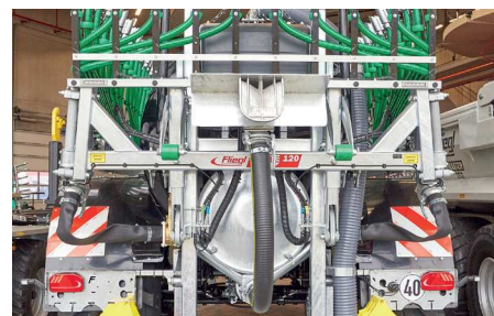
További kijuttatási lehetőség csatlakoztatott ütközőfejes elosztóval
