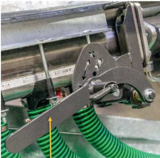
A karon a lyuk mérete mechanikusan beállítható.
