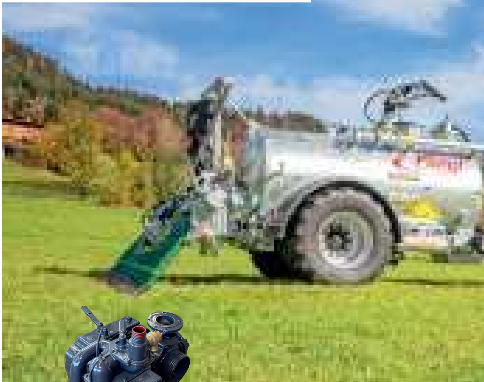
GARDA-Pumpa: A centrifugálszivattyú és kompresszor kombinációja
