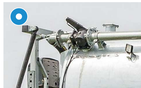
Nyomóvezeték háromutas szeleppel a legjobb keverés érdekében
