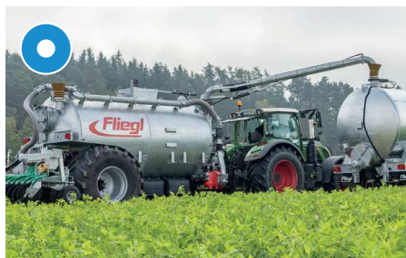
8"-os hidraulikusan forgatható szívókar
