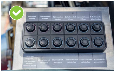
Vezérlés külső működtetéssel (csak forgódugattyús szivattyúval együtt)
