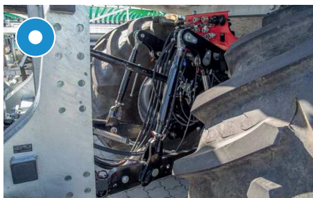
A hárompontos hidraulikát a tengelykormányzás irányítja.
