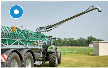
Csak pumpás tartálykocsik esetén: 8"-os felső szívókar, hossza 5 m
