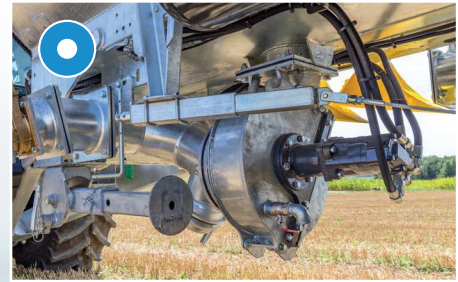
Vákuumos tartálykocsik esetén: turbótöltő a tartály alatt középen – mindkét oldali felszíváshoz
