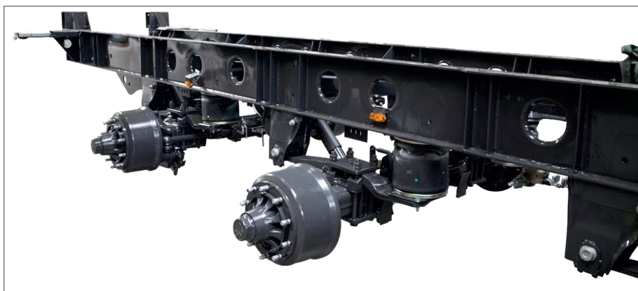
Speciális vázszerkezet finomszemcsés acélból
