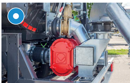
Vogelsang VX 186-260 Q nagy teljesítményű forgódugattyús szivattyú utószívó-funkcióval a hígtrágyatömlő teljes ürítéséhez
