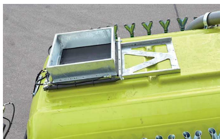
Pneumatikus vagy hidraulikus tolótető (600 x 600 mm)
