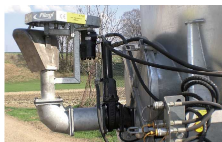
Hidraulikus csóváló terítő 12-18 méteres munkaszélességgel
