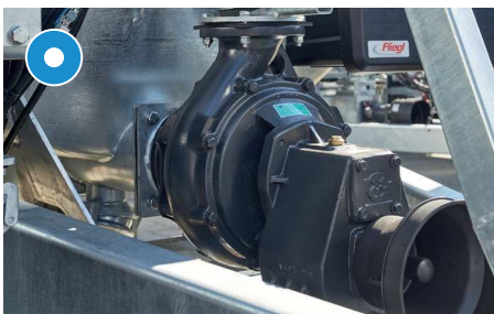
Centrifugálszivattyú az áttöltéshez
