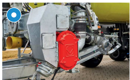
Rendkívül könnyen karbantartható: mechanikus meghajtású forgódugattyús szivattyú reduktorral
