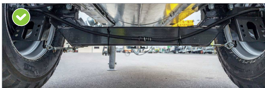
Hajlított tengely 5.000 és 8.600 liter között Alacsony súlypont az emelkedőn/lejtőn való jobb menettulajdonságért
