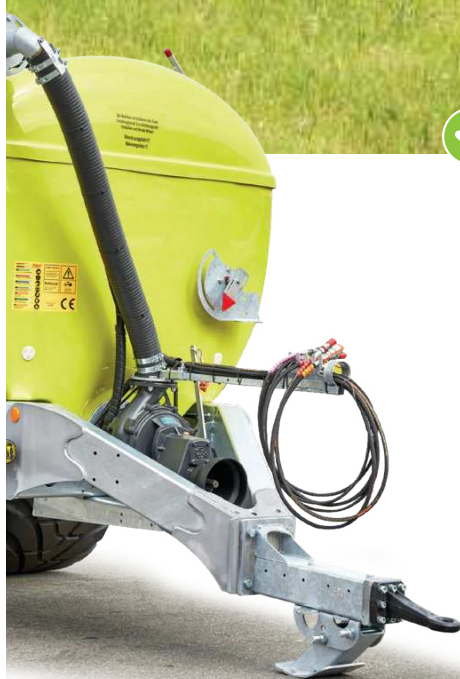
Elba centrifugálszivattyú a Battionitól 3.500 vagy 6.500 liter/perc
