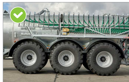
Egyedi kerékkivágás a hidraulikus rugózással kapcsolatban
