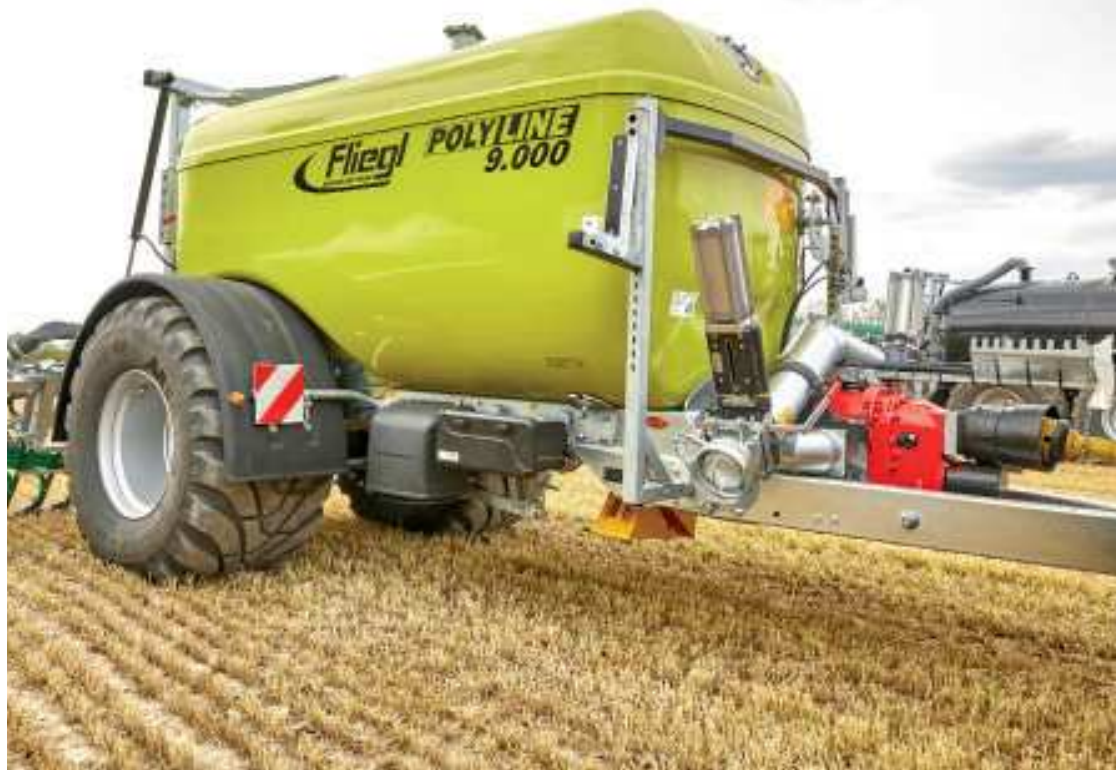
Egytengelyes Poly Line 9000 Forgódugattyús szivattyúAL
