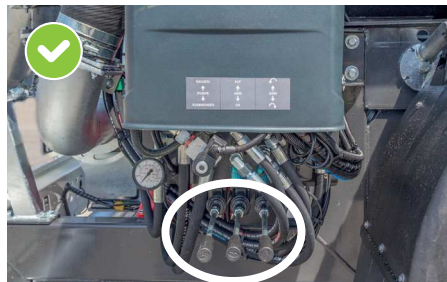
Vezérlés külső működtetéssel (csak forgódugattyús szivattyúval együtt)
