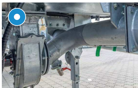
Hidraulikus turbótöltő a tartály alatt középen
