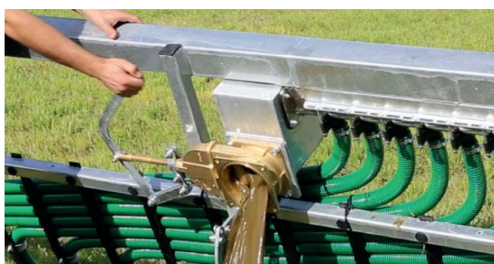
Kő- és idegentestgyűjtő mechanikus vagy hidraulikus úrtéssel
