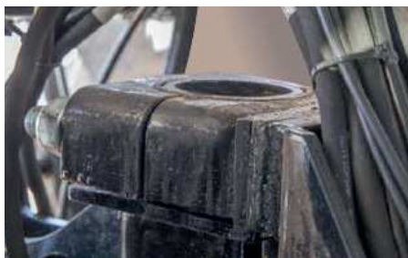
A tengelyre központilag szerelt hidraulikus kormányzás a kutyamenetben történő munkavégzéshez
