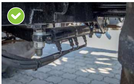
A tengelyre központilag szerelt hidraulikus kormányzás a kutyamenetben történő munkavégzéshez
