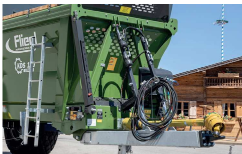
Hidraulikus rugózású vonórúd mélyágyas kivitel - alsókapcsolás. A kapcsolási magasság könnyen állítható.
