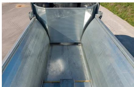
Kisebb kopás a hidraulikus letolórendszernek köszönhetően - nem láncos lehordó
