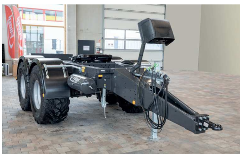
Tandem Dolly 17 tonna nyeregterheléssel és 20 tonna össztömeggel
