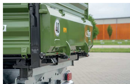
Erősített hátfal két munkahengeres kivitel
