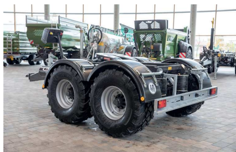
Tandem Dolly 17 tonna nyeregterheléssel és 20 tonna össztömeggel
