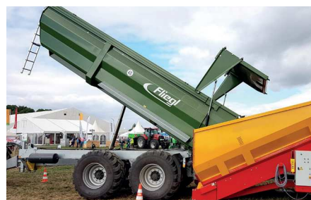
Hosszú kinyúlás a bunkerbe ürítéshez
