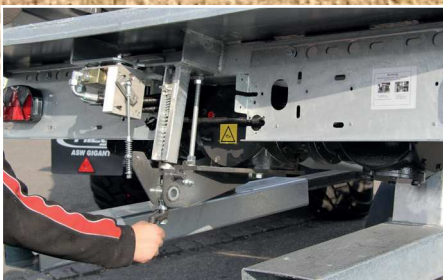
Az automatikus letolásszabályozással beállítható a letolási sebesség
