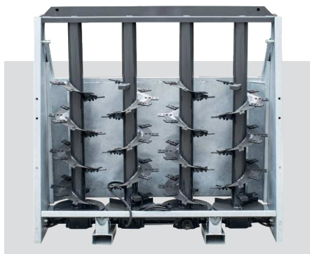
ADS 60 4 db száróhengerrel
