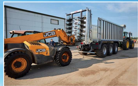
A szórószerkezet egy targoncával 20 per- cen belül egyszerűen felszerelhető
