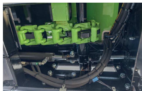
Hidraulikus láncfeszítés Opcionális tandem és tridem kivitelnél (MuckControl)
