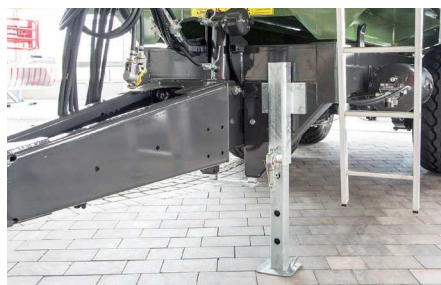
Hidraulikus rugózású vonórúd, mechanikus támasztólábbal TMK 256-tól
