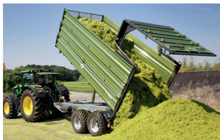
Silószállításhoz billentő pótkocsi hidraulikus hátfallal
