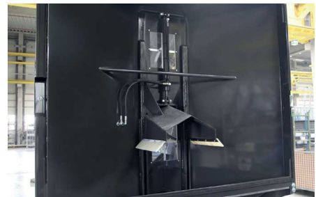
A hidraulikus zsilip segítségével bármikor teljesen üríthető az átrakócsiga
