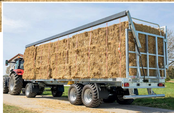
DPW 210 Ultra zárt állapotú rakományrögzítővel, nyitás jobb és bal oldalra is lehetséges
