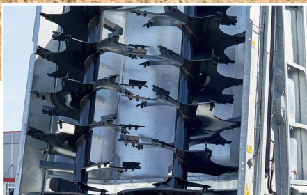
A maróhengerek felaprítják a szórandó anyagot, így homogénebb szórásképet hoznak létre.
