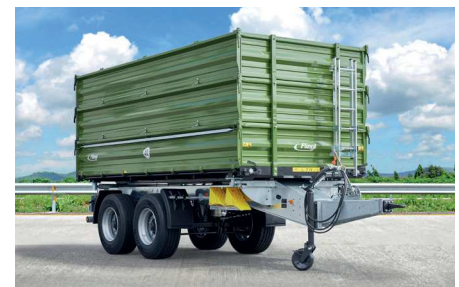
TDK 160 1800 mm nagyságú felépítménnyel (3 x 600 mm oldalfallal)
