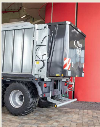
Hidraulikusan felhajtható aláfutásgátló: A hátsó ajtó nyitásakor az aláfutásgátló automatikusan felcsukódik.
