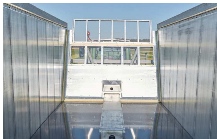
Tömítőlécek: A speciális 45°-os szögben elhelyezkedő poliuretán lécek tökéletesen képesek a rakfelületet tömíteni.
