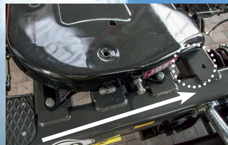
Mechanikus nyeregszerkezet-eltolás egytengelyes és tandem Dollynál
