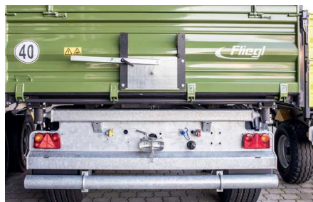
40 km/h kivitel aláfutásgátlóval és sárvédővel
