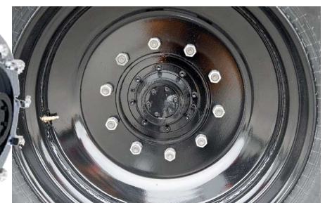
Radiáldugattyús hidromotor biztosítja a további hatásteljesítményt
