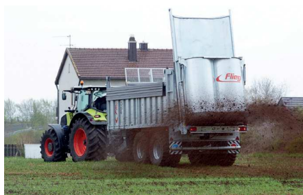
»Profí V2« szórószervezet zárt, szélesszóró hátfallal
