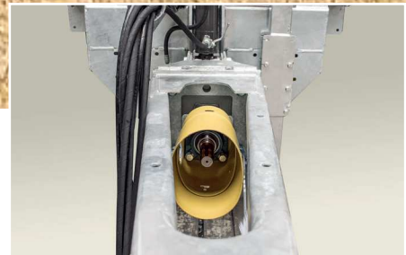
Kardánhajtás az adapterek meghajtásához
