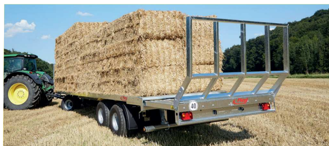
Bálafogó keret - DPW 180B-nél szériafelszereltség Opcionális: kihúzható toldat (1200 mm)
