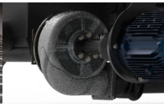
Ausspülen von Sedimenten mittels Kreiselpumpe
