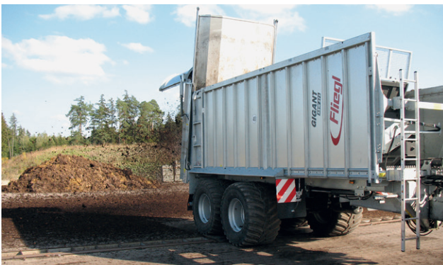
Bild 2: FLIEGL ASW 271 auf Prüfstand Querverteilung
