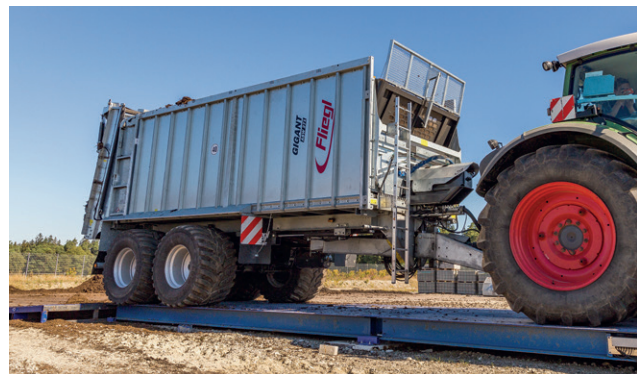
Bild 3: FLIEGL ASW 271 auf Prüfstand Längsverteilung
