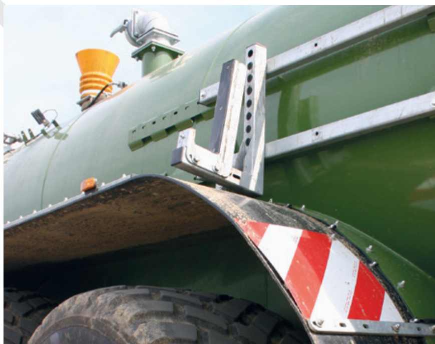
Bild 13: Fanghaken am Schleppschuhgestänge FLIEGL SKATE 150 zur Verriegelung des Gestänges während der Straßenfahrt
