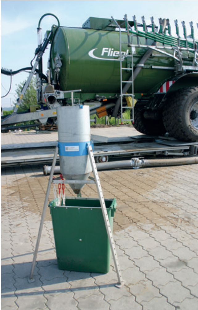
Bild 8: Fluidmeter zur Bestimmung der Fließfähigkeit von Flüssigmist
