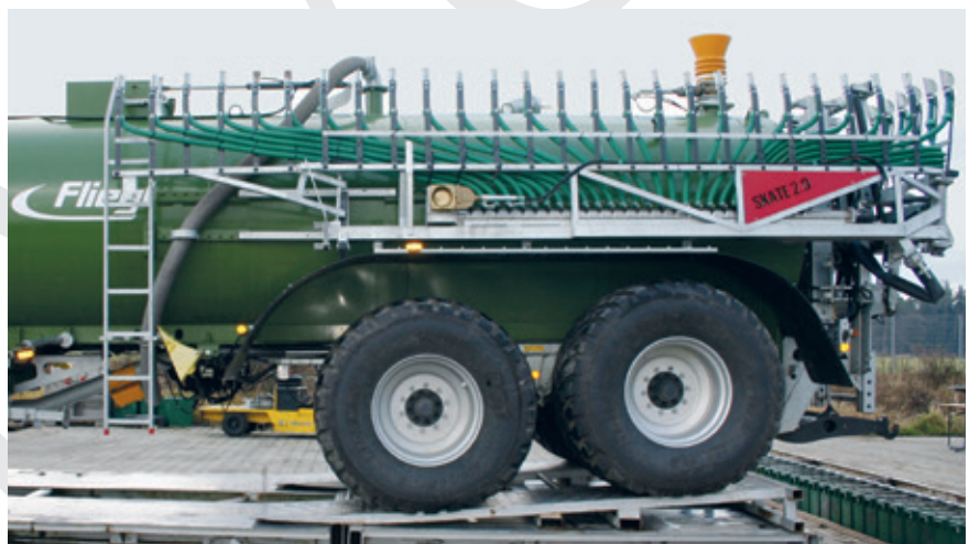
Bild 14: FLIEGL Schneckenverteiler am Schleppschuhgestänge FLIEGL SKATE 150 mit hydraulisch zu öffnendem Messingschieber zur Entleerung des Staukastens
