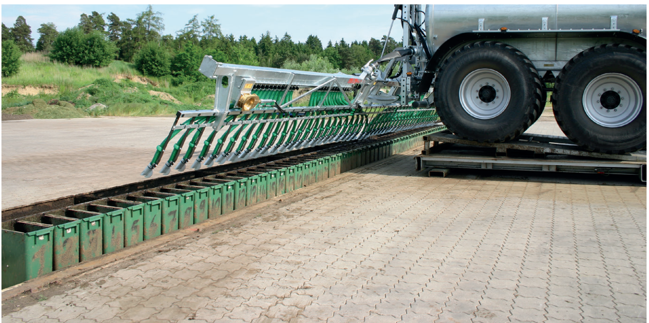
Bild 7: Prüfstand zur Ermittlung der Querverteilung
