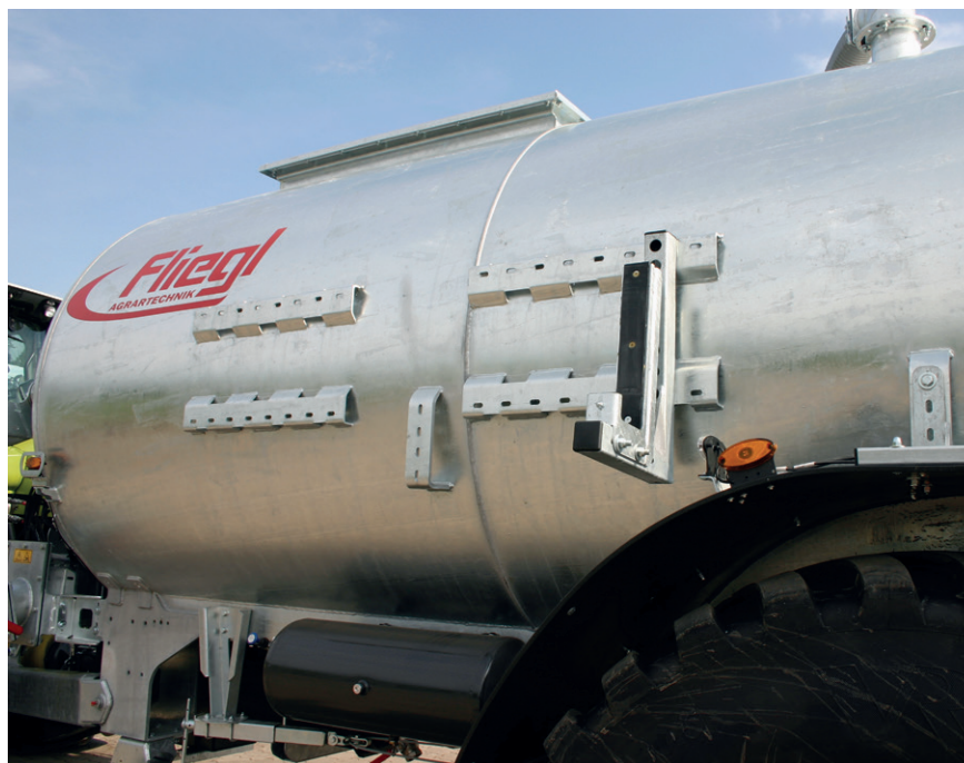
Bild 13: Fanghaken am Schleppschuhgestänge FLIEGL SKATE 120 zur Verriegelung des Gestänges während der Straßenfahrt
