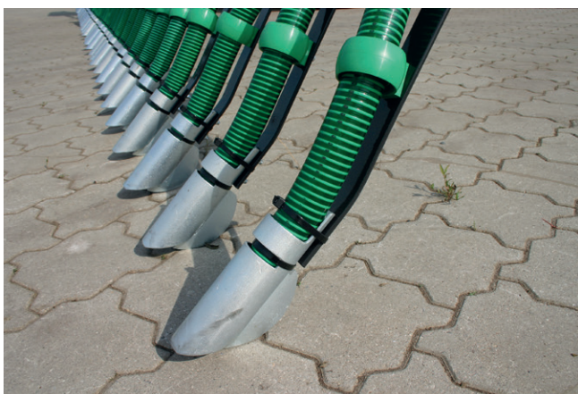
Bild 4: Auslass am Schleppschuhverteiler FLIEGL SKATE
