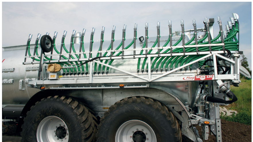
Bild 14: FLIEGL Schneckenverteiler am Schleppschuhgestänge FLIEGL SKATE 120 mit hydraulisch zu öffnendem Messingschieber zur Entleerung des Staukastens
