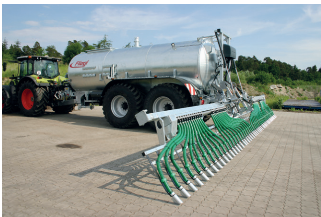
Bild 2: Schleppschuhgestänge in Arbeitsstellung
