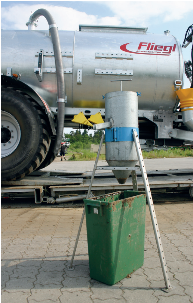
Bild 8: Fluidmeter zur Bestimmung der Fließfähigkeit von Flüssigmist
