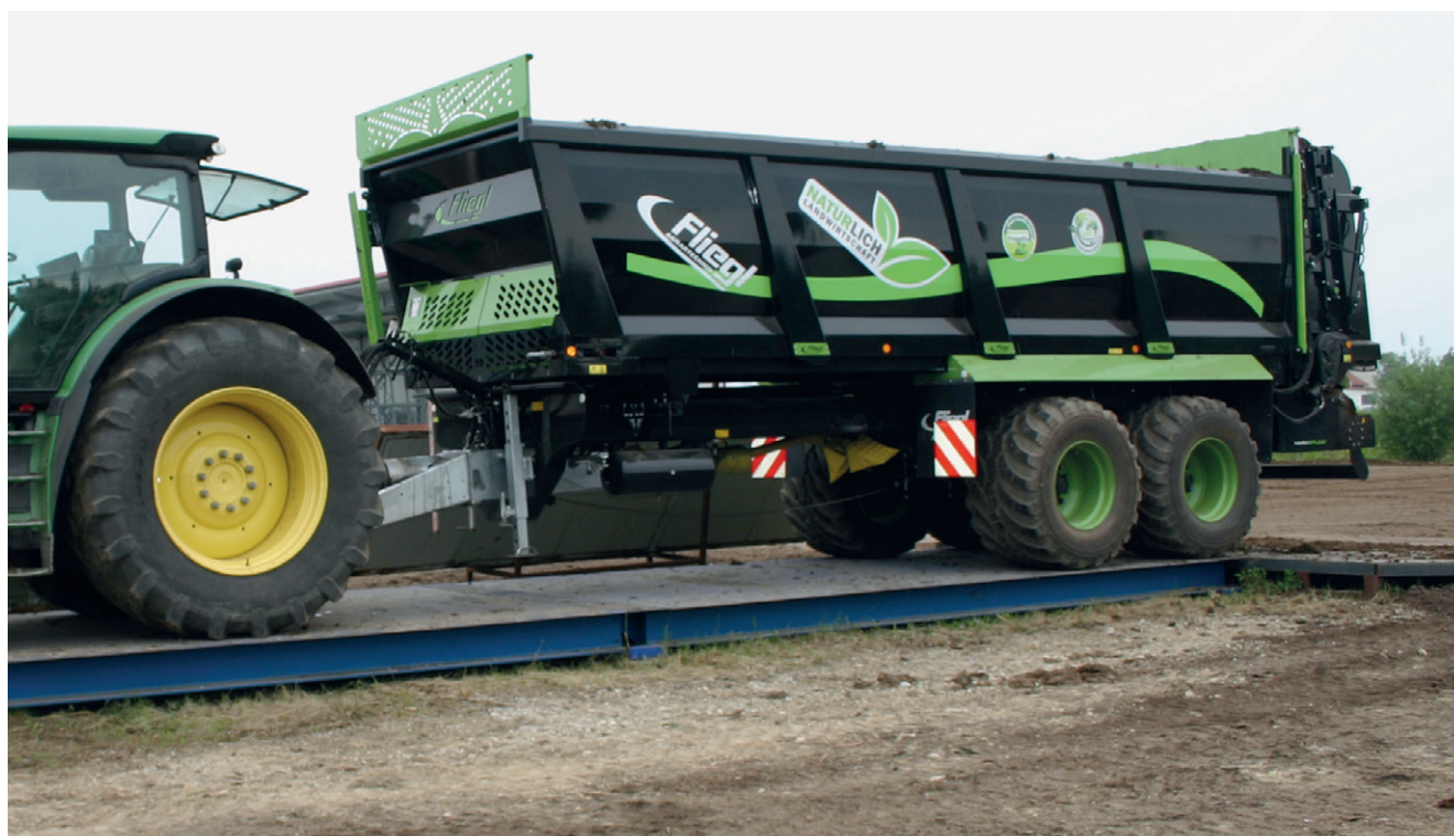
Bild 3: Fliegl KDS 270 muck control auf dem Prüfstand zur Ermittlung der Längsverteilung
