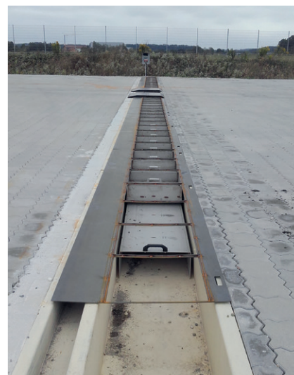
Bild 2: Prüfstand zur Ermittlung der Querverteilung
