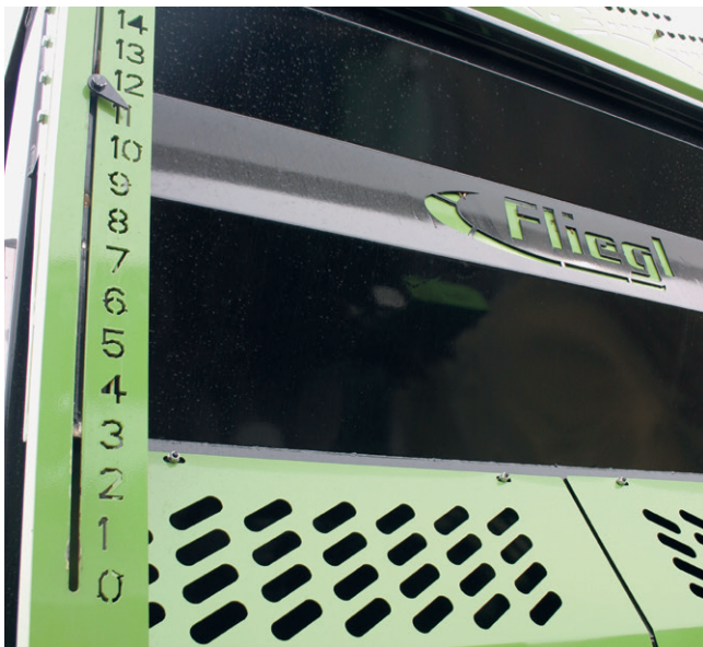
Bild 5: Anzeige an der Vorderwand des Streuers für die Öffnungsweite zwischen Laderaum und Streuwerk
