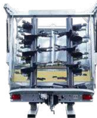
Wały tnąco-rozdrabniające z łopatami wyrzutowymi
