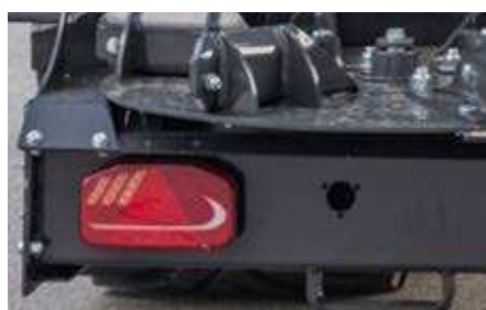
Tyłne oświetlenie LED „Dynamic” z dyna- micznym kierunkowskazem
