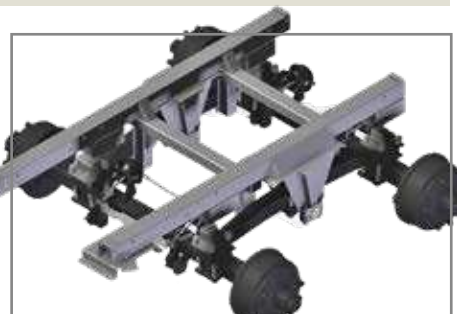
Zawieszenie paraboliczne TITAN, dla najlepszego „kopiowania” terenu
