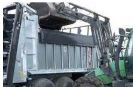
Burta boczna, regulowana; wyposażenie opcjonalne
