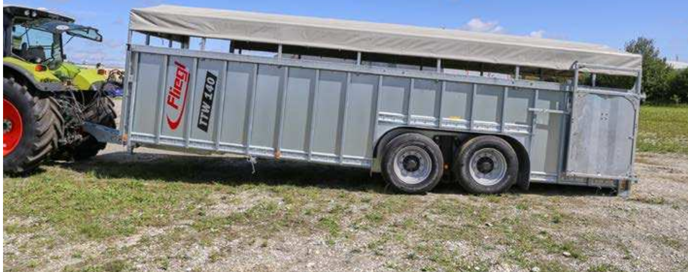
TTW 140 Tandem Noah: długość platformy 8300 mm, perfekcyjna do transportu większej liczby zwierząt
