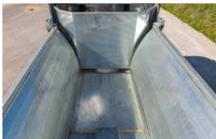
Minimalne zużycie dzięki hydraulicznemu systemowi zsuwania – bez podajnika łańcuchowego
