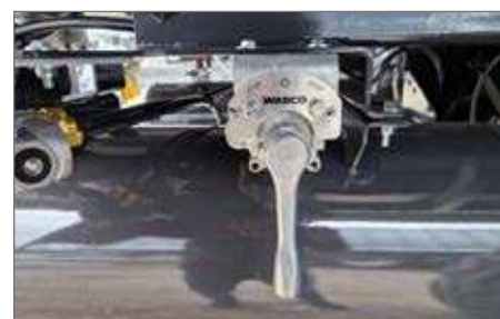
Zawór podnoszenia i opuszczania w zawieszeniu pneumatycznym
