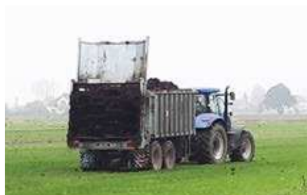
Rozrzutnik „Profi V2n” dla ASW z burtami o wysokości 1500 mm
