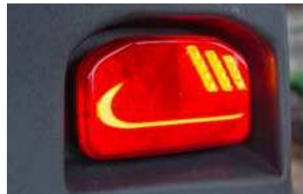
Tylna lampa LED „Dynamic” z dynamicznym światłem skrętu, wykonana z materiału odpornego na uszkodzenia
