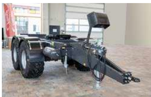
Wózek siodłowy Dolly w wersji Tandem z obciążeniem sprzęgu siodłowego 17 t i masą całkowitą 20 t
