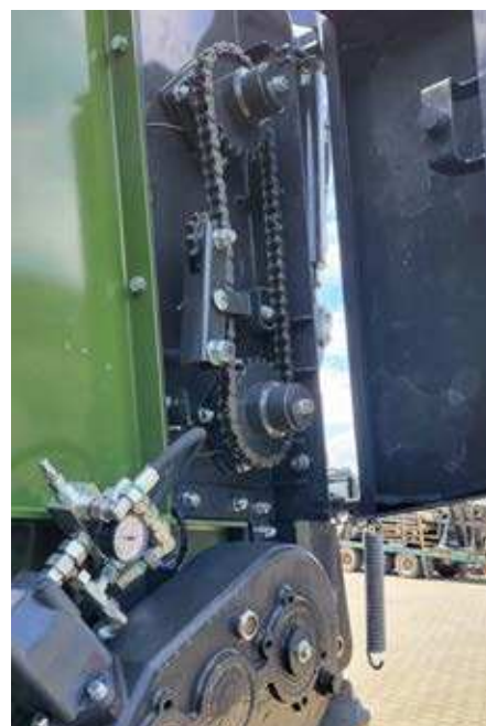
Połączenie wałów frezujących za pomocą łańcucha (KDS 255)
