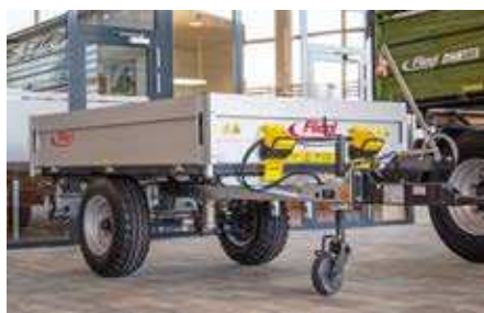
Super lekka przyczepa EDK 25 z aluminiowymi burtami i nadstawą do liści
