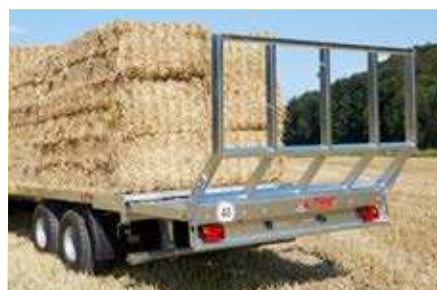
Przednia i tylna kratownica do bel, wyposażeniem seryjnym DPW 180 B Opcjonalnie: manualnie wysuwane przedłużenie platformy (1200mm)
