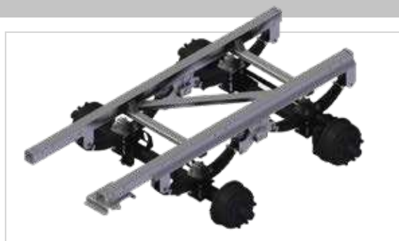
Tandemmaggregat Gigant – Parabelfederung
