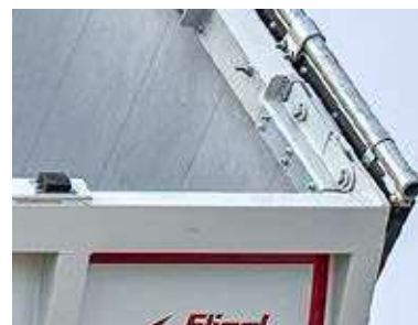
Podwójny zawias przegubowy i podwójne blokowanie haków
