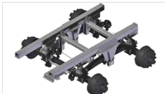
Titan-Tandemmaggregat für besten Bodenausgleich, schmierlos und wartungsfrei.
