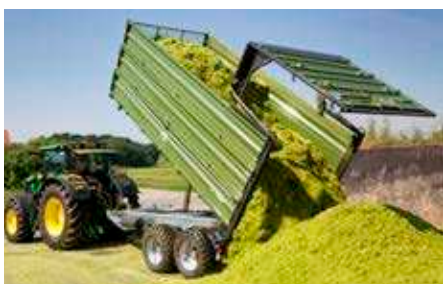
Jako przyczepa objętościowa z tylną klapą otwieraną hydraulicznie
