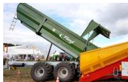
Wydłużony tył skrzyni skorupowej TMK Potato dla komfortowego wyładunku i napełniania zasobnika
