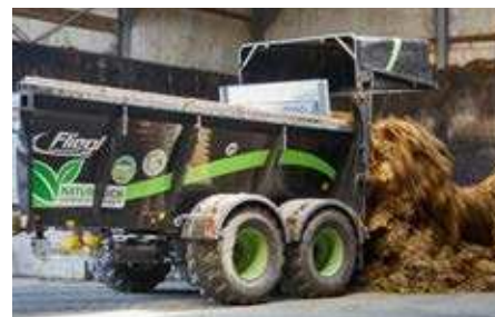
ADS opcjonalnie można wyposażyć w klapę objętościową 800mm, dzięki czemu możemy maszynę wykorzystywać w transporcie materiałów rolniczych
