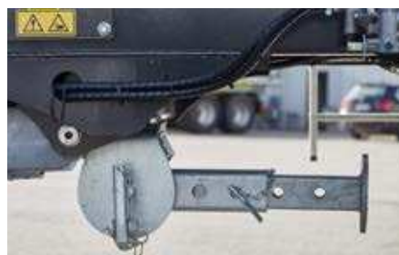
Noga podporowa regulowana centralnie, składana do tyłu dla maksymalnego bezpieczeństwa
