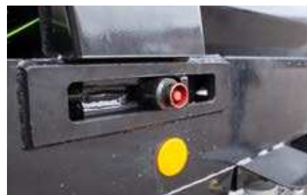
Łatwy dostęp do punktów konserwacyjnych przenośnika łańcuchowego
