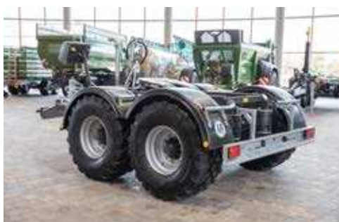
Wózek siodłowy Dolly w wersji Tandem z obciążeniem sprzęgu siodłowego 17 t i masą całkowitą 20 t
