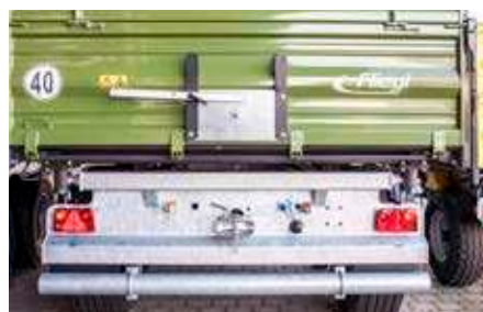
Wersja 40 km/h z tylnym zderzakiem i błotnikami
