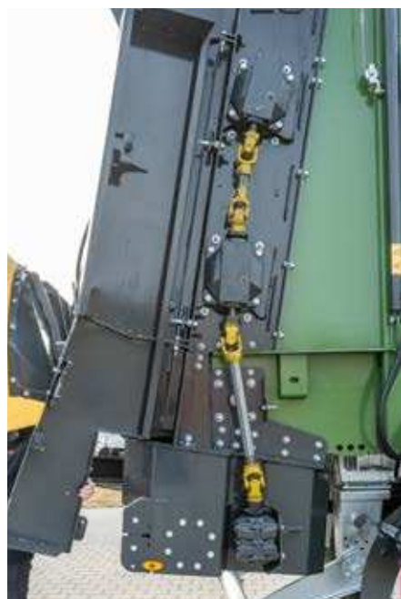
Napęd wałów frezujących przez wał prze- gubowy
