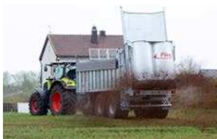
Rozrzutnik „Profi V2” z zamkniętą tylną klapą, do rozrzutu szerokiego
