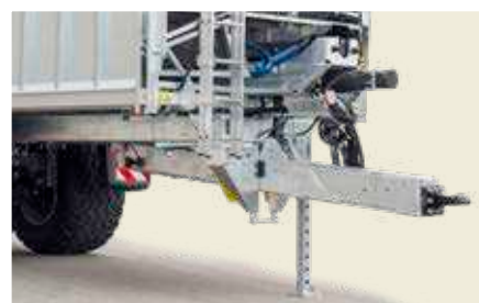
Jednolity, hydr. amortyzowany dolny zaczep przyczepy do zaczepu dolnego
