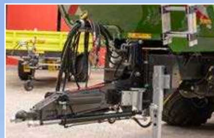
Układ holowniczy z zawieszeniem hydraulicznym
