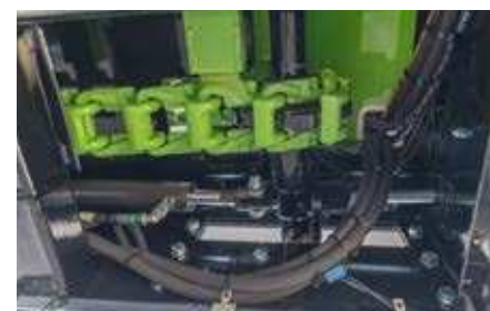
Hydrauliczne napinanie przenośnika łańcuchowego - opcjonalnie dla MuckControl
