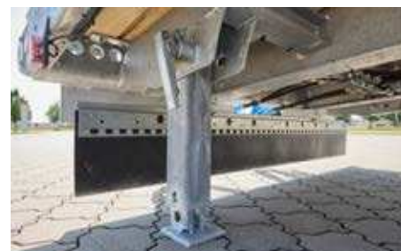
Tyłne podparcie z 2 podporami uchylnymi
