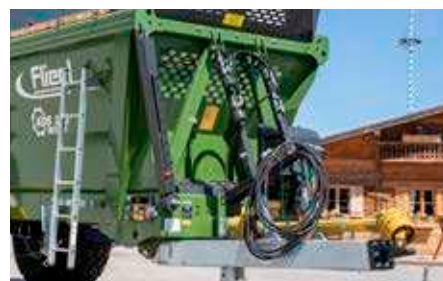
Dyszel amortyzowany hydraulicznie. Możliwość regulacji wysokości sprzęgu
