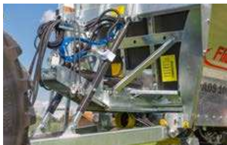
Dyszel amortyzowany hydraulicznie
