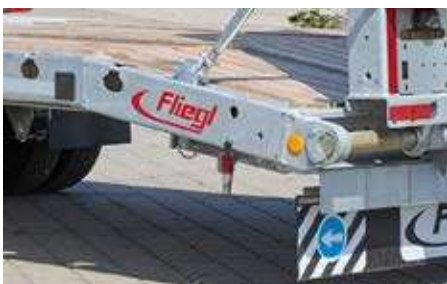
Tył mostu ścięty do ok. 900 mm
