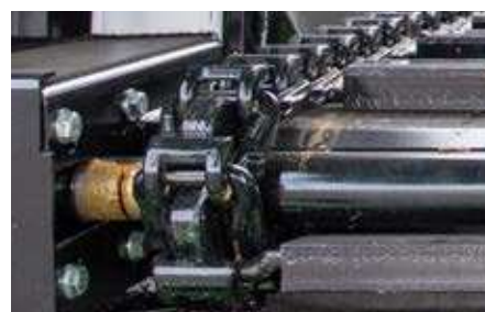
Koła łańcuchowe o kształcie gwiazdy
