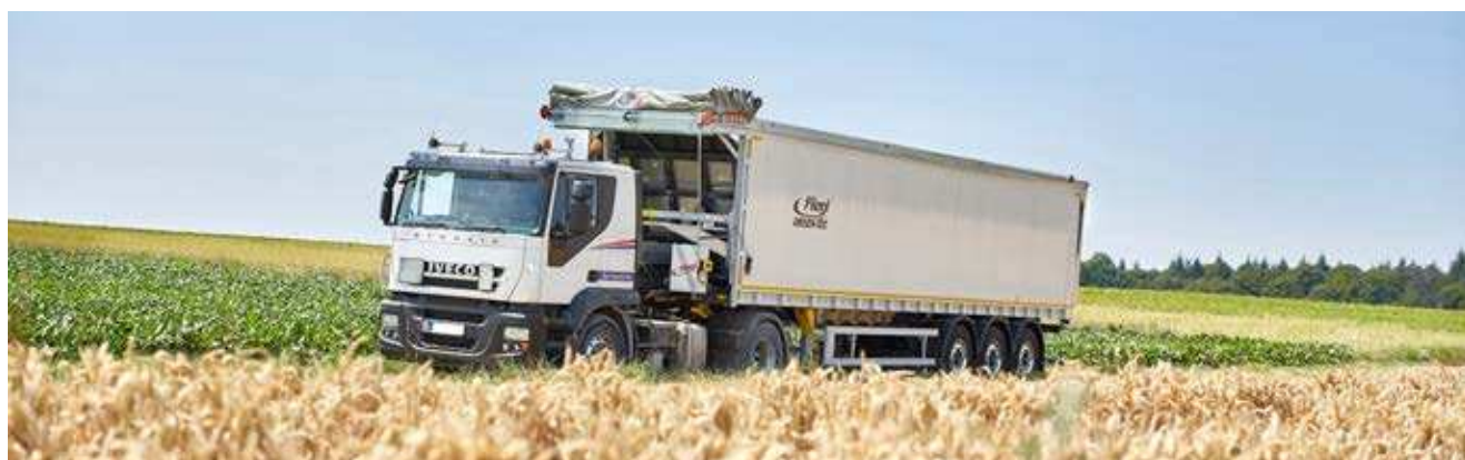
ASS 388 w wersji aluminiowej z plandeką przesuwną
