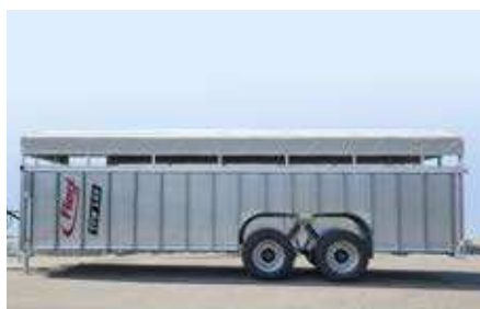
TTW 140 Tandem Noah: długość platformy 8300 mm, perfekcyjna do transportu większej liczby zwierząt
