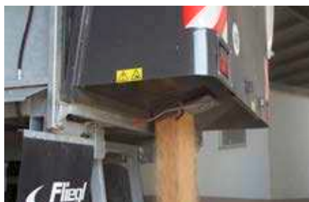
Hydrauliczna kłapa objętościowa z zsytem zbożowym - wyposażenie seryjne
