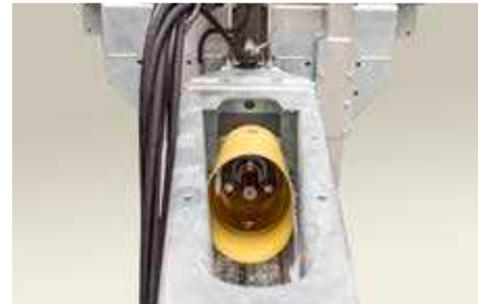
Adapter napędzany mechanicznie, przez wał napędowy
