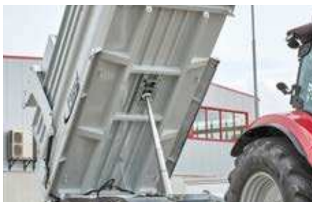
Wzmocniona rama platformy zapewniająca ekstremalną sztywność skrętną
