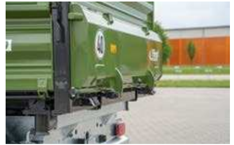
Mocna klapa w wersji z 2-ma siłownikami
