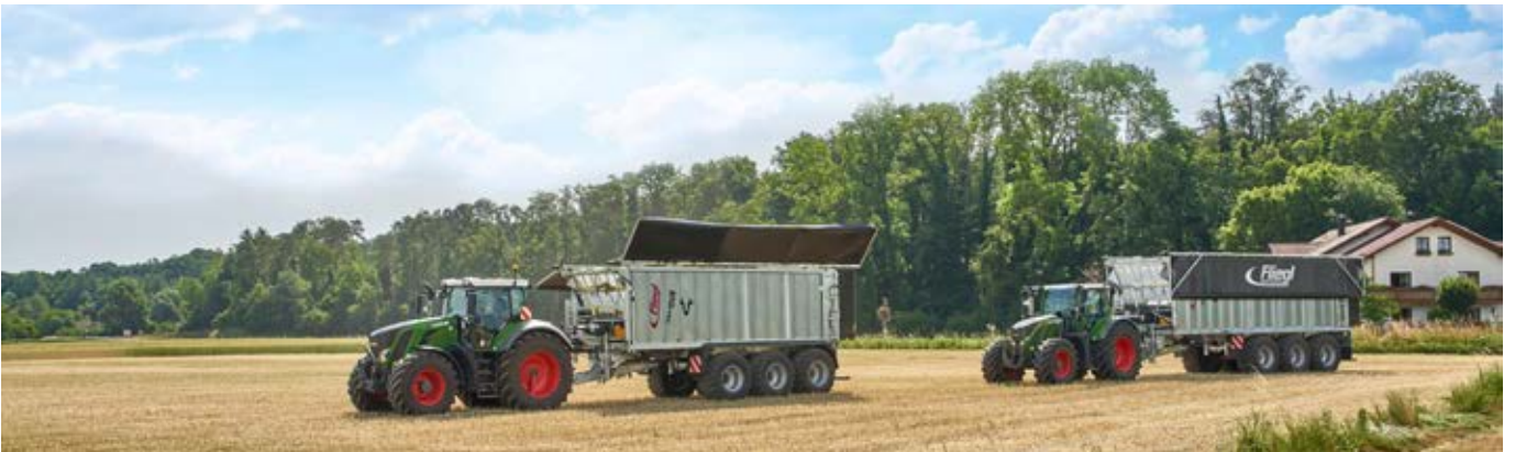
TOPLIFT: In korte tijd kunnen beide dekzeil- helften geopend en gesloten worden
