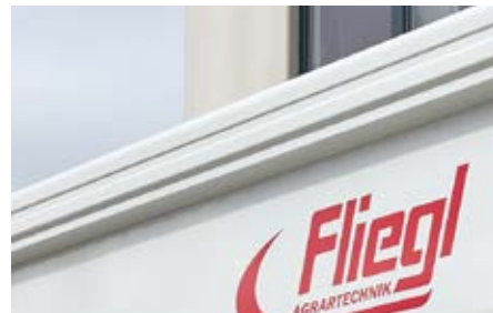
Versterkingsprofielen uit één stuk gezet en afgerond
