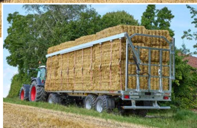
DPW 210 Ultra met ladingzekering gesloten, opening naar keuze rechts of links mogelijk.
