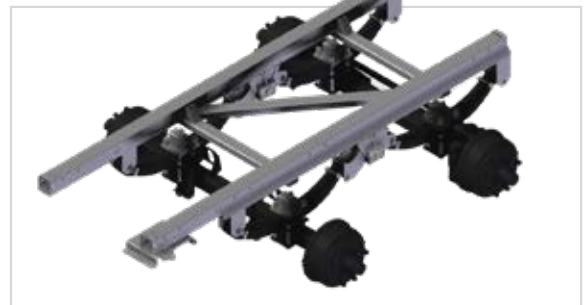
Gigant – Tandemasser met parabolische vering
