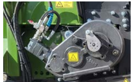
Krabberbodemaandrijving Tandwielkast en hydraulische motor aan de linkerkant in rijrichting.
