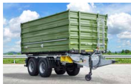
TDK 160 mit Aufbau 1800 mm ( 3 x 600 mm Bordwand)
