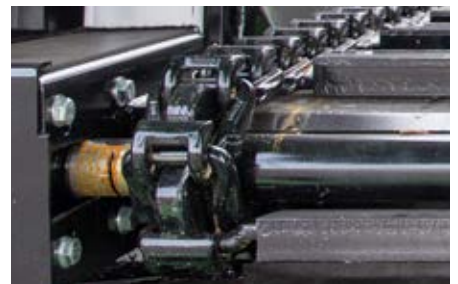
Stervormige kettingwielen met geringe gevoeligheid voor vervuiling.
