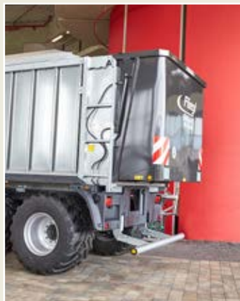
Bij het openen van de grootvolume achterwand klapt de onderrijbescherming automatisch op
