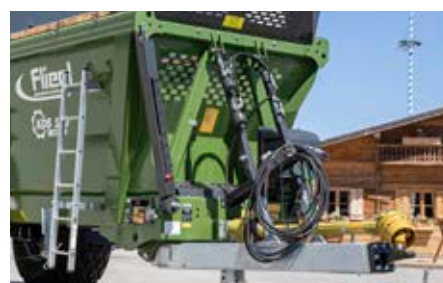
Hydraulisch geveerde dissel voor diepbedstrooier/onderbevestiging. De koppelhoogte kan comfortabel worden ingesteld.
