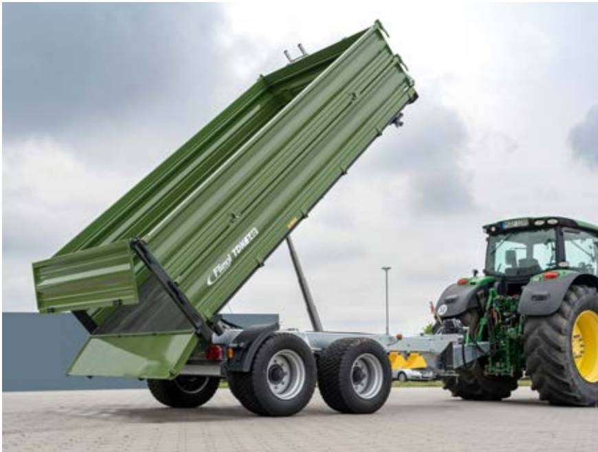
Grondverzet uitvoering met hydraulische achterklep 500 mm.
