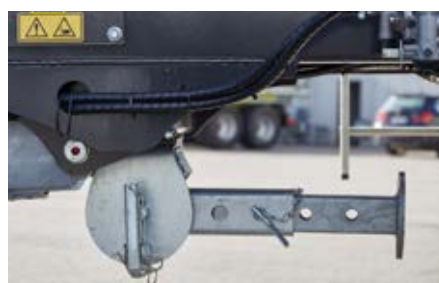
Valsteunpoot verstelbaar in het midden naar achteren klapbaar voor optimale stabiliteit
