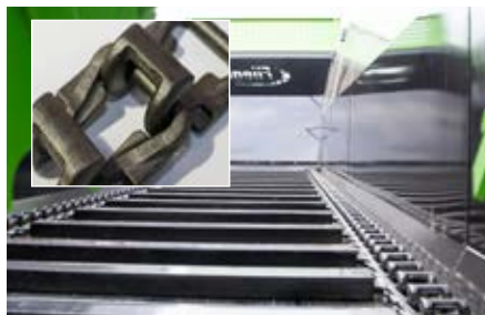
2 uitwendige kettingstrengen van V2-kettingschakels met een breeklast van 50 ton.
