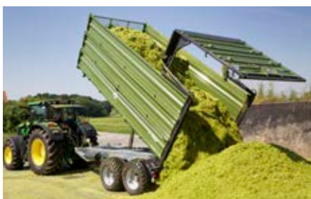
Kuilkiepwagen met hydraulische achterwand
