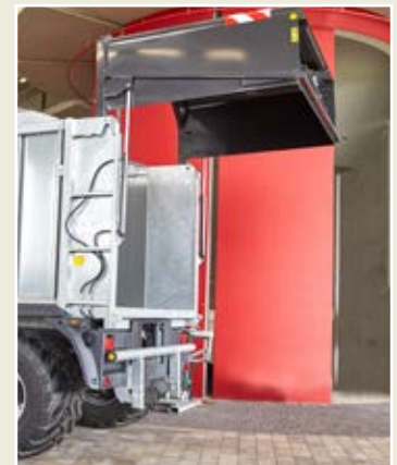
Bij het openen van de grootvolume achterwand klapt de onderrijbescherming automatisch op
