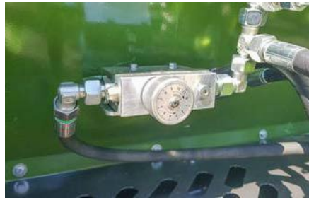
Mechanische potentiometer met instelbare voortschuifsneldheid voor aan de strooibak
