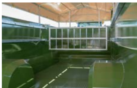
Ribbelplaat zorgt ervoor dat dieren stabiel staan
