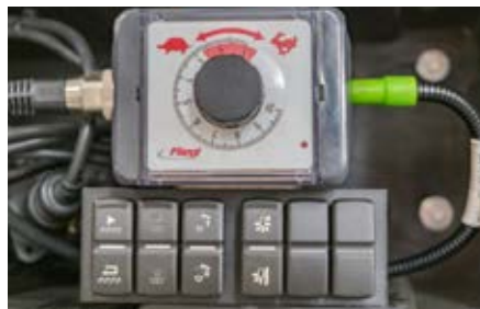
Besturingsblok met elektrisch potentiometer en bedieningspaneel Bediening van de hydraulische functies: Krabberbodem aandrijving, doseerschuij en achterwand. Traploze snelheidsregeling van de transportbodem via draaiknop in de trekker- cabine.
