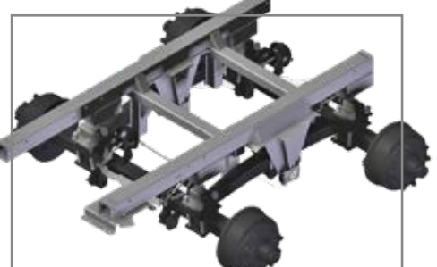
Met Titan onderstel in tandemmassige uitvoering voor optimale compensatie van bodemoneffenheden.
