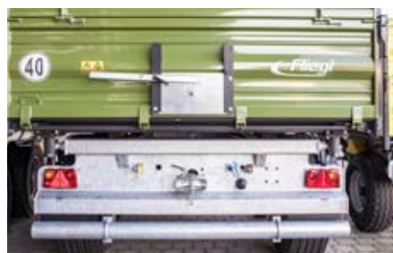
40 km/h uitvoering met onderrijbescherming en spatborden
