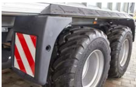
Spatborden, wielafdekkingen en achterplaat uit speciaal gebouwde kunststofonderdelen zorgen voor een zuivere afwerking en gering kwetsrisico voor mens en machine.
