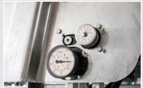
Mechanische potentiometer met instelbare voortschuifsnelheid op de strooier
