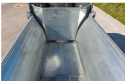
Geringste slijtage door het hydr. schuifstelsel – geen schraapbodem.
