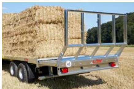
Balenrooster standaard bij type DPW 180 B Optie: Uitschuifbaar achterstuk (1200 mm)
