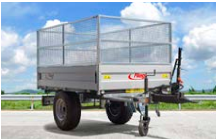
Superlicht : de EDK 25 met aluminium zijwanden en loofopbouw
