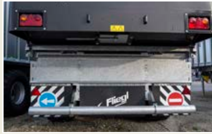
40 km/h-uitvoering Duitsland met onderrijbescherming star
