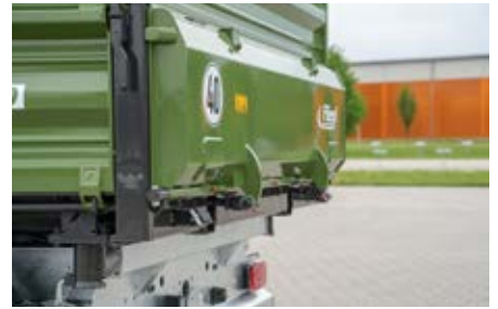
Robuste klep in 2-cilinder uitvoering
