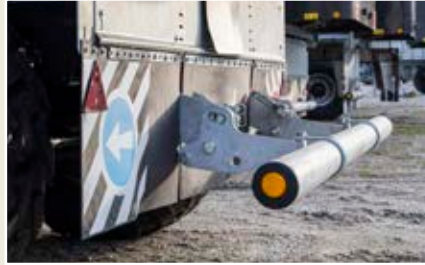
Onderrijbescherming mechanisch opklapbaar
