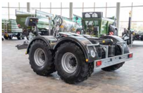
Dolly in tandemasuitvoering met 17 t opleggerlast en 20 t totaalgewicht
