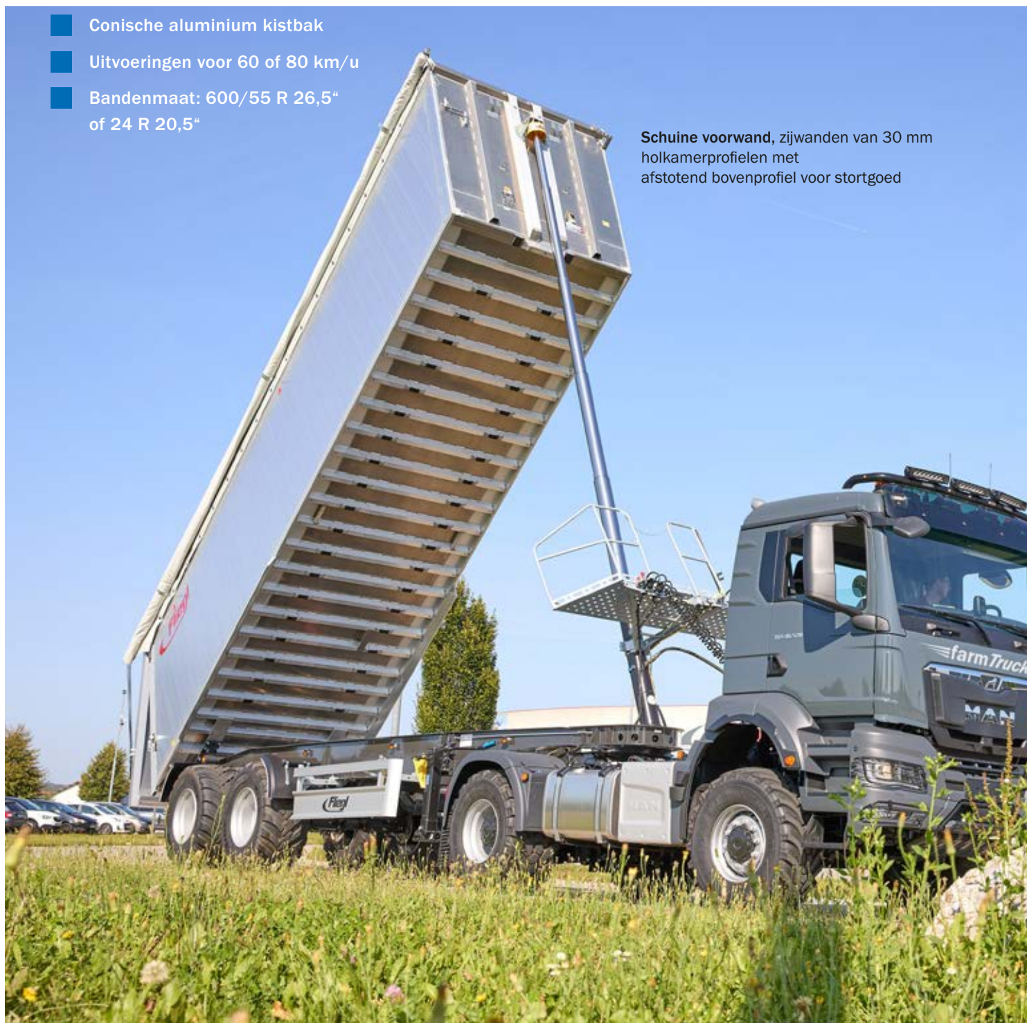
Dubbel scharnier en dubbele haakvergrendeling
