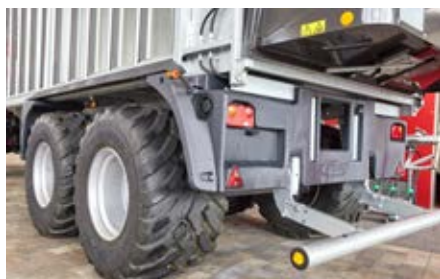
Spatborden, wielafdekkingen en achterplaat uit speciaal gebouwde kunststofonderdelen zorgen voor een zuivere afwerking en gering kwetsrisico voor mens en machine.
