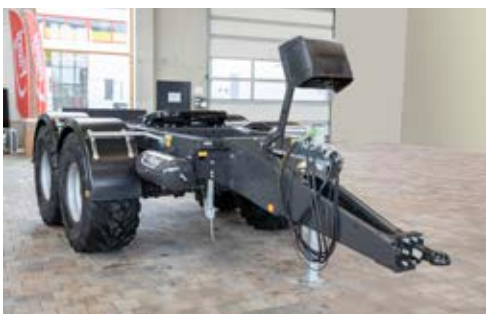
Dolly in tandemasuitvoering met 17 t opleggerlast en 20 t totaalgewicht
