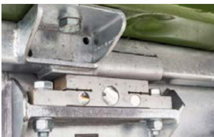
Weeginrichting Nauwkeurige bepaling van de belading. In combinatie met de Isobus-besturing Spreader Control kan de regeling van de krabberbodem automatisch worden aan- gepast aan de gewichtsverandering.
