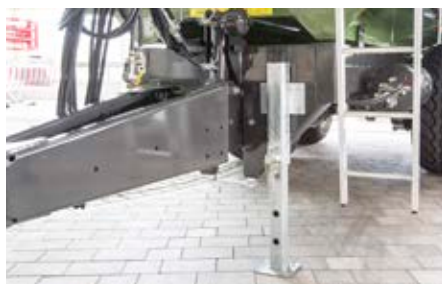
Vanaf TMK 256 standaard: Hydraulische dissilvering en valsteunpoot, mechanisch Vanaf TMK 256
