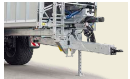
Hydr. geveerde trekrichting over de hele lengte voor onderbevestiging
