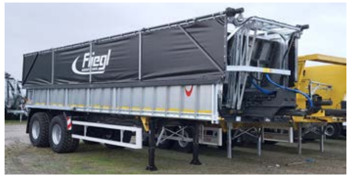
TOPLIFT: In korte tijd kunnen beide dekzeil- helften geopend en gesloten worden
