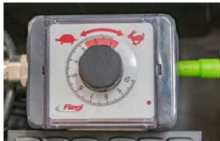
Elektrische potentiometer met instelbare voortschuifsneldheid aan het bedieningspaneel
