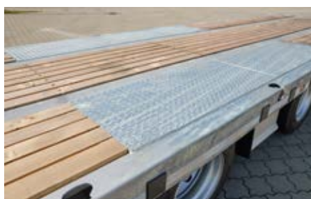
Oprijrampen en brugvloer van zachthout
