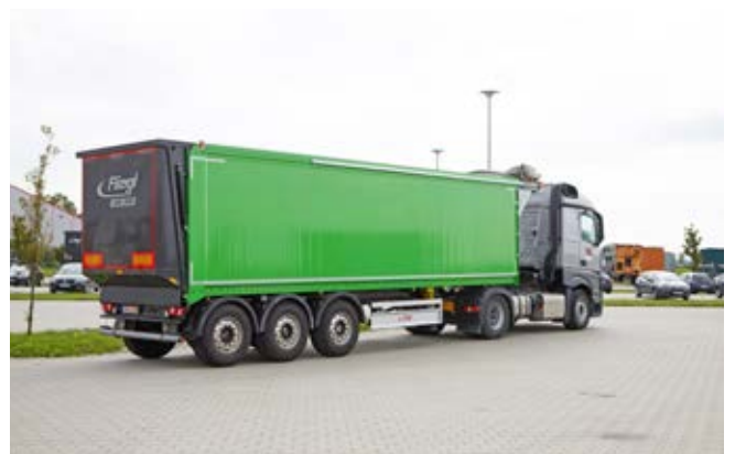
ASS 398 GREEN-TEC met zijwanden van aluminium
