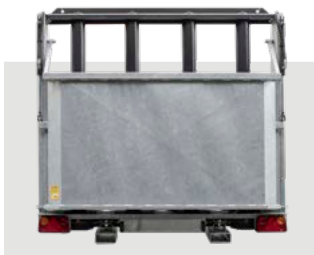
Optie: Strooiwalsbescherming en guillotinedeur bij de ADS 60
