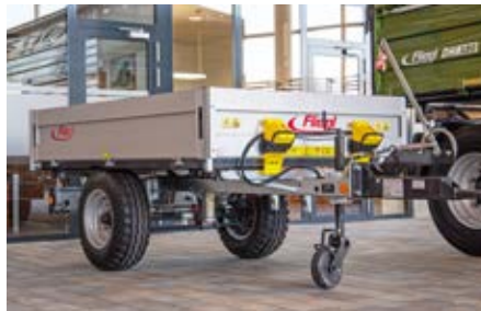
Superlicht : de EDK 25 met aluminium zijwanden en loofopbouw
