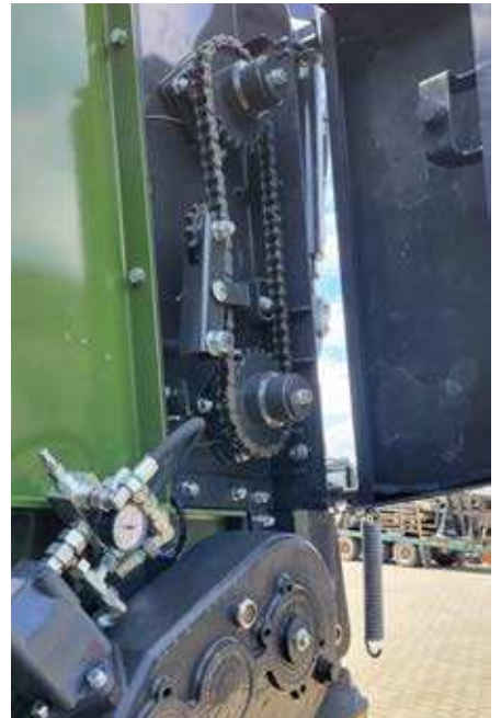
Fräswalzenverbindung über Kette (KDS 255)
