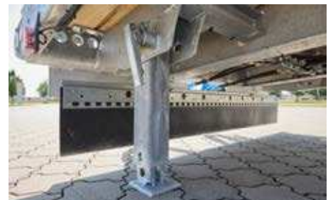
Heckabstützung mit 2 Fallstützen
