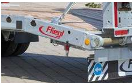
Brücke hinten auf ca. 900 mm abgeschrägt
