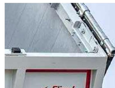
Charnière à double articulation et verrouillage à 2 crochets
