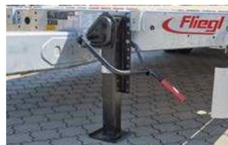
Pied d'appui mécanique
