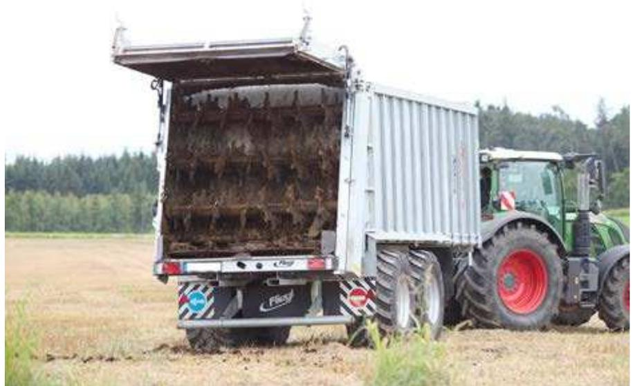
Le dispositif d'épandage « Muck Control » est équipé de trois rouleaux fraiseurs disposés horizontalement (Ø 560 mm) pour une décomposition optimale de l'engrais organique. La répartition s'effectue au moyen de deux disques d'épandage (Ø 1100 mm), chacun doté de six pales de projection – pour une image d'épandage régulière et une efficacité maximale en utilisation.
