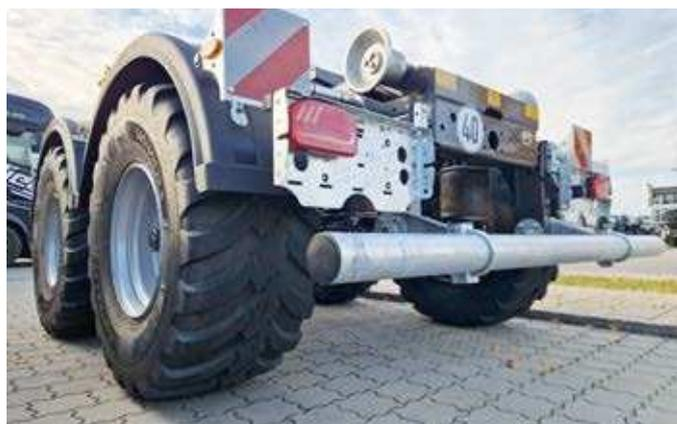
Arrière préparé pour crochet d'attelage, conduites hydrauliques et raccords d'air comprimé.
