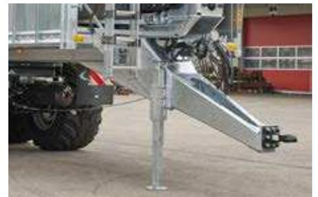
Zugholm ungefedert, drehbar für Oben- und Untenanhängung
