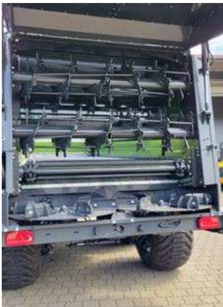
**2 rouleaux de fraisage avec dents rotatives** en acier résistant à l'usure assurent une décomposition optimale des matériaux. Des barres soudées servent de protection contre l'enroulement et facilitent le nettoyage des rouleaux de fraisage. Les rouleaux de fraisage sont entraînés par cardan et protégés contre les surcharges.
