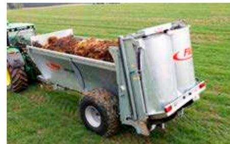
La technologie de poussée éprouvée de Fliegl assure l'alimentation en matériau régulière de l'épandeur. Après l'épandage, l'espace de stockage est bien vidé et le fond reste propre, à l'inverse de l'épandage avec un fond racleur traditionnel.
