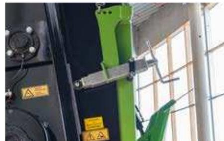
À l'aide des deux vis sans fin situées à gauche et à droite, l'inclinaison de la partie inférieure de la paroi arrière peut être réglée, permettant ainsi de déterminer le point de dépose optimal des matériaux sur les disques d'épandage.
