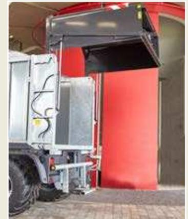
La protection anti-encastrement se rabat automatiquement vers le haut lors de l'ouverture de la large paroi arrière
