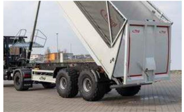
4 serrures pour le transport de fourrage et déchargement via un poussoir à grain.
