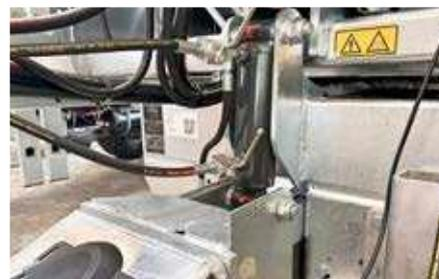
Zugholm hydraulisch gefedert, drehbar für Oben- und Untenanhängung
