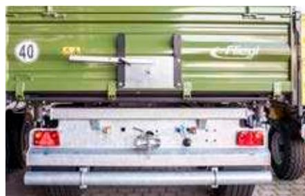
Version 40 km/h avec protection anti-encastrement et garde-boue
