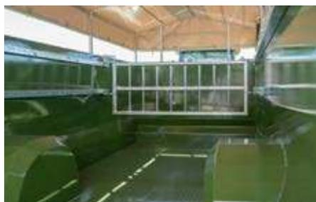
Grille de séparation réglable et fond en tôle gauffrée avec ouverture d'évacuation
