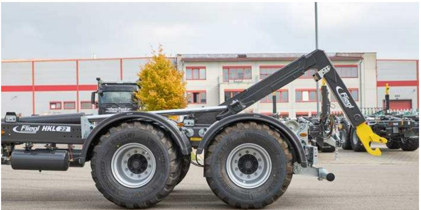
Grâce à la suspension pneumatique spéciale JUMBO, une faible hauteur d'appui peut être garantie.
