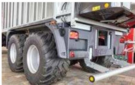
Gardes boues latéraux, ailes enveloppantes et tôle arrière en plastique à finitions spéciales assurant une propreté de la caisse, de la route et sécurisant l'Homme et la machine.
