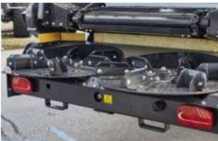
**2 disques d'épandage avec 6 palettes chacun** assurent une répartition uniforme des matériaux épandus. Les palettes sont équipées de plaques en carbure pour une résistance accrue.
