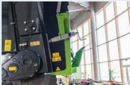
**L'épandeur à disque varioSPLASH** possède deux grands disques d'épandage de Ø 1100 mm, chacun doté de 6 panneaux d'éjection réglables transversalement par rapport à l'angle d'éjection. Ils sont équipés de plaques remplaçables en HB 400 et leur sensibilité peut être modifiée au moyen de chevilles de sécurité.
