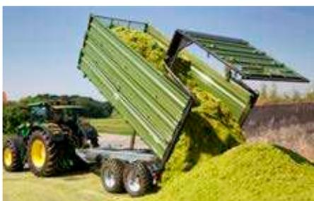
Benne d'ensilage avec paroi arrière hydraulique
