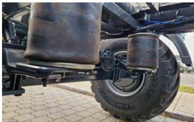
Un système de suspension pneumatique assure un confort de conduite optimal, avec abaissement automatique du basculement pour une stabilité maximale.
