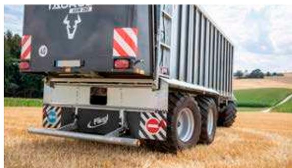
Pour sa direction forcée électronique, Fliegl mise sur une technologie de capteurs innovante qui ne nécessite aucune timonerie d'accouplement sur le véhicule tracteur.
