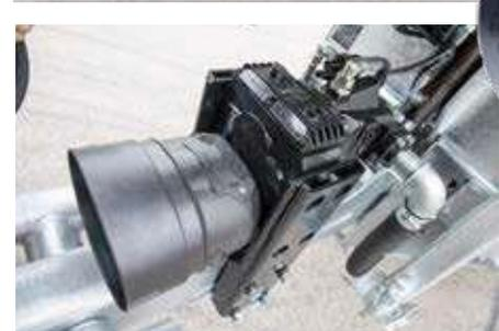
Centrale hydraulique pour une puissance max. indépendante du véhicule tracteur
