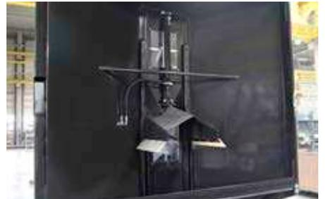
Le coulisseau de stockage hydraulique permet de vider entièrement la vis de transbordement à l'état chargé
