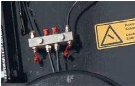
Point de lubrification centralisé
