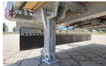
Heckabstützung mit 2 Fallstützen
