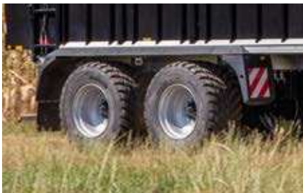
Bereifungsvarianten bis 800/45 R 22,5“ oder wahlweise 710/50 R 30,5“
