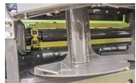
Der Transportboden besteht aus 2 Flachstufenketten mit durchgehenden Kratzbodenleisten
