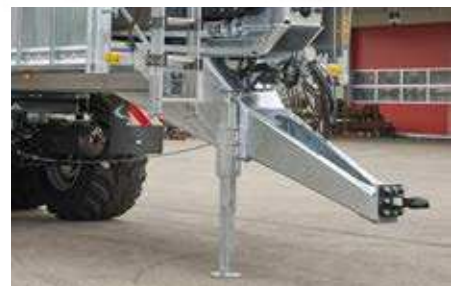
Zugholm ungefedert, drehbar für Oben- und Untenanhängung
