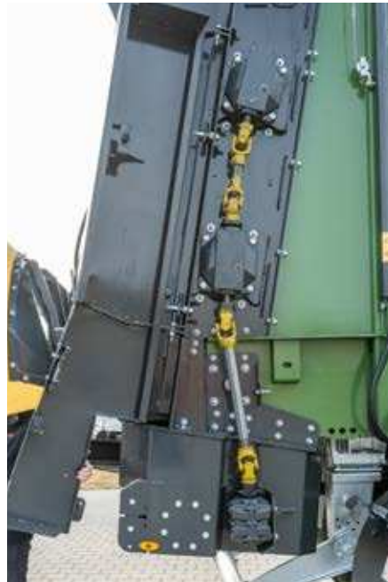
Fräswalzenantrieb über Gelenkwelle
