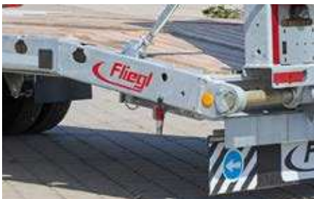
Brücke hinten auf ca. 900 mm abgeschrägt
