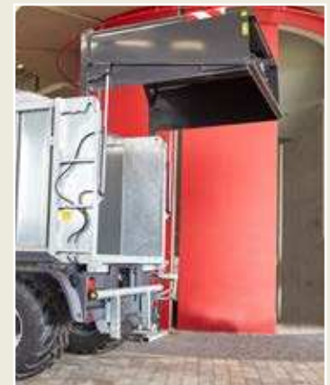
Unterfahrschutz hydr. klappbar: Beim Öffnen der Großraumrückwand klappt der Unterfahrschutz automatisch nach oben bzw. beim Schließen nach unten
