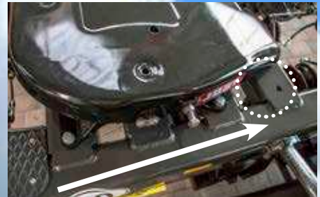
Mechanische Sattelplattenverstellung für Einachs- und Tandem-Dolly
