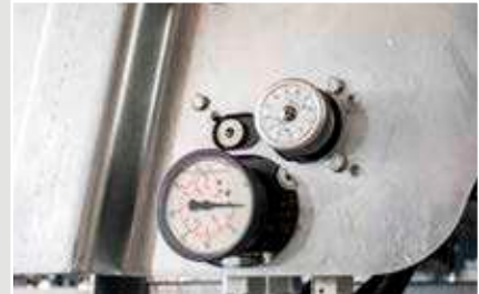
Mechanisches Potentiometer mit einstellbarer Vorschubgeschwindigkeit am Streuwerk
