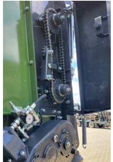
Fräswalzenverbindung über Kette (KDS 255)
