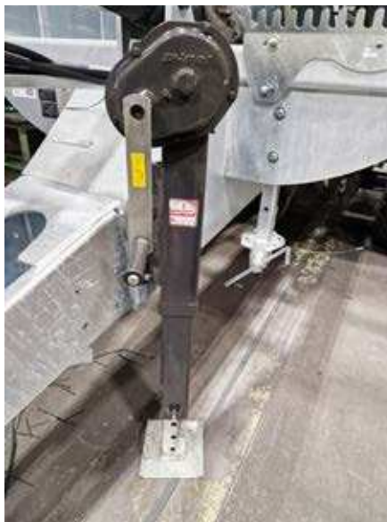
Stützfuß mit 2-Geschwindigkeiten
