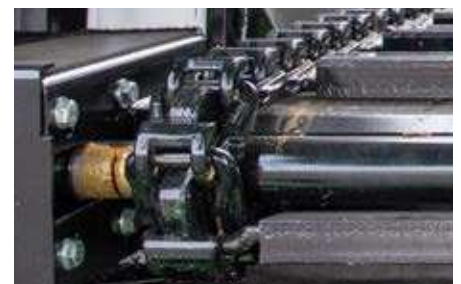
Sternförmige Kettenräder mit geringer Verschmutzungsanfälligkeit
