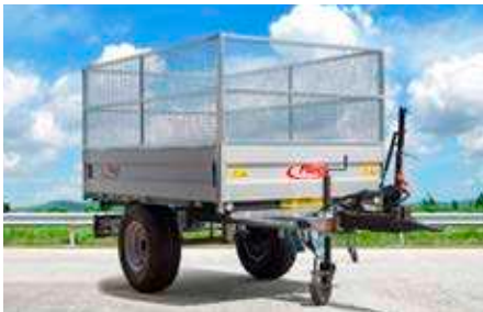
Superleicht: Der EDK 25 mit ALU-Bordwänden und Laubaufsatz
