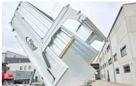
Hydraulische Rückwand ab TMK 200 S XL Verzinkter Aufbau klappbar
