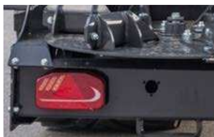
Voll-LED Rückleuchte „Dynamic“ mit dynamischem Blinker aus schlagfestem Material
