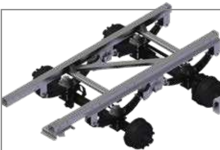
Gigant-Tandemaggregat (TMK 200 ab 5,65 m Muldenlänge)
