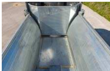
Geringster Verschleiß durch hydr. Schiebesystem – kein Kratzboden
