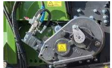
Kratzbodenantrieb Stirnradgetriebe und Hydraulikmotor in Fahrtrichtung links
