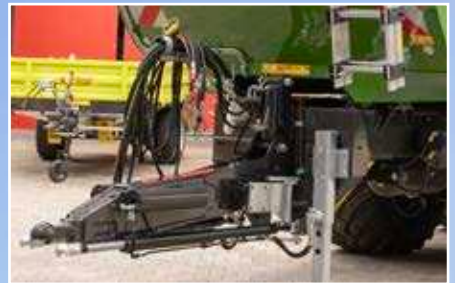
Zugvorrichtung hydraulisch gefedert
