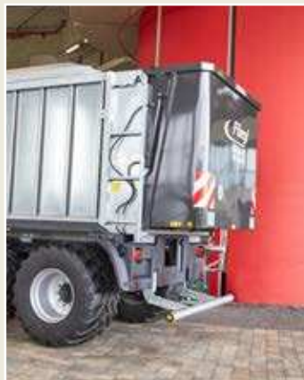
Unterfahrschutz hydr. klappbar: Beim Öffnen der Großraumrückwand klappt der Unterfahrschutz automatisch nach oben bzw. beim Schließen nach unten
