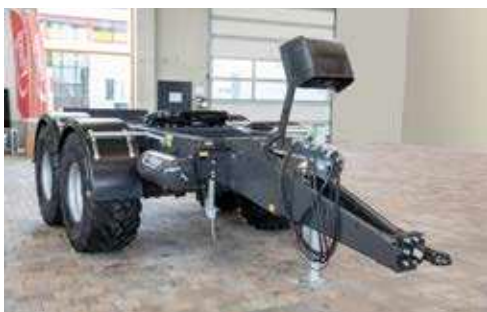
Tandem-Dolly mit 17 t Aufsattellast und 20 t Gesamtgewicht
