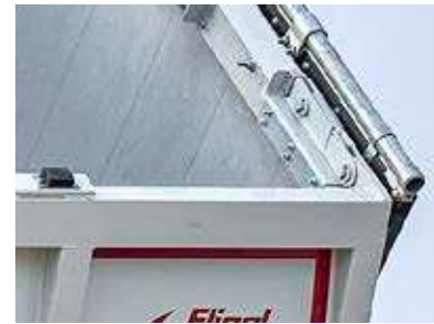
Doppelgelenkscharnier und 2-fache Hakenverriegelung
