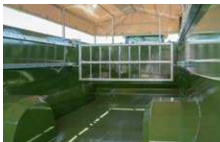
Riffelblech sorgt für einen sicheren Stand der Tiere, Optional Gummiboden
