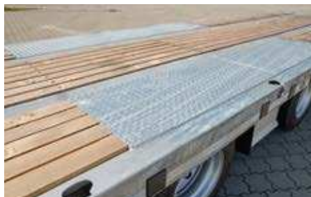
Auffahrampen und Brückenboden aus Weichholz
