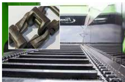
2 außenliegende Kettenstränge aus V2 Kettengliedern mit 50to Bruchlast
