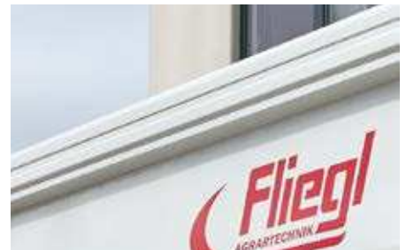
Versteifungsprofile aus einem Stück gekantet und gerundet
