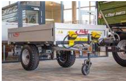
Superleicht: Der EDK 25 mit ALU-Bordwänden und Laubaufsatz
