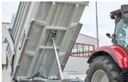
Schwerer Brückenrahmen für extreme Verwindungssteifheit
