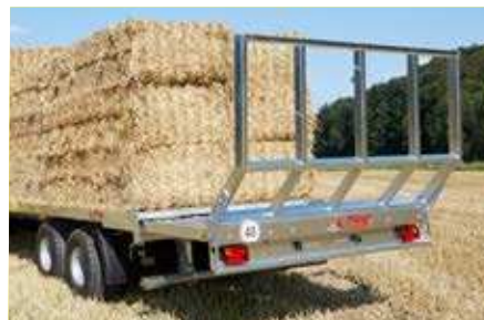
Ballengitter bei Typ DPW 180 B in Serie Optional: Heckausschub (1200 mm)
