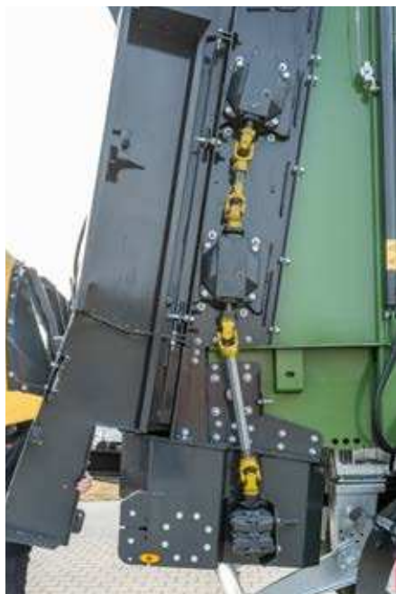
Pohon frézovacích válců přes kloubový hřídel
