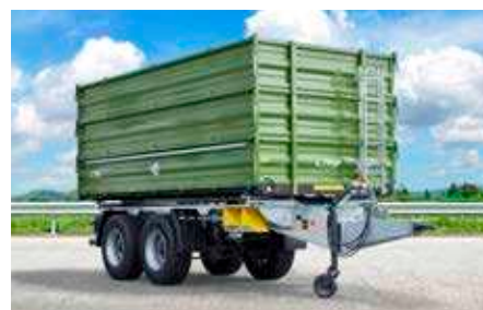
TDK 160 s nástavbou 1800 mm (bočnice 3 x 600 mm)
