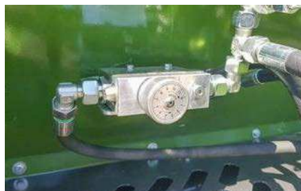
Mechanický potenciometr s nastavitelnou rychlostí posuvu vpředu na korbě rozmetadla
