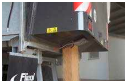
Hydraulická velkoobjemová zadní stěna Velkoobjemová zadní stěna s vyprazdňovacím okénkem
