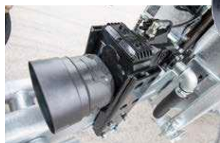
Palubní hydraulika pro maximální výkon nezávisle na tažném vozidle
