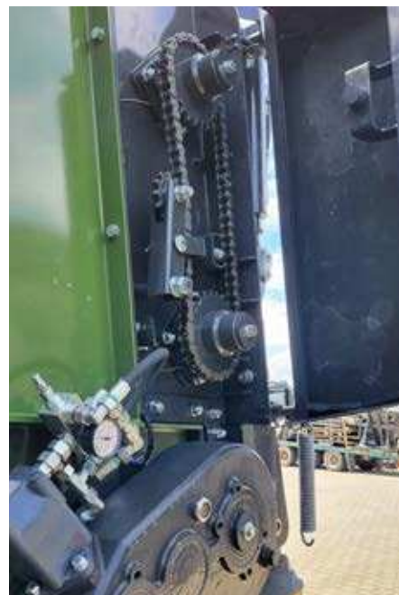
Propojení frézovacích válců pomocí řetězu (KDS 255)
