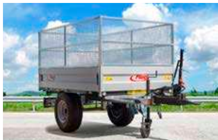
Lehké provedení: EDK 25 hliníkové bočnice a klec na listí
