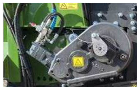
Pohon škrabkového dna Čelní převodovka a hydraulický motor umístěné na levé straně ve směru jízdy.
