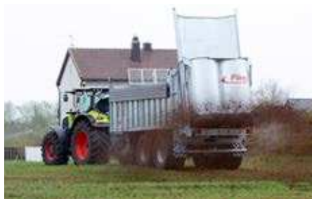
Rozmetadlo »Profi V2« s uzavřenou širokou zadní stěnou rozmetadla
