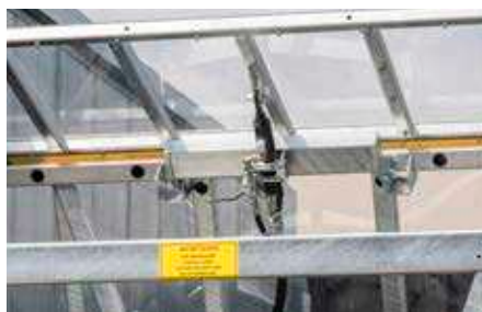
Nástavec na zvýšení mřížové stěny: mechanicky nastavitelný v sériovém vybavení nebo volitelně hydraulicky nastavitelný.
