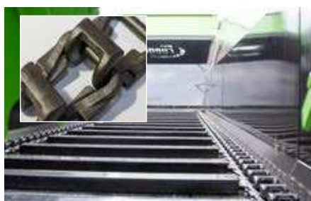
2 vnější řetězové dráhy z článků V2 s mezní pevností 50 t.
