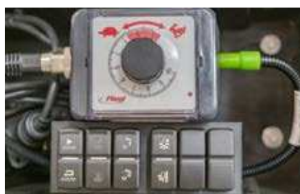
Řídicí blok s elektrickým potenciometrem a ovládacím panelem: Ovládání hydraulických funkcí. Škrabkový pohon, přehrazovací šoupátko a zadní čelo jsou ovládány pomocí panelu. Plynulá regulace rychlosti dopravního dna se provádí pomocí otočného kolečka v kabině traktoru. Rozsah regulace a rozlišení mohou být nastaveny zákazníkem nebo v servisu.
