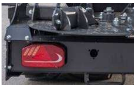
Kompletní LED zadní světa „Dynamic“ s dynamickým ukazatelem změny směru jízdy z odolného materiálu
