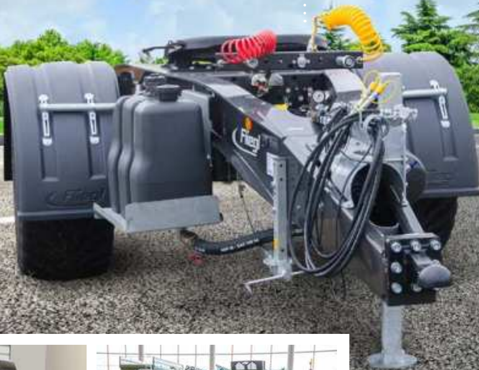
Mechanické nastavení podkovy tahače pro jednonápravový a tandemový přívěs s točnou
