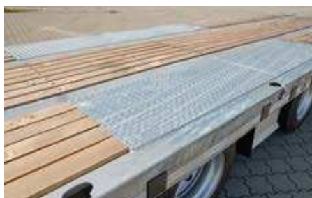
Nájezdové rampy a podlaha mostu z měkkého dřeva
