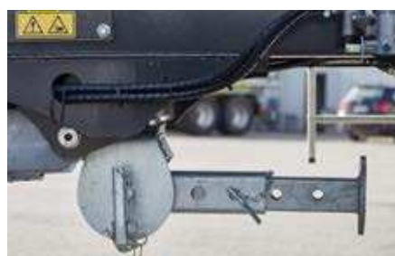
Skládací opěrná noha nastavitelná, uprostřed sklopná směrem dozadu pro dosažení nejlepší stability
