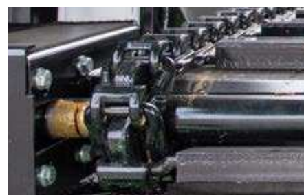
Hvězdicová řetězová kola s nízkou náchyl- ností k znečištění.
