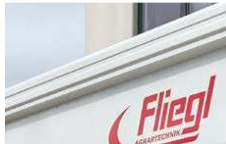
Ztužovací profily lisované a zaoblené z jednoho kusu.
