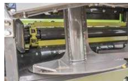
Dno dopravníku je tvořeno 2 plochými stupňovými řetězy s nepřerušnými škrabacími lištami.
