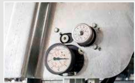
Mechanický potenciometr s nastavitelnou rychlostí posuvu na rozmetadle
