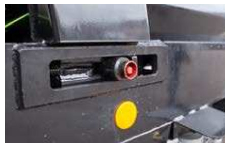
Pohodlně přístupná řetězová kola oboustranně mazaná z hřídele
