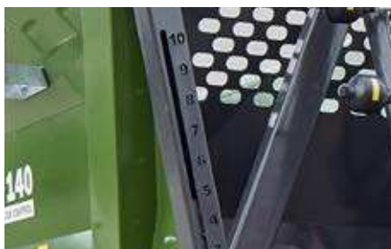
Stupnice otevření gilotiny na čelní straně informuje o poloze otevřené gilotiny.
