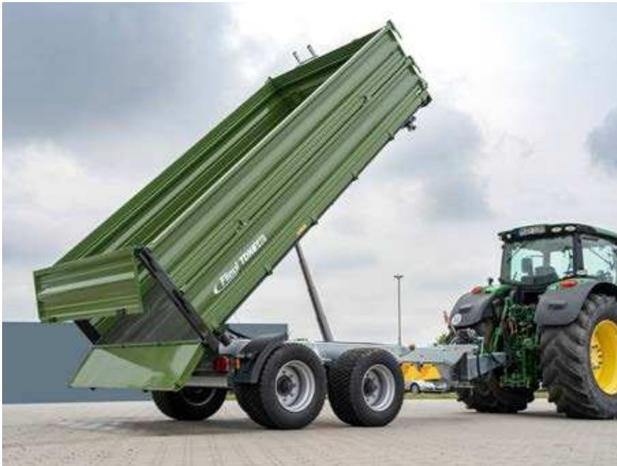
Verze štěrkové klapky s hydraulickou zadní výklopnou zádí 500 mm.
