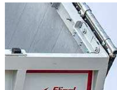
Dvojitý kloubový závěs a 2násobné hákové zajištění
