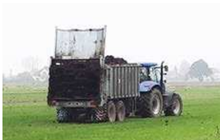
Rozmetadlo »Profi V2n« Pro návěs s vyhrnovacím čelem s výškou korby 1500 mm
