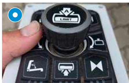
Proportjonalne sterowanie ramieniem „Elefant” za pomocą joysticka
