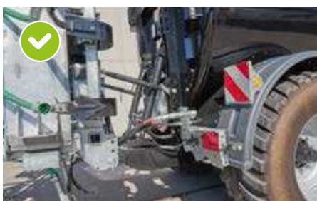
Hydraulika czteropunktowa – siła podnoszenia ok. 6 ton
