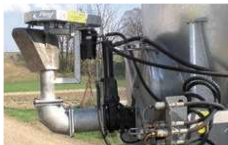
Hydrauliczny miotacz gnojowicy o szerokości roboczej od 12 do 18 m.
