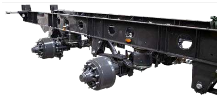
Specjalna konstrukcja ramy ze stali drobnoziarnistej
