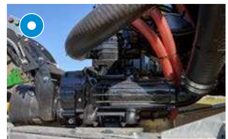
Kompresor Battioni BLW 360: 36 000 l/min lub BLW 240: 24 000 l/min
