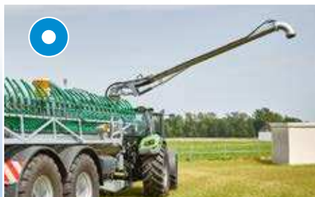
Tylko do wozów asenizacyjnych z pompą: Ramię ssące 8", długość 5 m
