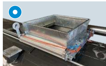
Pneumatycznie zasuwany włącz do zewnętrznego napełniania od góry
