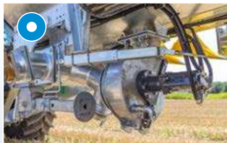
W przypadku wozu asenizacyjnego próżniowego: Turbonapełniarka centralnie pod zbiornikiem - umożliwia zasysanie z obu stron
