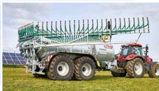
Specjalny mechanizm składający chroniący przed zaginaniem węży wylotowych
