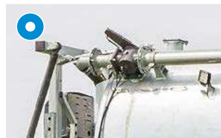
Przewód płuczący z zaworem zasuwowym trójdrożny ułatwia mieszanie
