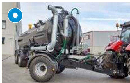
Rura ssąca 8" do wygodnego zasysania
