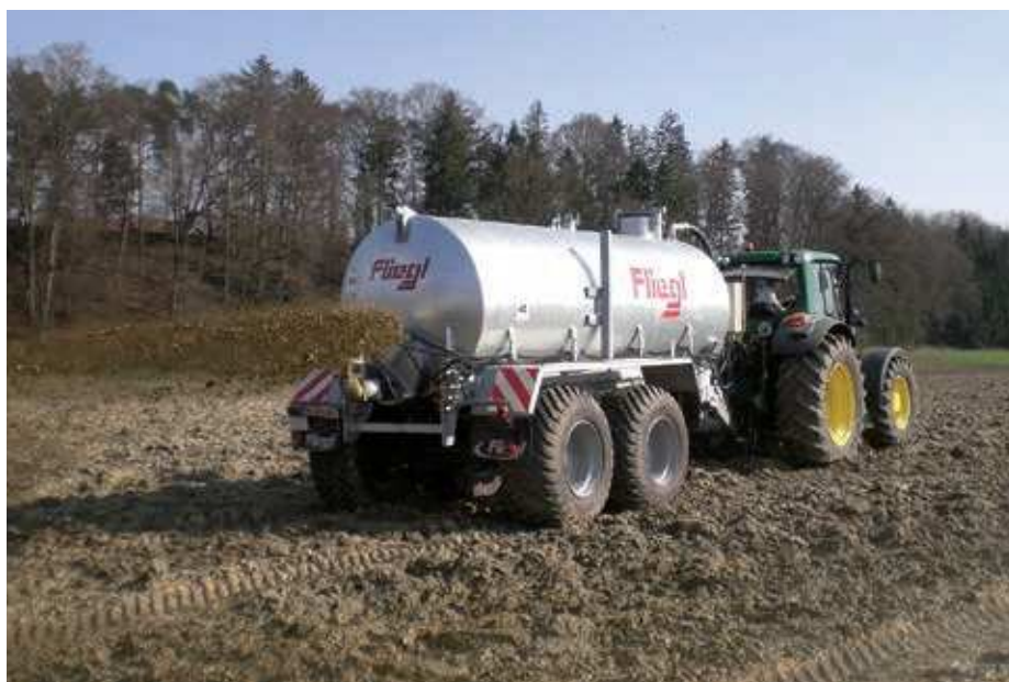
Miotacz do rozlewania gnojowicy w postaci dużych kropli
