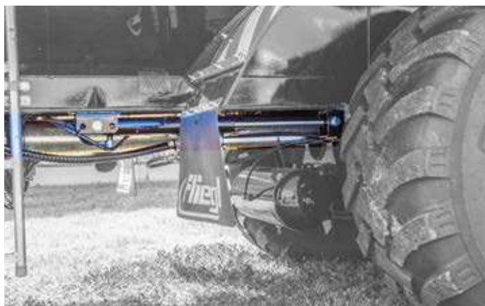
Hydrauliczne przesuwanie osi
