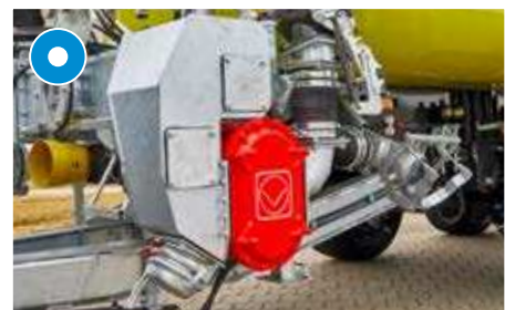
Wyjątkowo prosty w konserwacji: Mechanicznie napędzana pompa krzywkowa włącznie z przekładnią redukcyjną
