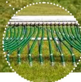
Równomierna jakość rozlewania dzięki krótkim węzom wylotowym
