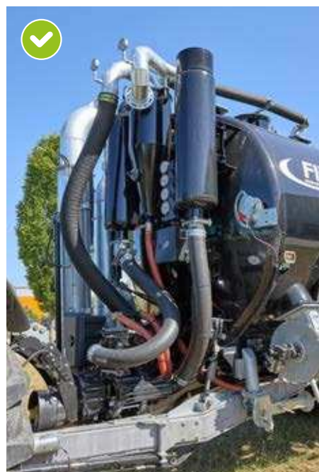
Separator piany, tłumik hałasu z separatorem oleju
