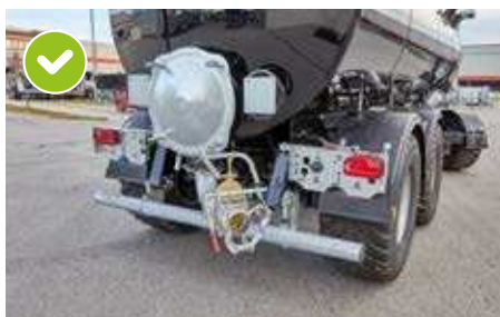
Szybkozłącze 6", obracane o 130°
