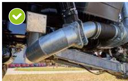
System obejściowy (bypass) dla turbodoładowania z 2 zaworami 10-calowymi – zasysanie i wypompowywanie gnojowicy możliwe przez ramię „Elefant”
