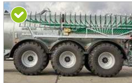
Pojedyncze nadkole w połączeniu z amortyzacją hydrauliczną
