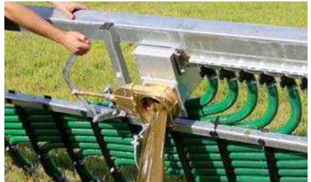
Skrzynia na wychwytywane ciała obce – opróżniana mechanicznie lub hydraulicznie
