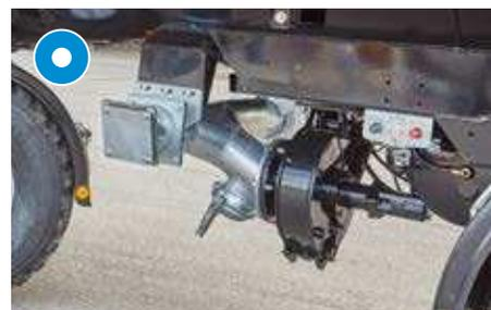
Turbobefüller 8“ für beidseitiges Ansaugen
