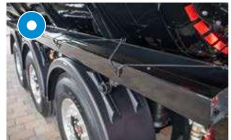
Schlauchwanne für Saugschlauch
