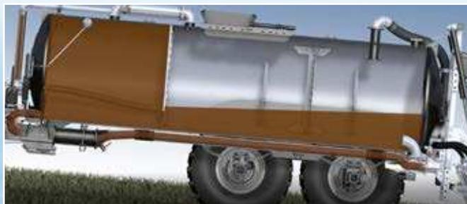
Belüftungsschieber für eine gleichmäßige Befüllung der zwei Kammern
