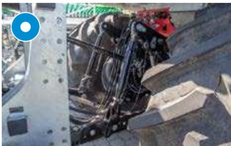
Dreipunkthydraulik wird beim Lenken der Achse mitgeführt
