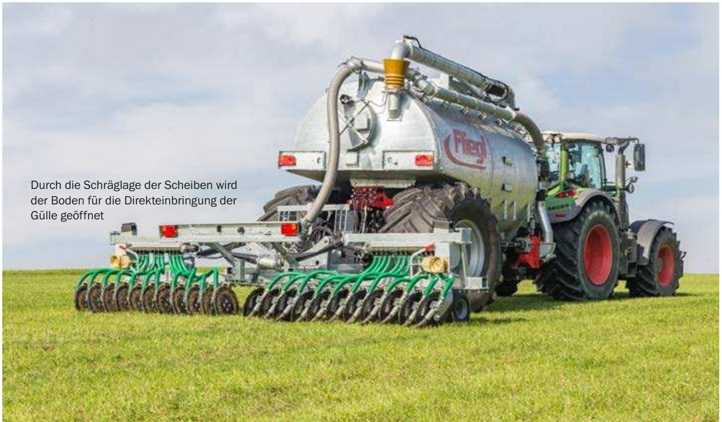
Durch die Schräglage der Scheiben wird der Boden für die Direkteinbringung der Gülle geöffnet
