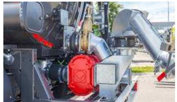
Leistungsstarke Drehkolbenpumpe von
