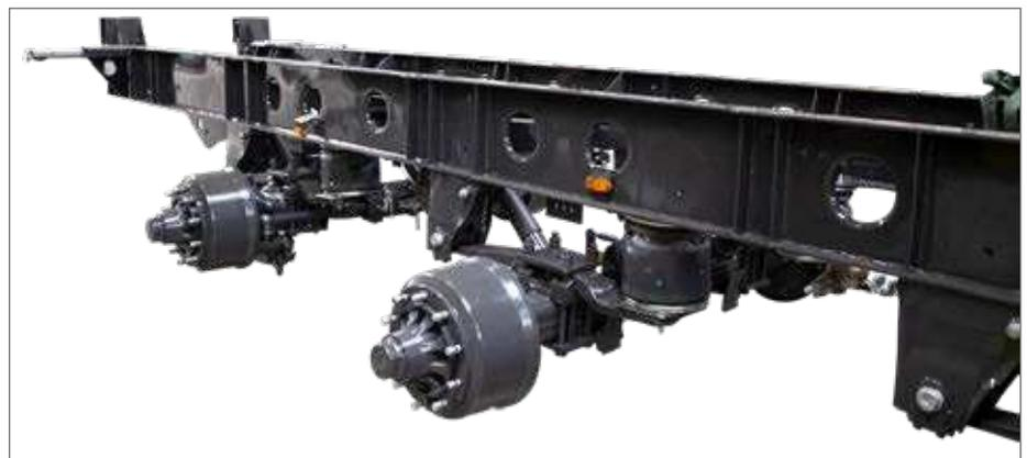
Spezielle Rahmenbauweise aus Feinkornstahl
