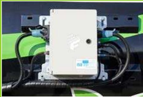
Schaltschrank FFC mit integriertem Jobrechner und ISOBUS-Schnittstelle
