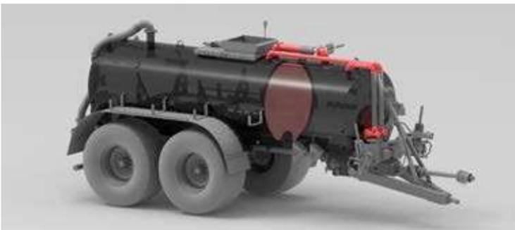
Sobald der Güllespiegel in der hinteren Kammer soweit abgesunken ist, dass Luft über die Öffnung der Trennwand in die vordere Kammer gelangen kann, erfolgt die restliche Entleerung.
