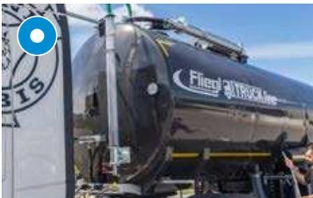
Zusätzliche Füllstandanzeige durch Plexiglasrohr
