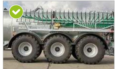
Einzelradausschnitt in Verbindung mit Hydr. Federung
