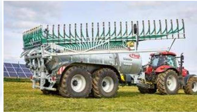
Keine abknickenden Auslaufschläuche durch speziellen Klappmechanismus
