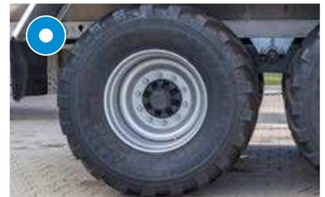
Bereifung bis max. 26,5" möglich
