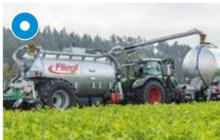
Absaugarm hydraulisch schwenkbar 8°
