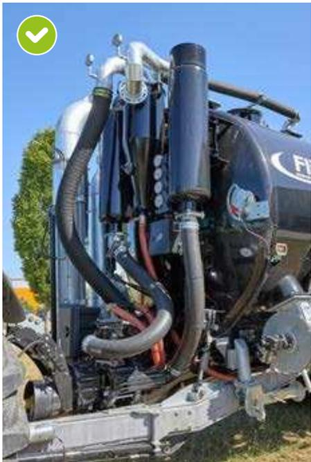
Schaumabscheider; Schalldämpfer mit Ölabscheider
