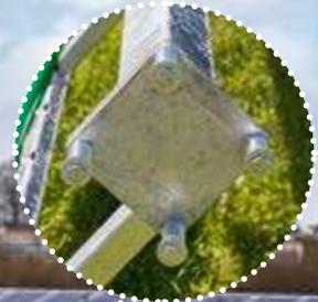
Gleichmäßige Verteilqualität durch kurze Auslaufschläuche
