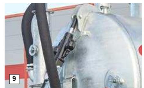
1. Überdruckventil 0,5 bar
