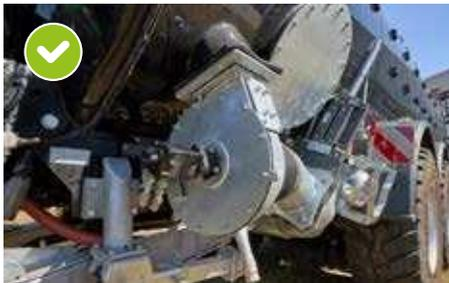
Turbobefüller hydraulisch links
