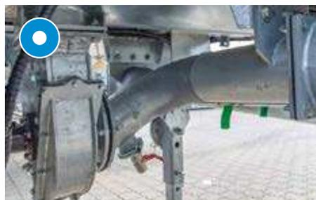
Turbobefüller hydraulisch, mittig unter dem Fass
