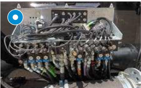
Hydraulischer Load Sensing Steuerblock
