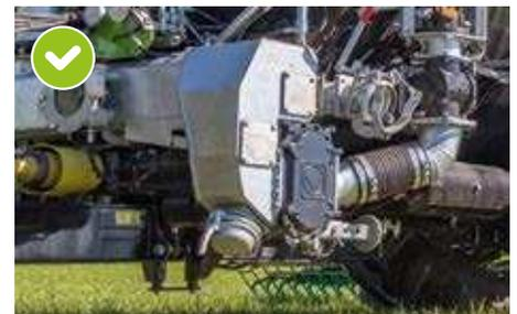
Äußerst wartungsfreundlich: Mechanisch angetriebene Drehkolbenpumpe inkl. Reduziergetriebe
