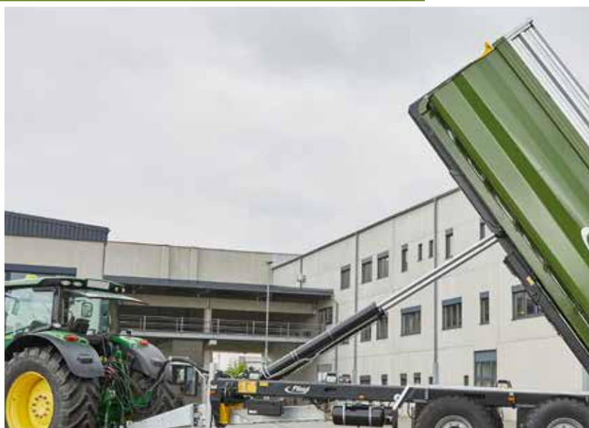
Abrollmulde mit hydraulischer Rückwand
