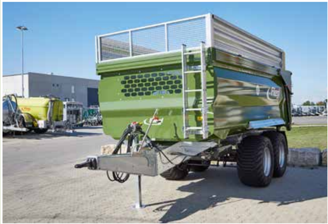
Aufziehbare Steigleiter Sichtfenster vorne in Serie
