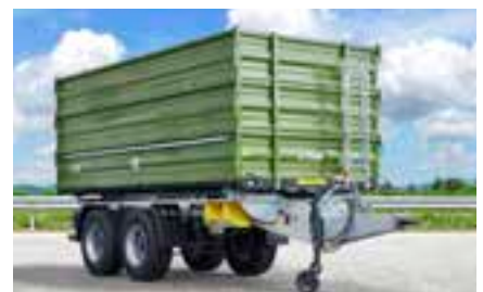
TDK 160 mit Aufbau 1800 mm (3 x 600 mm Bordwand)
