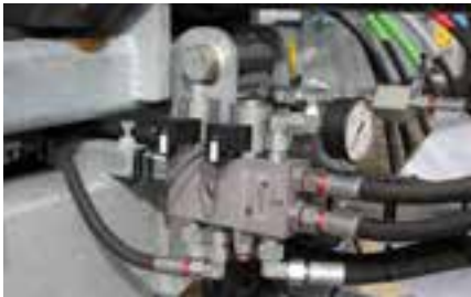
Pressdruck-Ventil: Einfaches und risikofreies Verdichten der Ladung mit reduziertem Druck.
