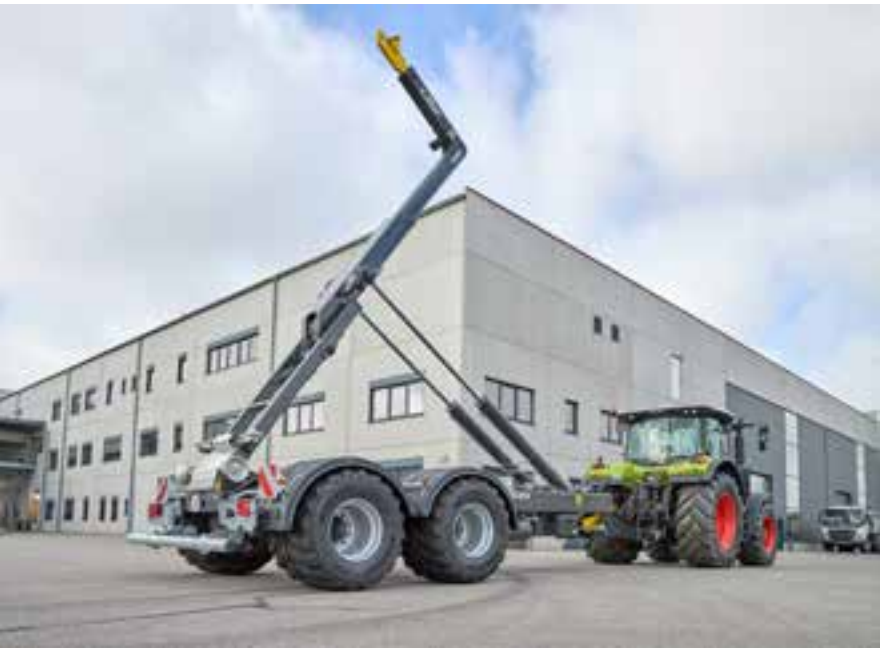
Durch die spezielle Jumbo-Luftfederung kann eine niedrigere Auflagehöhe gewährleistet werden.
