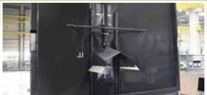
Hydraulischer Stauschieber ermöglicht im beladenem Zustand das komplette Entleeren der Überladeschnecke
