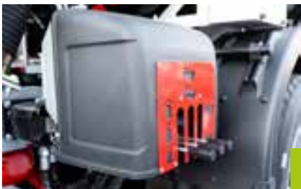
Steuerung über Handhebelbedienung in Kombination mit Keypad
