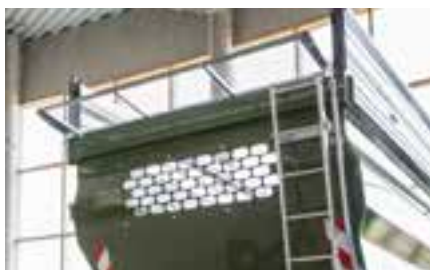
Mechanisch klappbares Frontgitter (nur bei 500 und 600 mm Aufbau)
