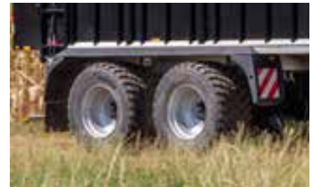
Bereifungsvarianten bis 800/45 R 26.5 oder wahlweise 800/45 R 30.5 (abhängig von Achsabständen)
