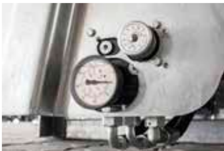
Mechanisches Potentiometer mit einstellbarer Vorschubgeschwindigkeit am Streuwerk
