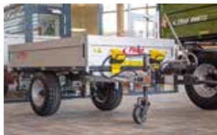
Superleicht: Der EDK 25 mit Aluminium-Bordwänden und Laubaufsatz
