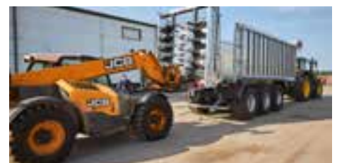
Mit einem Stapler sind alle Streuwerke innerhalb von ca. 20 Minuten einfach montiert mit einer Palettengabel.
