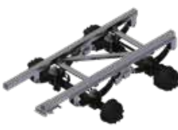
Tandemmaggregat "Gigant" (ab TMK 256 Serie)
