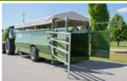
Trenngitter Serie, Treibgitter Option
