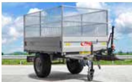
Superleicht: Der EDK 25 mit Aluminium-Bordwänden und Laubaufsatz
