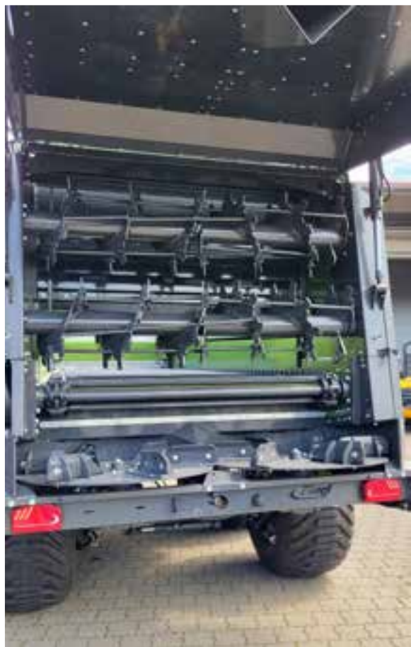
2 Fräswalzen mit drehbaren Zinken aus verschleißfesten Stahl sorgen für beste Materialauflösung. Als Wickelschutz sind Stäbe eingeschweißt, um die Reinigung der Fräswalzen zu erleichtern. Die Fräswalzen sind kardanisch angetrieben und gegen Überlast abgesichert.
