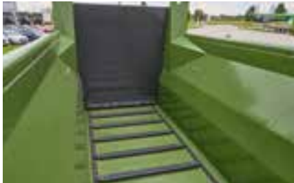
2 Flachstufenketten (Serienmäßig bei KDS 80, 120 und 140)
