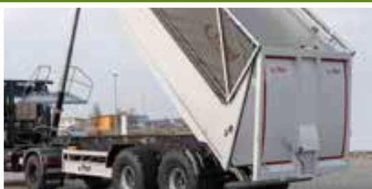
Vier Spannschlösser für Gerteidetransport sowie Abladung über Kornschieber. Umlaufende Gummidichtung in Verbindung mit Spannschlössern auch für feuchte Schüttgüter.
