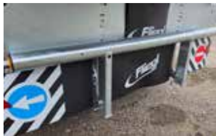
Unterfahrschutz mechanisch klappbar
