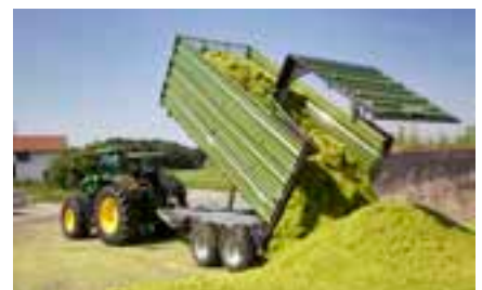
Silierkipper mit hydraulischer Rückwand
