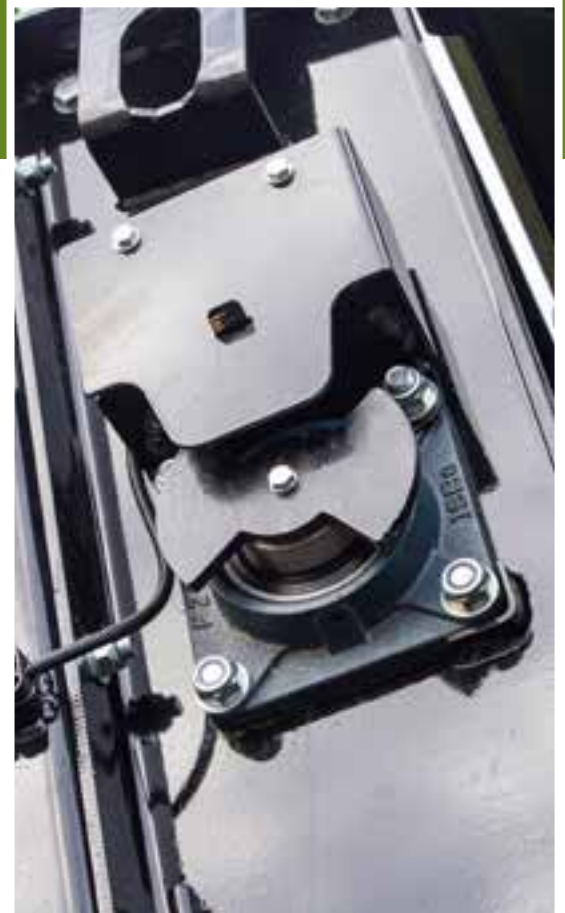
Elektronische Drehzahlüberwachung in Verbindung mit ISOBUS-Steuerung "SpreaderControl". Überwacht die Geschwindigkeit der Mischwalzen und schaltet das Materialbodenkettenband bei Bedarf automatisch ab, um das Gesamtsystem vor Schäden durch Fremdkörper optimal zu schützen.
