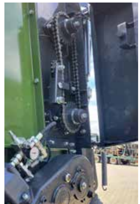
Fräswalzenverbindung über Kette (Fräswalzendurchmesser 560 mm)
