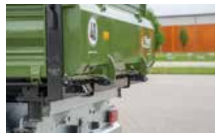
Robuste Klappe mit 2-Zylinder Ausführung (TDK S)
