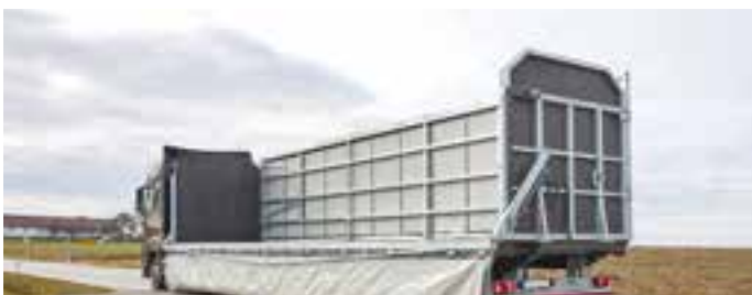
Hydraulische Ladungssicherung für den sicheren Transport von Rund- und Quaderballen
