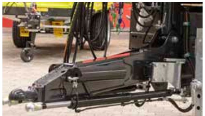
Durchgehende Zugeinrichtung hydraulisch gefedert
