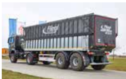
TopLift light: Abdecknetz seitlich klappbar
