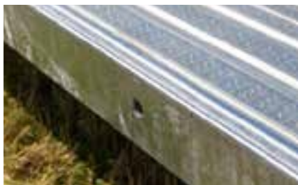
Zurrlöcher seitlich im Rahmen integriert
