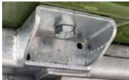
Wiegeeinrichtung Präzise Ermittlung der Zuladung. In Verbindung mit der ISOBUS-Steuerung "SpreaderControl" kann die Steuerung anhand der Gewichtsveränderung die Kratzbodengeschwindigkeit regeln.
