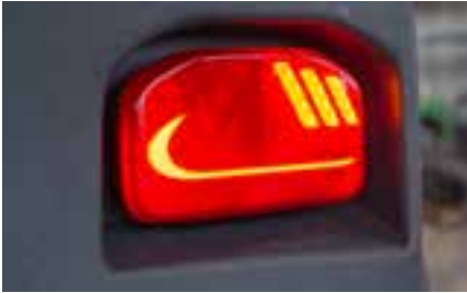
Voll-LED Rückleuchte mit dynamischer Blinkerfunktion
