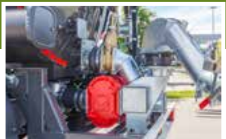
Leistungsstarke Drehkolbenpumpe von Vogel- sang VX 186-260 Q mit Nachsaugfunktion zum Leersaugen des Gülleschlauches nach Vollmeldung Leistungsstarke Drehkolben- pumpe von Vogelsang VX 186-260 Q mit Nachsaugfunktion zum Leersaugen des Gülle- schlauches nach Vollmeldung
