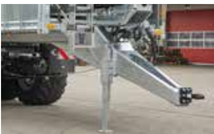
Drehbarer Zugholem für Oben- und Untenanhängung; optional auch gefedert verfügbar
