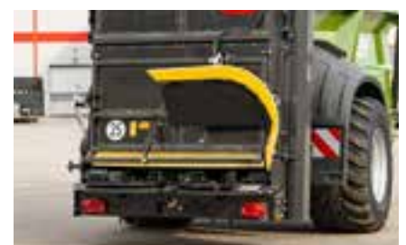
Randstreueinrichtung Als Einzelanbau links oder rechts bzw. auch beidseitig erhältlich
