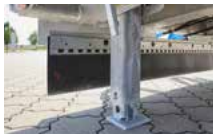
Heckabstützung mit zwei Fallstützen
