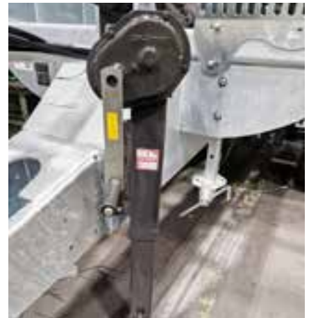
Stützfuß mit zwei Geschwindigkeiten
