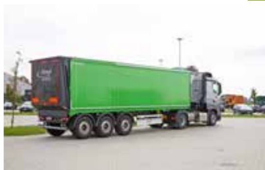
ASS 398 GreenTec mit Seitenwänden aus Aluminium
