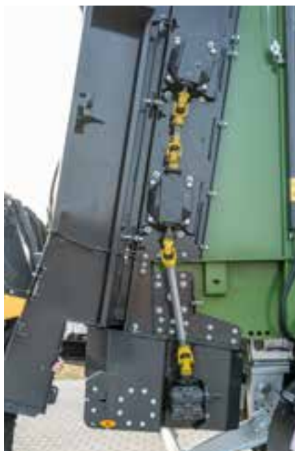
Fräswalzenantrieb über Gelenkwelle (Fräswalzendurchmesser 770 mm)
