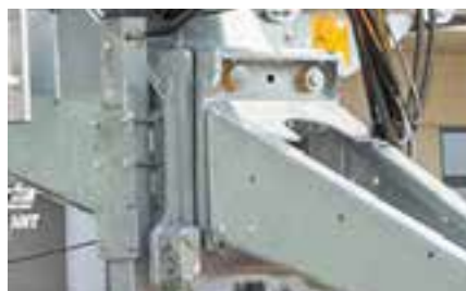
Drehbarer Zugholem für Oben- und Untenanhängung; optional auch gefedert verfügbar
