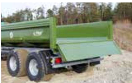
Schotterklappe bei TMK 130 S und TMK 200 S
