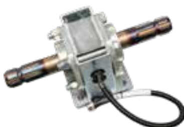
i-Sens Drehmomentüberwachung Wird ein eingestellter Drehmomentgrenzwert erreicht, so wird der Vorschub kurzzeitig ausgesetzt.
