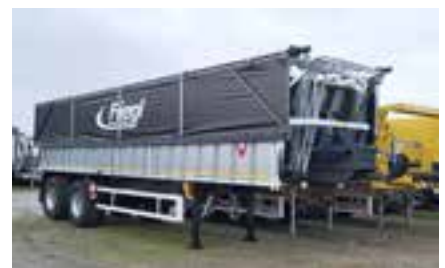
TopLift: Innerhalb kürzester Zeit können die beiden Planenhälften geöffnet und geschlossen werden
