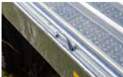
Zurrösen im Rahmen integriert (B)
