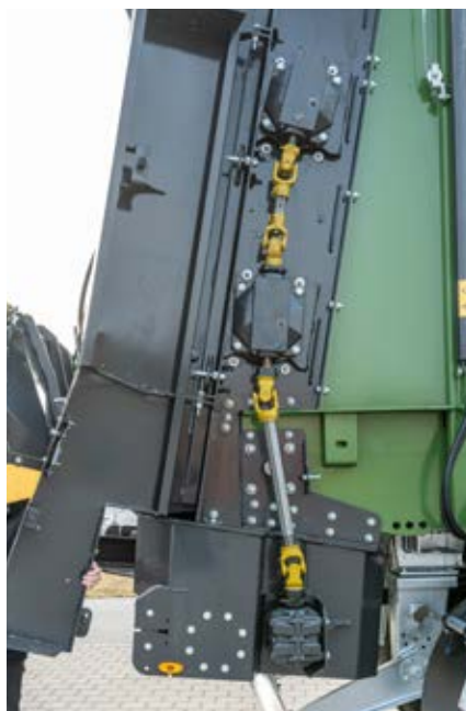
Fräswalzenantrieb über Gelenkwelle (Fräswalzendurchmesser 770 mm)
