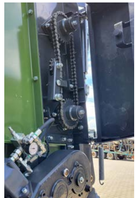
Fräswalzenverbindung über Kette (Fräswalzendurchmesser 560 mm)
