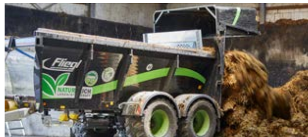
Der ADS ist optional mit Großraumrückwand 800 mm umrüstbar und als Transportanhänger nutzbar (ab ADS 80)
