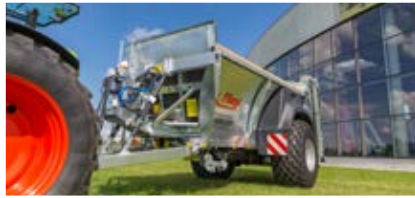
Hydraulische Deichselfederung, bester Fahrkomfort (ab ADS 100)
