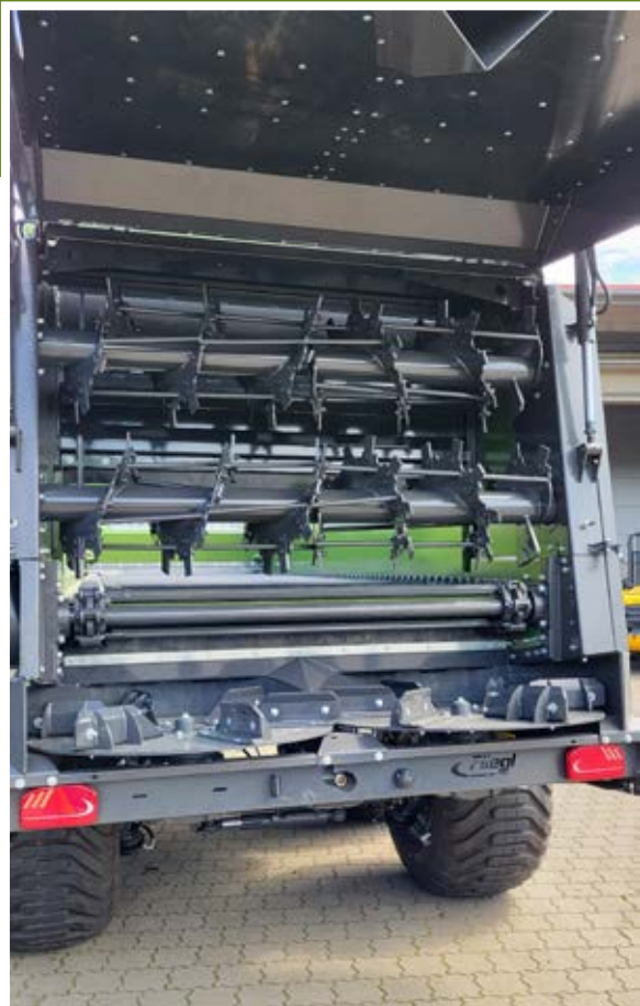
2 Fräswalzen mit drehbaren Zinken aus verschleißfesten Stahl sorgen für beste Materialauflösung. Als Wickelschutz sind Stäbe eingeschweißt, um die Reinigung der Fräswalzen zu erleichtern. Die Fräswalzen sind kardanis angetrieben und gegen Überlast abgesichert.
