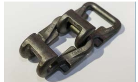
V2-Kette mit 50 t Bruchlast (Serie ab KDS 165)
