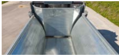
Geringer Verschleiß durch hyd- raulisches Schiebesystem – kein Kratzboden
