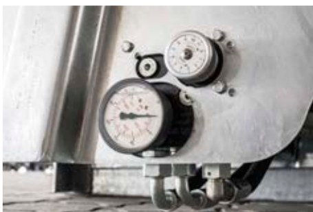
Mechanisches Potentiometer mit einstellbarer Vorschubgeschwindigkeit am Streuwerk
