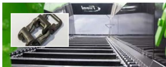
Zwei außenliegende Kettenstränge aus V2 Kettengliedern mit 50 t Bruchlast
