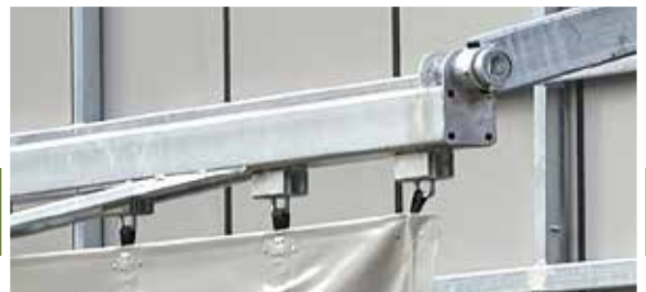
Durchgehende Plane mit integrierten Spanngurten zur sicheren Fixierung der Ladung
