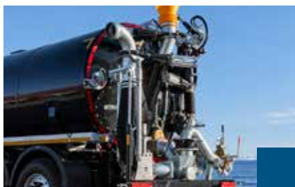
Saugrüssel ansteuerbar über Funkfernbedienung für bequemes ansaugen ohne abzu- steigen
