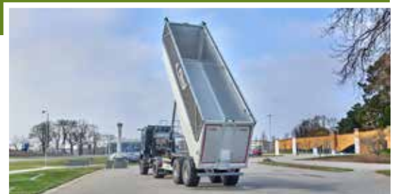
Hydraulisches Klappdach TopLift light: Mit Nettabdeckung zur Ladungssicherung (Option)
