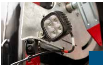
Arbeitsscheinwerfer und Kamera für optimale Sichtverhältnisse beim Saugen mit dem 8-Zoll-Saugarm
