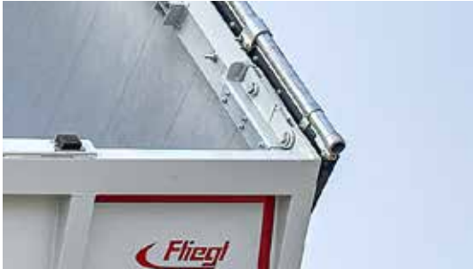
Doppelgelenkscharnier und zweifache Hakenverriegelung
