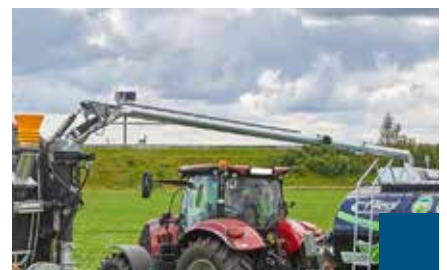
Überladearmlänge von 7 m hydraulisch schwenkbar
