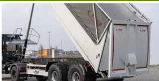
Vier Spannschlösser für Gereteidetransport sowie Abladung über Kornschieber. Umlaufende Gummidichtung in Verbindung mit Spannschlössern auch für feuchte Schüttgüter.
