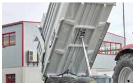
Schwerer Brückenrahmen für extreme Verwindungssteifigkeit
