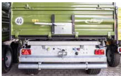
40 km/h Ausführung mit Unterfahrschutz und Kotflügel
