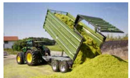
Silierkipper mit hydraulischer Rückwand
