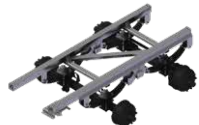
Tandemaggregat "Gigant" – Parabelfederung
