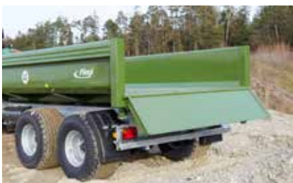
Schotterklappe bei TMK 130 S und TMK 200 S
