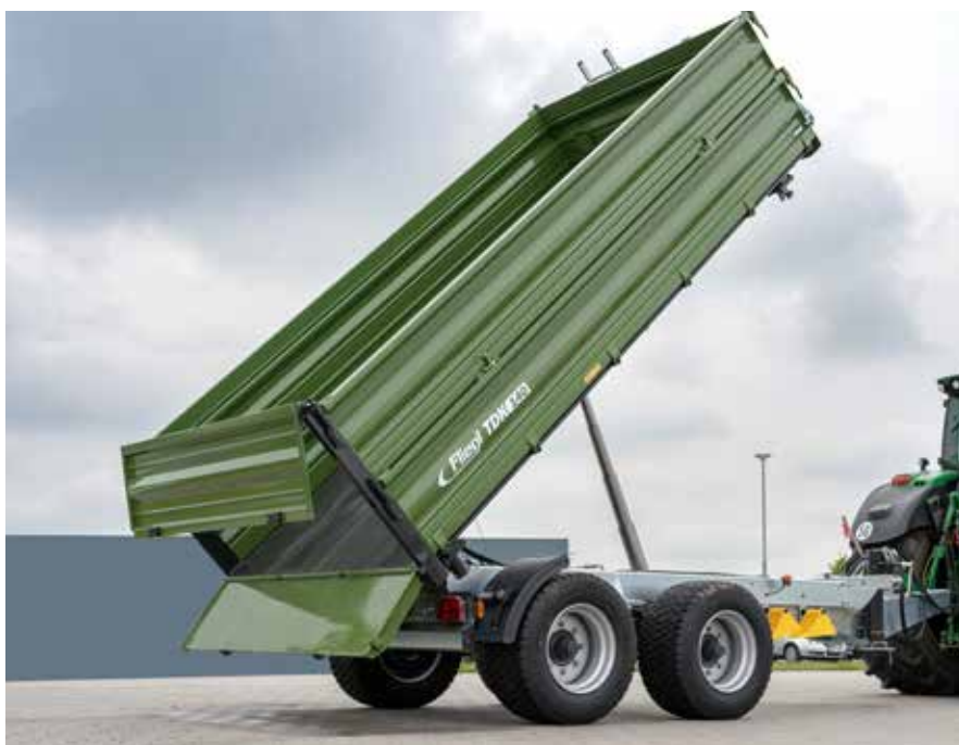
Schotterklappenausführung mit hydraulischer Heckklappe 500 mm (TDK S)
