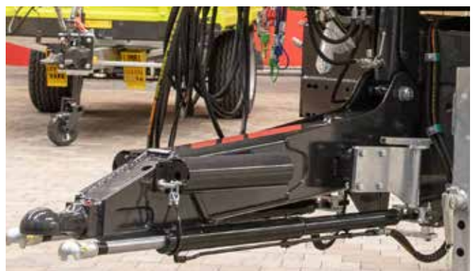
Durchgehende Zugeinrichtung hydraulisch gefedert
