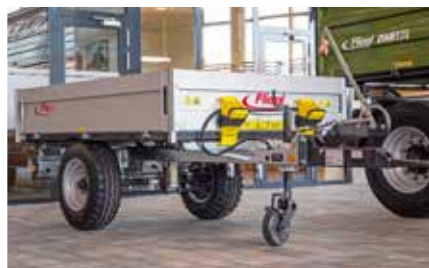
Superleicht: Der EDK 25 mit Aluminium-Bordwänden und Laubaufsatz
