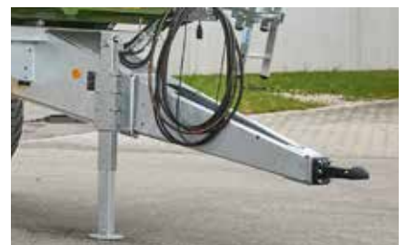
Drehbarer Zugholm für Oben- und Untenan- hängung; optional auch gefedert verfügbar
