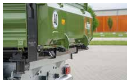
Robuste Klappe mit 2-Zylinder Ausführung (TDK S)
