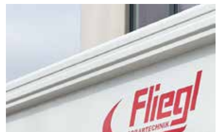
Versteifungsprofile aus einem Stück gekantet und gerundet
