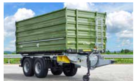
TDK 160 mit Aufbau 1800 mm (3 x 600 mm Bordwand)
