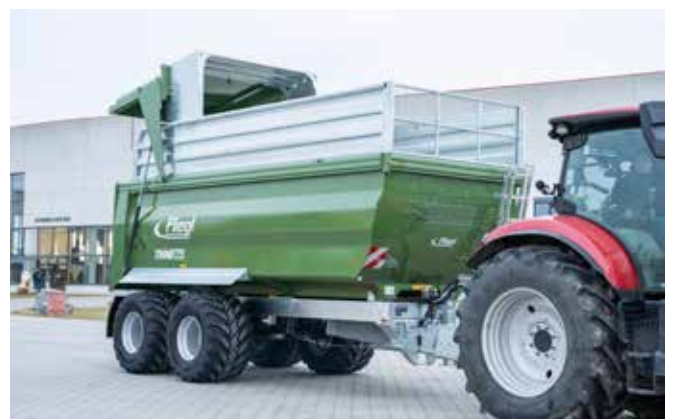
800 mm Aufbau für TMK mit Stirnwandschrägung und 300 mm Groß- raumrückwand, nur mit 1500 mm Seitenwänden
