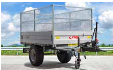
Superleicht: Der EDK 25 mit Aluminium-Bordwänden und Laubaufsatz
