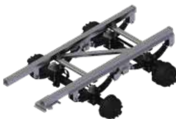
Tandemaggregat "Gigant" (ab TMK 256 Serie)
