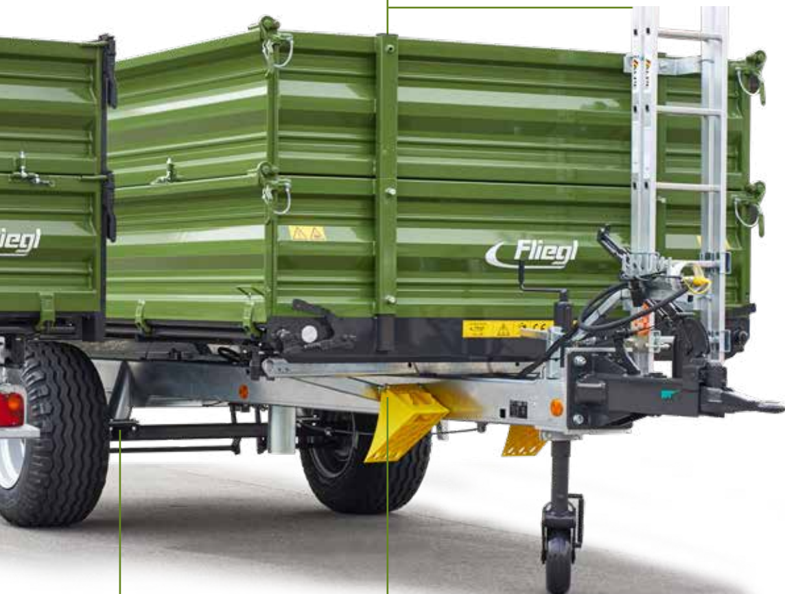
Option: Erster Aufbau mit Steigleiter (ab EDK 40)
