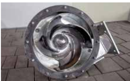
Turbobefüller seitlich links oder rechts möglich (je nach Fasslinie, seitlich am Fass oder unter dem Fass). Öffnungsmöglichkeit ermöglicht optimalen Zugang
