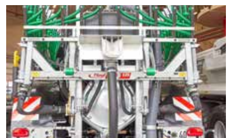
Zusätzliche Ausbringmöglichkeit mit angebautem Prallkopfverteiler
