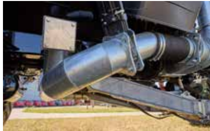
Bypass-System für Turbobefüller mit 2 x 10 Zoll Schieber, Ansaugen und Rausdrücken der Gülle über Saugarm Elefant möglich
