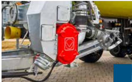
Drehkolbenpumpe mechanisch angetrieben inkl. Reduziergetriebe und hoher Wartungsfreundlichkeit
