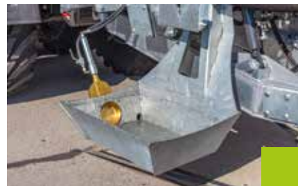
Auffangwanne für Saugausleger Transfill mit automatischer Entleerung auf dem Acker
