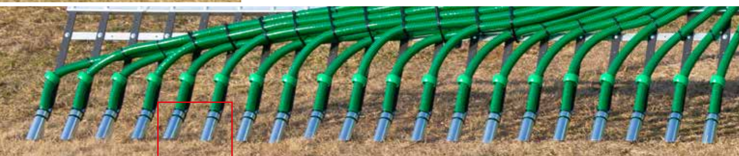
Schlitzkufenabstand von nur 187,5 mm
