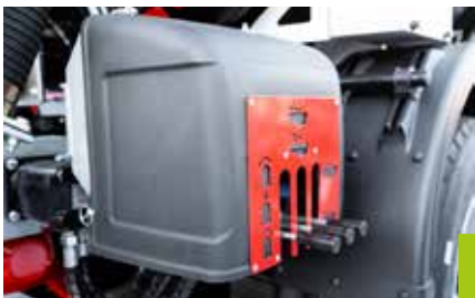
Steuerung über Handhebelbedienung in Kombination mit Keypad
