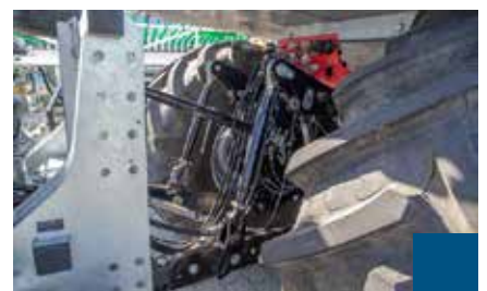
Dreipunkthydraulik wird beim Lenken der Achse mitgeführt
