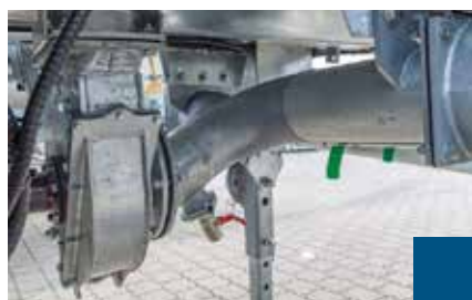
Turbobefüller hydraulisch, mittig unter dem Fass bei Vakuumfässern
