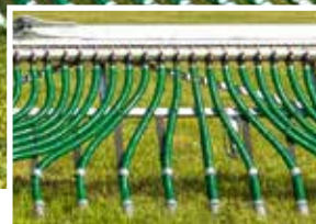
Gleichmäßige Verteilqualität durch kurze Auslaufschläuche
