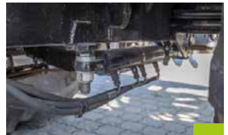
Äußerst wartungsfreundlich: Mechanisch angetriebene Drehkolbenpumpe inkl. Reduziergetriebe
