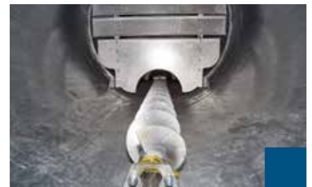
Hydraulisches Innenrührwerk über Rührschnecke
