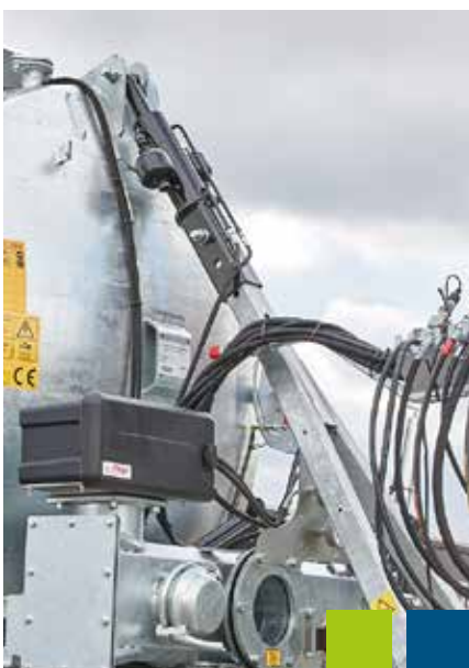
Hydraulische Deichselfederung (bei vielen Fasslinien in Serie)
