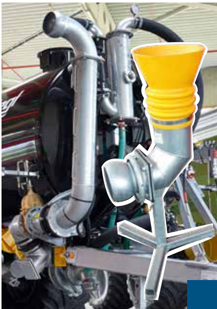
Saugrüssel - links oder rechts - für bequemes Ansaugen inkl. Andockstation
