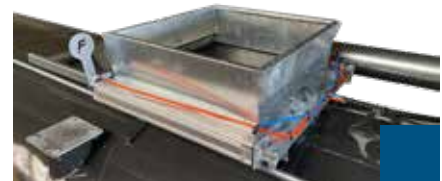
Pneumatischer Schubdeckel für externe Be- füllung von oben
