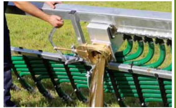
Staukasten für Fremdkörper, mechanisch oder hydraulische Entleerung
