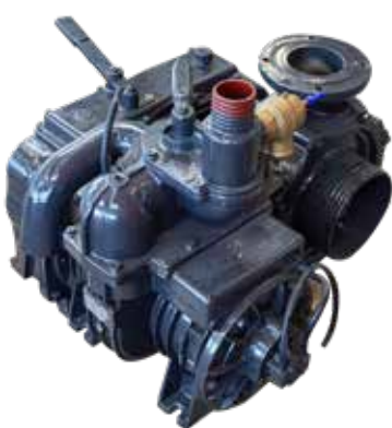
GARDA-Pumpe Kombination aus Kreiselpumpe und Kompressor
