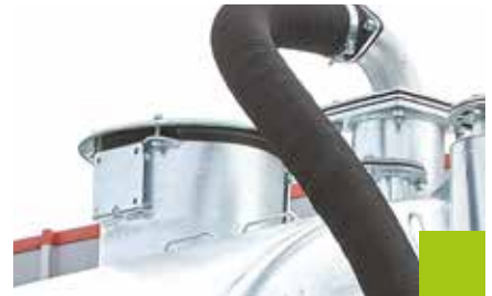
Vorbereitung für Einfülldom
