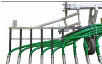
Nur bei SKATE 150 und 180: Integrierter Anfahrschutz – durch Einklappen reduziert sich die Arbeitsbreite
