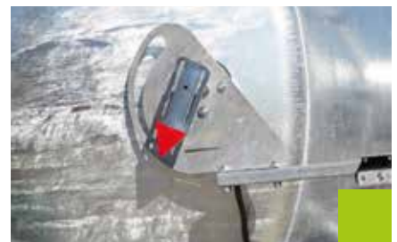
Füllstandsanzeiger mit Schwimmerkugel
