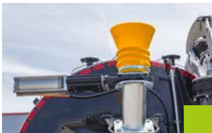
Andocktrichter hinten oben am Fass
