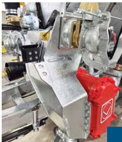
Drehkolbenpumpe Vogelsang für die Fasslinien, Alpha Line, Big Foot, TWIST Line und POLY Line
