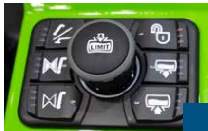
Bedienpult mit Joysticksteuerung für Saugarm „Elefant“; Proportionale Betätigung möglich (nur für bestimmte Fasslinien erhältlich)
