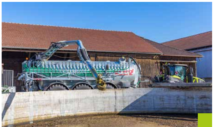
Saugausleger Transfill - bedienbar über Joystick-Steuerung. Proportionale Bedienung. Komplette ausgefahren ca. 10 m. Flexibler Einsatz durch stabilen Drehkranz und drei Gelenken. Enorme Saugleistung durch Turbobefüller am Ende des Auslegers.
