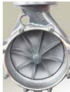
Ansicht der Kreiselpumpe von innen
