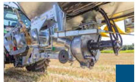
Turbobefüller mittig unter dem Fass – für beidseitiges Ansaugen
