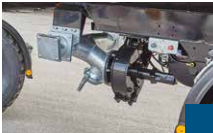
Turbobefüller 8“ für beidseitiges Ansaugen
