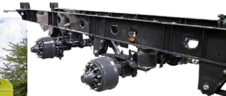
Spezielle Rahmenbauweise aus Feinkornstahl
