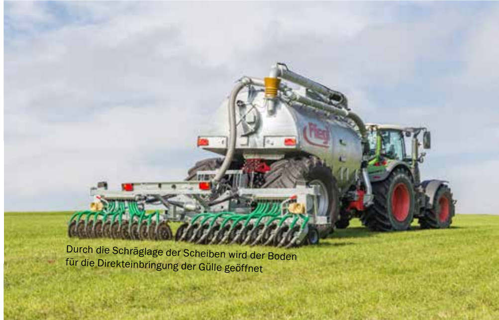
Einbringung ca. 5-10 cm direkt in den Boden
