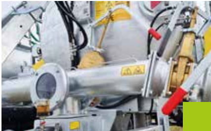
Ansaugrohr mit Schauglas und Fremdkörperabscheider
