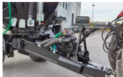
Hitzebeständiger Kompressor 13500 mechanisch angetrieben
