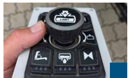
Proportionale Bedienung von Elefant über Joystick
