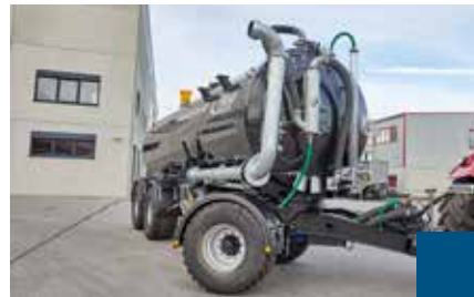
8“ Saugrüssel für komfortables Ansaugen
