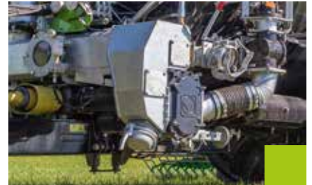
Äußerst wartungsfreundlich: Mechanisch angetriebene Drehkolbenpumpe inkl. Reduziergetriebe
