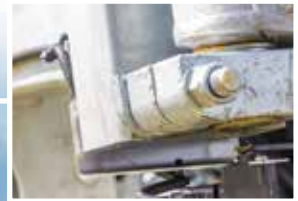
Winkelsensoren links und rechts für gleichmäßiges Aus- und Einklappen am Hang
