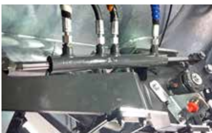
Bypassregelung für Schieber Seitenabschaltung hydraulisch. Nur bei Komplettbestellung mit Pumpfässern möglich
