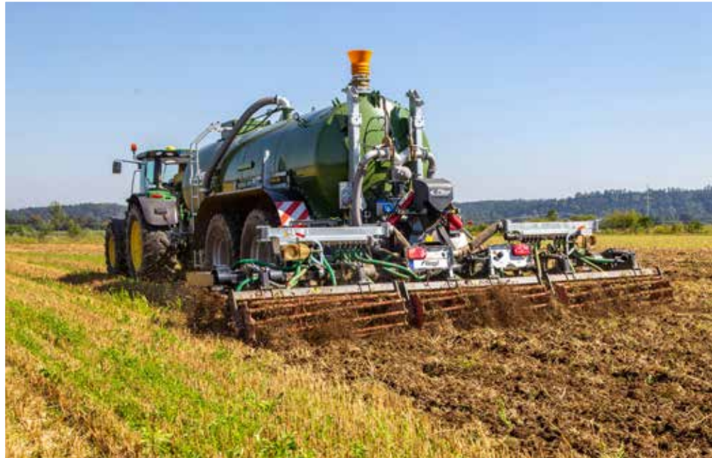
Einbringung ca. 10-20 cm direkt in den Boden
