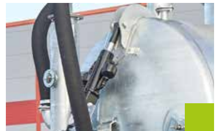
Hydraulische Deichselfederung (bei vielen Fass-Linien in Serie)
