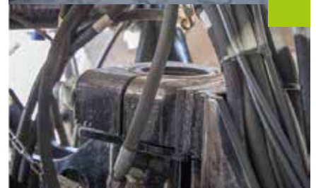
Achse zentral gelagert, hydraulische Lenkung für Fahrt im Hundegang
