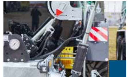
Hydraulische Pumpenumschaltung mit Plattenschieber (hydr. Steuerblock erforderlich)
