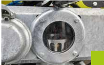
Deutlich zu sehen im Schauglas: Güllefluss und Fremdkörperabscheider
