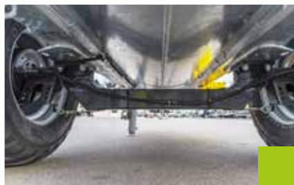
Gekröpte Achse bei 5000 – 7500 Liter Niedriger Schwerpunkt sorgt für optimales Fahrverhalten am Hang
