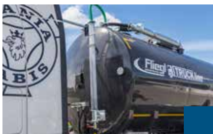
Zusätzliche Füllstandanzeige durch Plexiglasrohr
