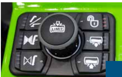
Bedienpult mit Joysticksteuerung für Saugarm „Elefant“; Proportionale Betätigung möglich (nur mit bestimmte Fasslinien erhältlich)
