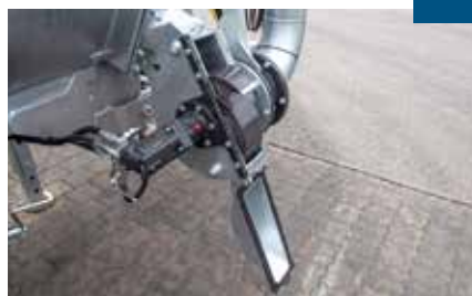
Turbobefüller seitlich links oder rechts möglich (je nach Fasslinie, seitlich am Fass oder unter dem Fass). Öffnungsmöglichkeit ermöglicht optimalen Zugang
