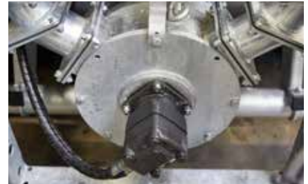
Bei extrem hohen Faseranteil nachrüstbar: Zerkleinerungscutter zum Anbau zentral zwischen Fass und Verteiler (erforderliche Ölleistung 60 l). Der Antrieb erfolgt direkt über das Schleppersteuergerät
