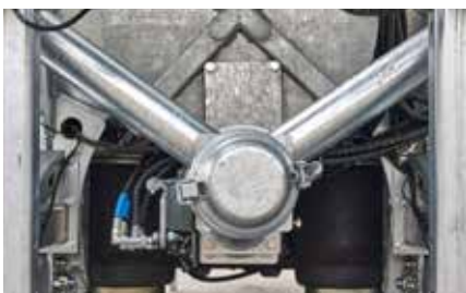
Serie: T-Stück für zusätzlichen Ausgang, Seitenabschaltung erforderlich
