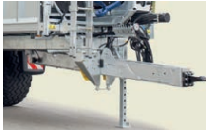
Durchgehend hydraulisch gefederte Zugeinrichtung für Untenanhangung
