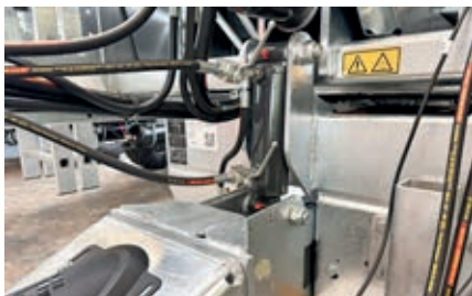
Zugholm hydraulisch gefedert
