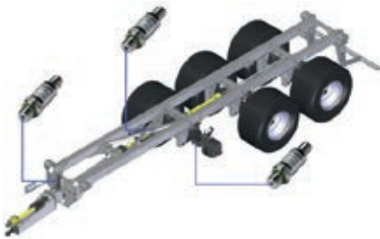
FWS Hydro: Kontinuierliche Gewichtsermittlung über Sensoren an den Hydraulikzylindern von Deichsel und je einem Zylinder in Fahrtrichtung links und rechts.
