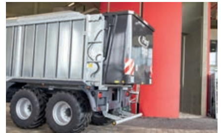
Unterfahrschutz hydraulisch klappbar
