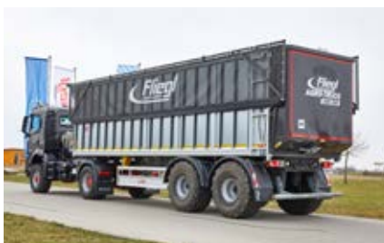
TopLift light: Abdecknetz seitlich klappbar
