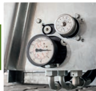
Mechanisches Potentiometer mit einstellbarer Vorschubgeschwindigkeit am Streuwerk
