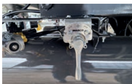
Heben- und Senken-Ventil bei der Luftfederung
