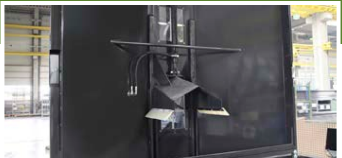
Hydraulischer Stauschieber ermöglicht im beladenem Zustand das komplette Entleeren der Überladeschnecke
