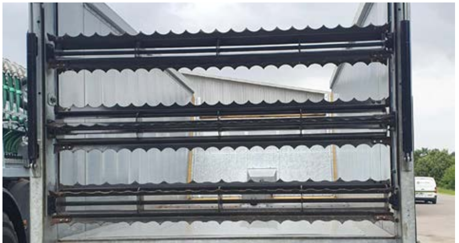
Dosierwalze mit drei liegenden Fräswalzen und automatischer Vorschubregelung
