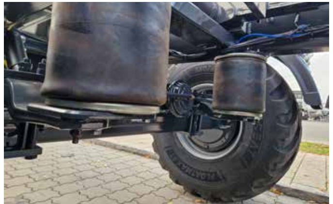
Luftfederaggregat für perfekten Fahrkomfort mit automatischer Kippabsenkung für beste Standsicherheit
