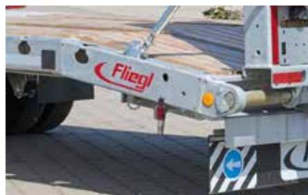
Brücke hinten auf ca. 900 mm abgeschrägt
