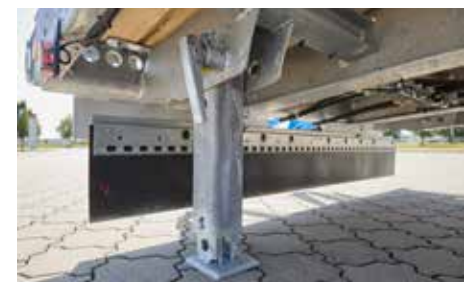
Heckabstützung mit zwei Fallstützen
