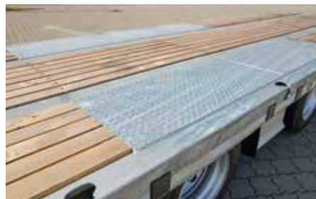
Auffahrampen und Brückenboden aus Weichholz
