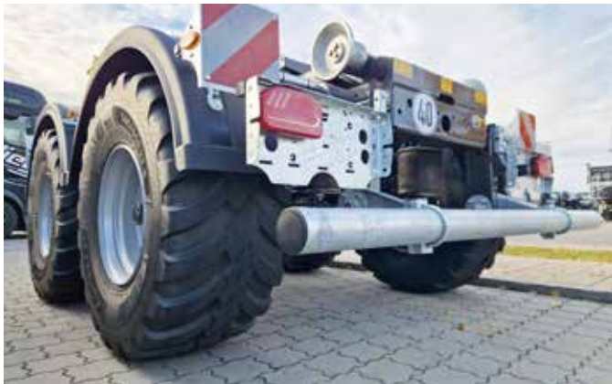
Heck vorbereitet für Anhängerkupplung, Hydraulikleitungen und Druckluftanschlüsse
