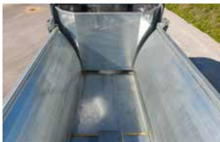
Geringer Verschleiß durch hydraulisches Schiebesystem – kein Kratzboden
