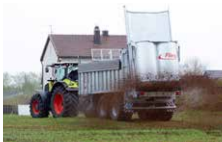
Streuwerk "Profi V2" mit geschlossener Breitstreurückwand für trockene Streugüter.
