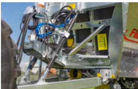
Hydraulische Deichselfederung, bester Fahrkomfort
