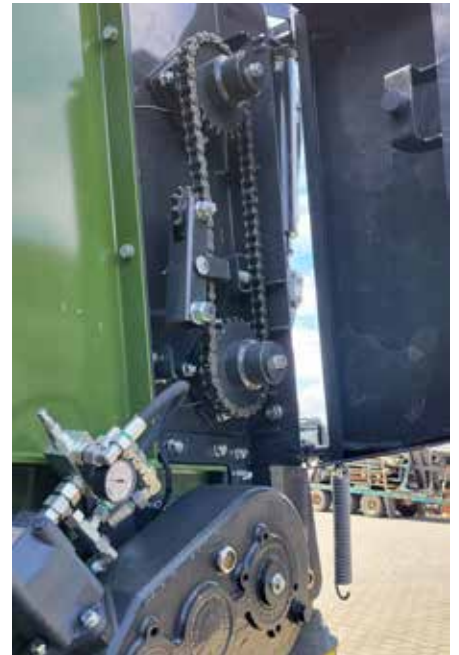
Fräswalzenverbindung über Kette (Fräswalzendurchmesser 560 mm)
