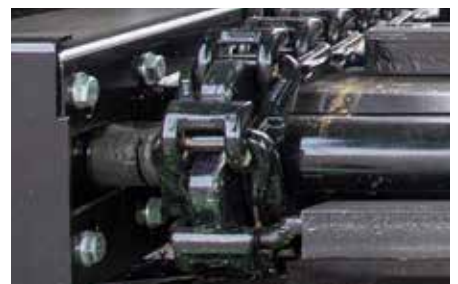
Sternförmige Kettenräder mit geringer Verschmutzungsanfälligkeit
