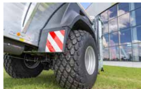
Optional: 40 km/h Ausführung mit Kotflügeln ab ADS 80
