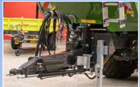
Durchgehende Zugeinrichtung hydraulisch gefedert
