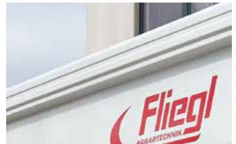
Versteifungsprofile aus einem Stück gekantet und gerundet
