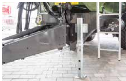
Ab TMK 256 serienmäßig: Hydraulische Deichselfederung und mechanischer Fall- stützfuß
