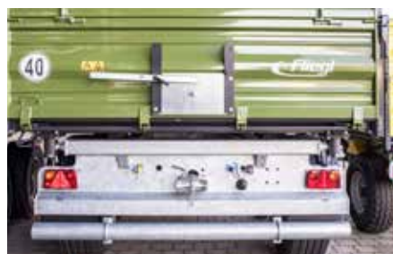
40 km/h Ausführung mit Unterfahrschutz und Kotflügel
