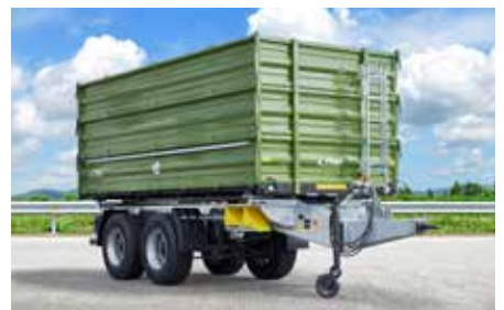
TDK 160 mit Aufbau 1800 mm (3 x 600 mm Bordwand)
