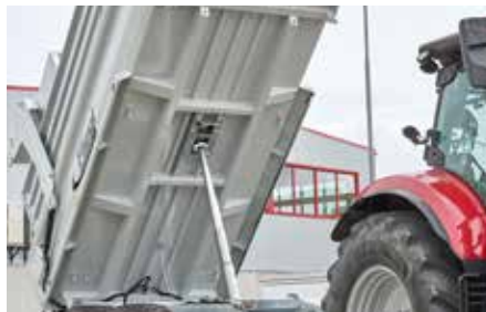
Schwerer Brückenrahmen für extreme Verwindungssteifheit
