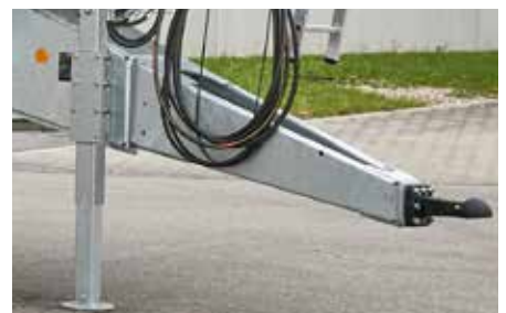
Drehbarer Zugholm für Oben- und Unten- hängung; optional auch gefedert verfügbar
