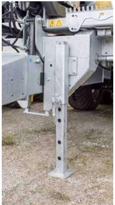
Fallstützfuß (Serie bei allen Fahrzeugen mit hydraulisch gefederten Zugholm)
