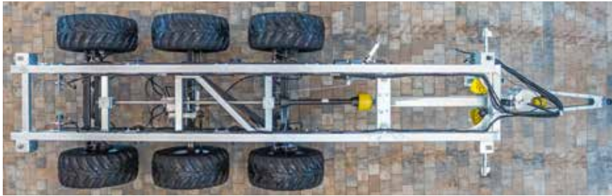
Vorbereitung als Wechselfahrgestell: Als einziges Modell der ASW-Serie bietet der Gigant die Freiheit, das Fahrwerk serienmäßig für unterschiedliche Aufbauten zu nutzen.
