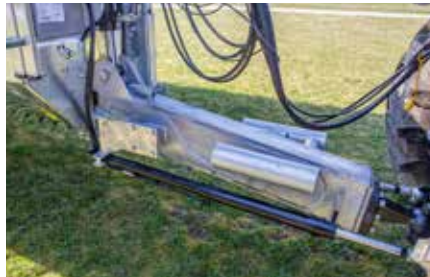
Optional: Hydraulische oder elektronische Zwangslenkung
