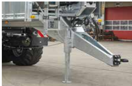
Drehbarer Zugholm für Oben- und Untenanhängung; optional auch gefedert verfügbar
