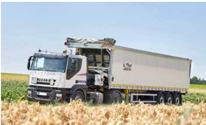
ASS 388 Aluminiumausführung mit Schiebeplane
