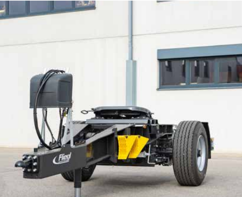
Bordhydraulik mit Gelenkwellenantrieb - optional
