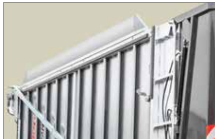
Aluminiumaufbau 300 mm seitlich
