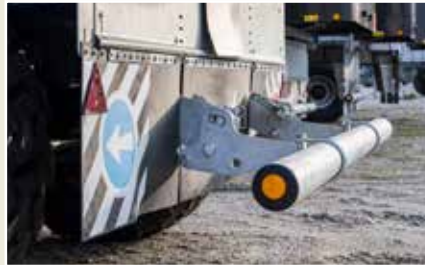
Unterfahrschutz mechanisch klappbar
