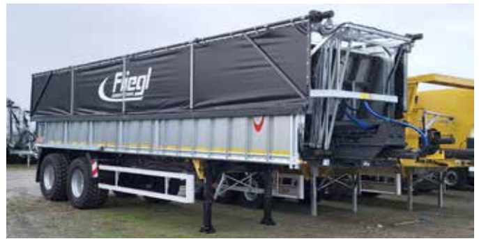
TopLift: Innerhalb kürzester Zeit können die beiden Planenhälften geöffnet und geschlossen werden
