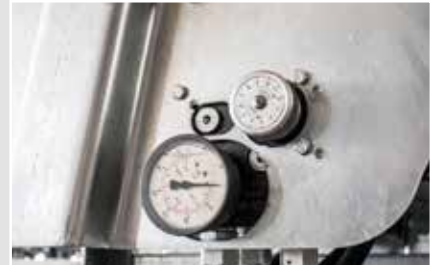
Mechanisches Potentiometer mit einstellbarer Vorschubgeschwindigkeit am Streuwerk
