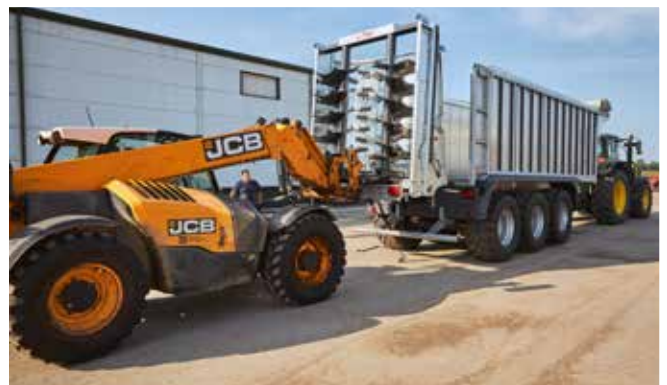
Mit einem Stapler sind alle Streuwerke innerhalb von ca. 20 Minuten einfach montiert.
