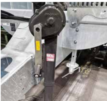
Stützfuß mit zwei Geschwindigkeiten
