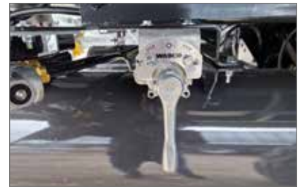
Heben- und Senken-Ventil bei Luftfederung
