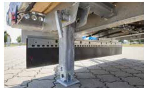
Heckabstützung mit zwei Fallstützen
