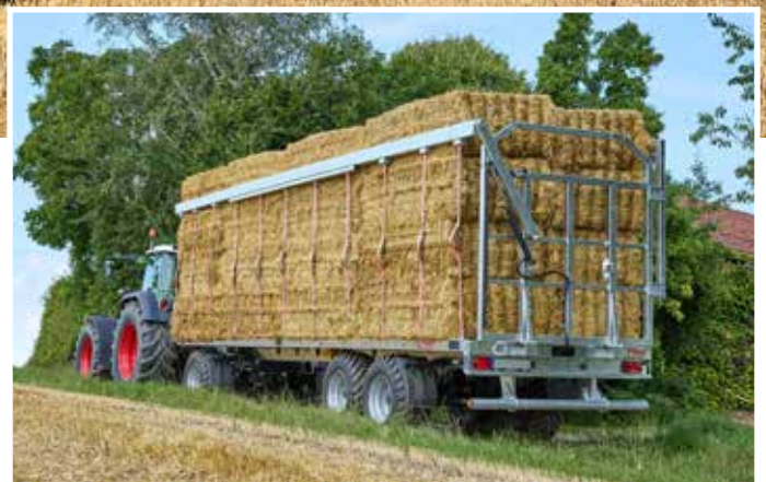
DPW 210 BL Ultra mit Ladungssicherung geschlossen, Öffnung wahlweise rechts oder links möglich.
