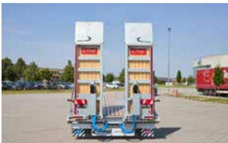
In Serie: Auffahrampen hydraulisch
