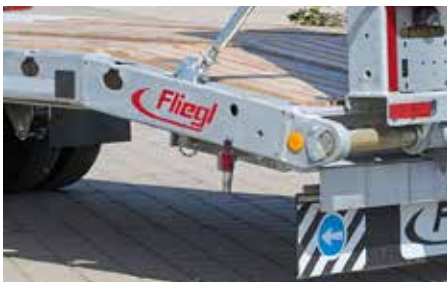
Brücke hinten auf ca. 900 mm abgeschrägt
