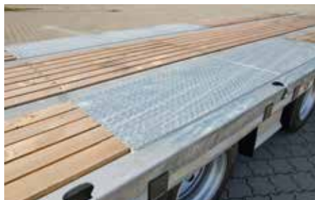
Auffahrampen und Brückenboden aus Weichholz
