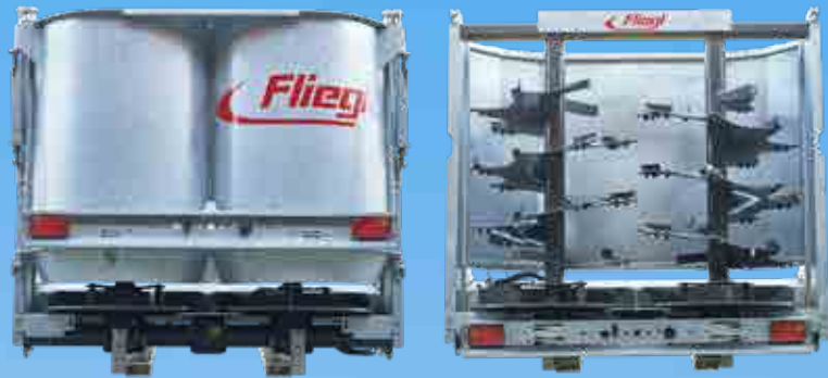
Robustes Streuwerk mit einer Arbeitsbreite von ca. 12 m
