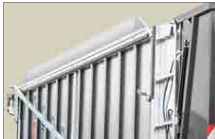
Aluminiumaufbau 300 mm seitlich
