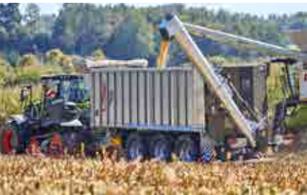
Überladeschnecke ÜLS 400 für Getreide Überladeleistung 7,5 t/min
