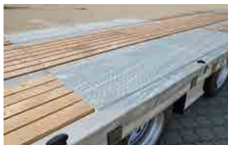
Auffahrampen und Brückenboden aus Weichholz
