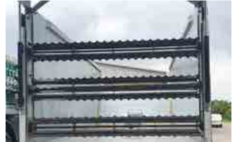
Dosierwalze mit drei liegenden Fräswalzen und automatischer Vorschubregelung
