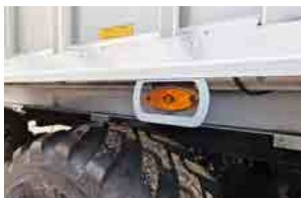
Seitenmarkierungsleuchte; serienmäßig bei COC-Fahrzeugen
