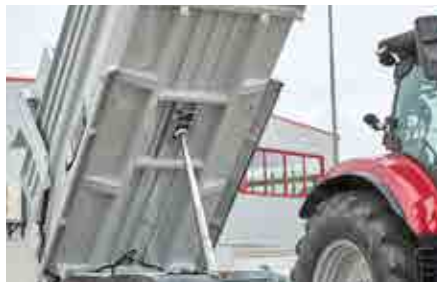
Schwerer Brückenrahmen für extreme Verwindungssteifheit
