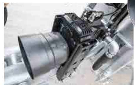
Bordhydraulik für max. Leistung unabhängig vom Zugfahrzeug
