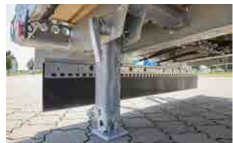
Heckabstützung mit zwei Fallstützen
