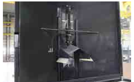
Hydraulischer Stauschieber ermöglicht im beladenem Zustand das komplette Entleeren der Überladeschnecke
