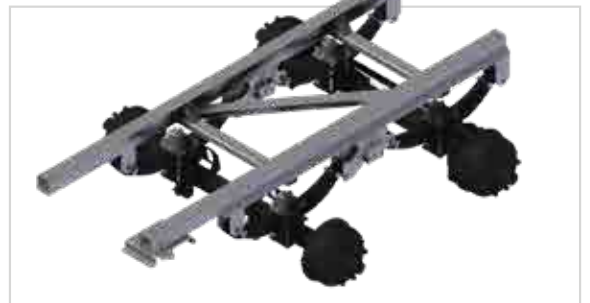
Tandemaggregat "Gigant" – Parabelfederung
