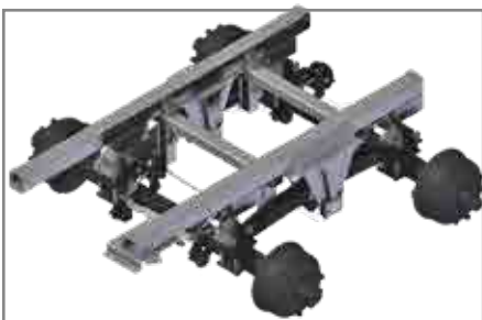
Titan-Tandemaggregat für besten Bodenausgleich
