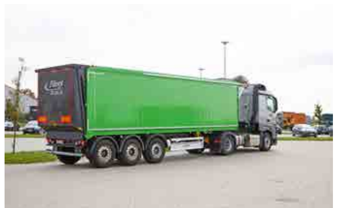
ASS 398 GreenTec mit Seitenwänden aus Aluminium
