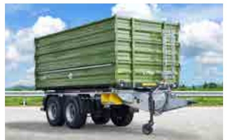
TDK 160 mit Aufbau 1800 mm (3 x 600 mm Bordwand)
