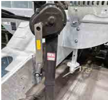
Stützfuß mit zwei Geschwindigkeiten
