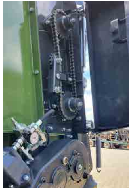
Fräswalzenverbindung über Kette (Fräswalzendurchmesser 560 mm)
