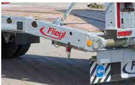
Brücke hinten auf ca. 900 mm abgeschrägt
