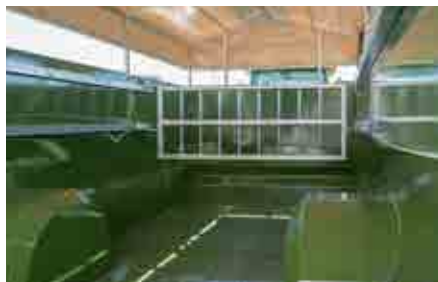
Riffelblech sorgt für einen sicheren Stand der Tiere; optional mit Gummiboden
