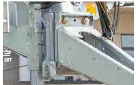
Drehbarer Zugholm für Oben- und Untenan- hängung; optional auch gefedert verfügbar
