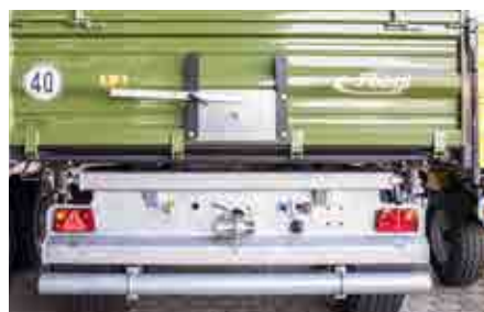
40 km/h Ausführung mit Unterfahrschutz und Kotflügel
