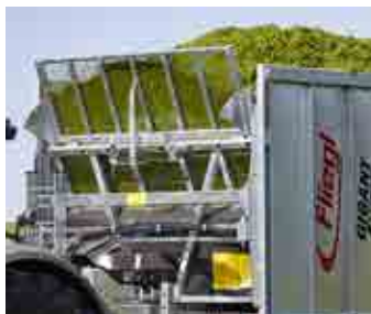
Abschiebesystem mit Sichtfenster „Insight“: Das großflächige Fenster aus schlagfestem Material garantiert Ihnen jederzeit besten Durchblick.
