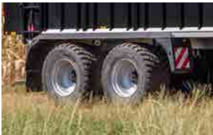
Bereifungsvarianten bis 800/45 R 26.5 oder wahlweise 800/45 R 30.5 (abhängig von Achsabständen)
