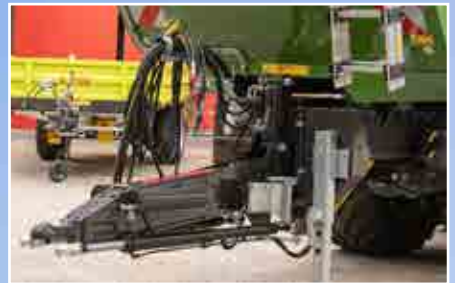
Zugeinrichtung hydraulisch gefedert
