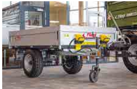
Superleicht: Der EDK 25 mit Aluminium-Bordwänden und Laubaufsatz
