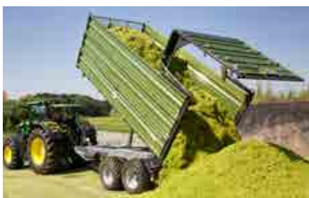
Silierkipper mit hydraulischer Rückwand
