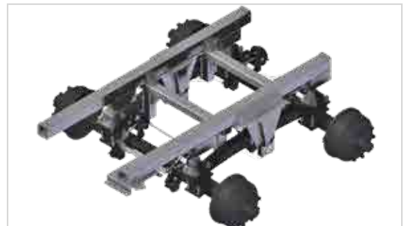
Titan-Tandemaggregat für besten Bodenausgleich, schmierlos und wartungsfrei.
