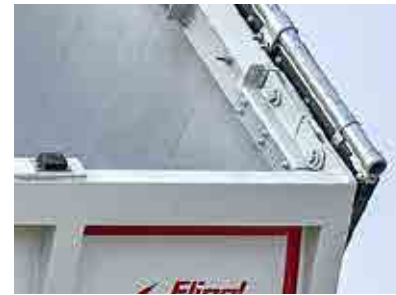
Doppelgelenkscharnier und zweifache Hakenverriegelung
