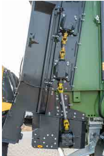
Fräswalzenantrieb über Gelenkwelle (Fräswalzendurchmesser 770 mm)
