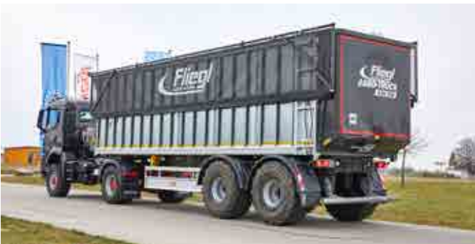
TopLift light: Abdecknetz seitlich klappbar
