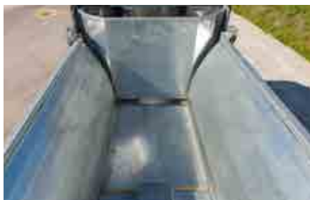
Geringster Verschleiß durch hydraulisches Schiebesystem – kein Kratzboden
