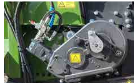
Kratzbodenantrieb Stirnradgetriebe und Hydraulikmotor in Fahrtrichtung links
