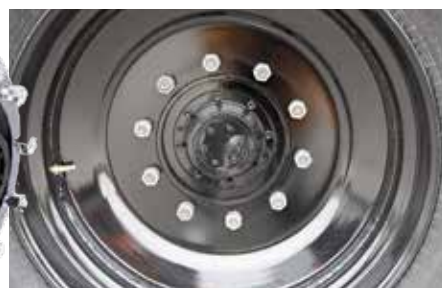
Radialkolbemotoren sørger for ekstra drivkraft ved behov.
