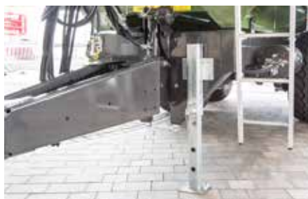
Fra TMK 256 i serie: hydraulisk fjæring på draget og mekanisk støttefor med bolt
