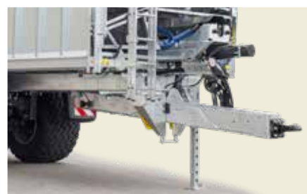
Hydraulisk fjæring gjennomgående for underhengsling
