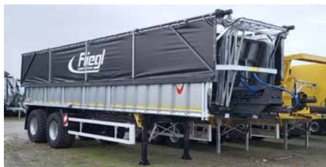
TOPLIFT: Begge presenninghalvdelenes kan åpnes og lukkes på kort tid
