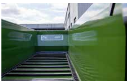
KDS 260: chassis av finkornet stål
