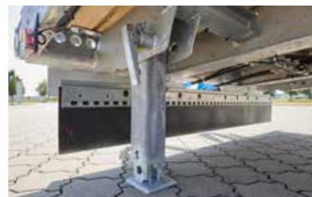
Bakre støtte med 2 fallstøtter
