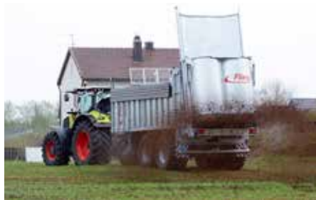
Spredeaggregat «Profi V2» med lukket bredspreaderbakvegg for tørre strømaterialer
