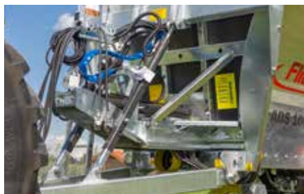
Hydraulisk fjæring av draget, optimal kjørekomfort
