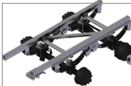
Gigantisk tandemmaggregat (TMK 200 fra 5,65 m skuffelengde)
