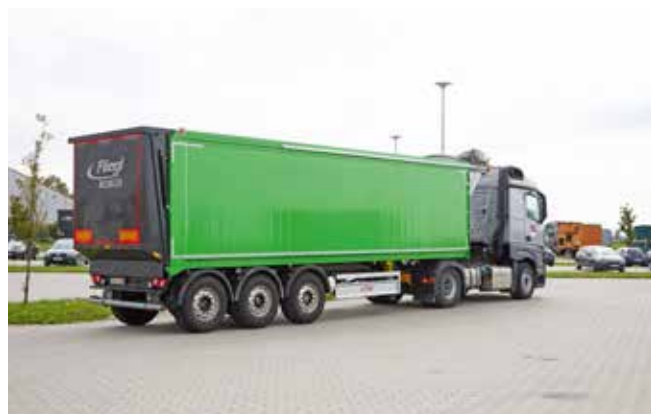
ASS 398 GREEN-TEC med sidevegger i aluminium
