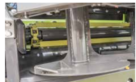
Transportbunnen består av 2 flate trinnkjeder med gjennomgående medbringere
