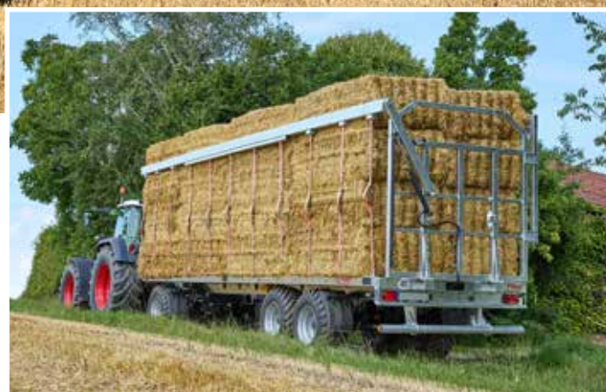
DPW 210 Ultra med lukket lastesikring, åpning valgfritt til høyre eller venstre.
