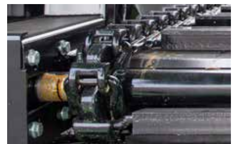
Stjerneformede kjedetannhjul med liten evne til å samle urenheter
