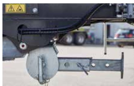
Støttefot justerbar, kan foldes bakover i midten for best mulig stabilitet
