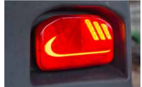
Full-LED baklys «Dynamic» med dynamisk blinkfunksjon av slagfast materiale
