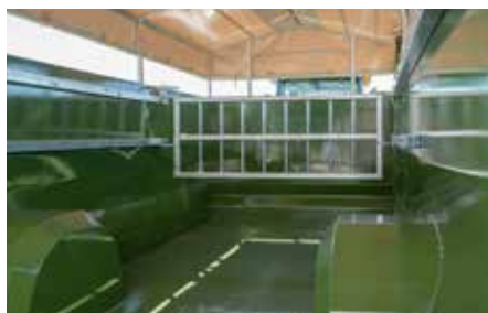
Riffelblech sørger for sikker ståplass for dyrene, valgfritt gummigulv
