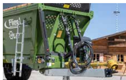
Hydraulisk fjæring av draget. Hengselhøyden kan enkelt justeres.
