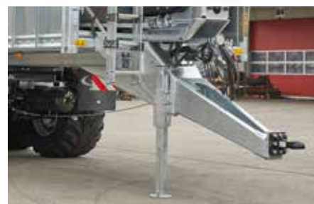
Dragstang uten fjæring, dreibar for opp- og nedhenging
