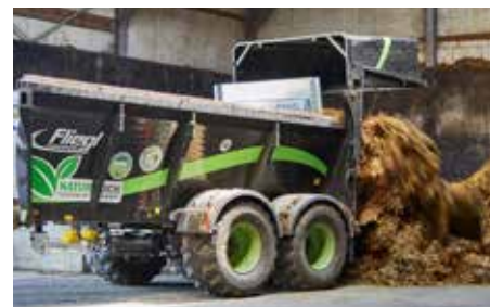
ADS kan som ekstrautstyr ombygges med stor bakvegg på 800 mm og brukes som transporttilhenger (fra ADS 80)
