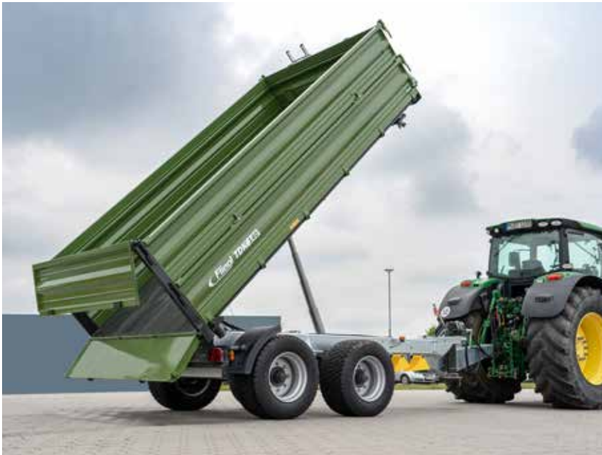
Gruslukek kontroll med hydraulisk bakluke 500 mm.
