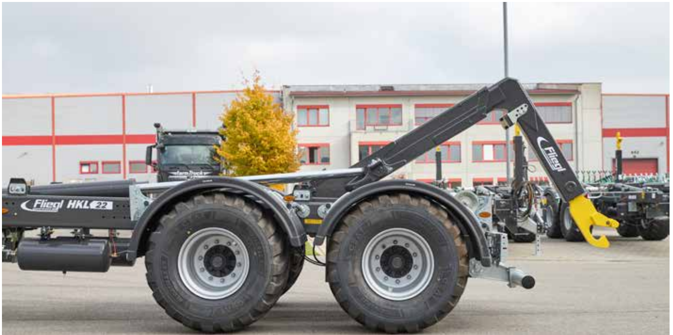
Den spesielle JUMBO-luftfjæringen sikrer lav støttehøyde.
