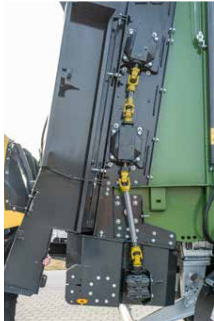
Freserulledrift via kardangakseler
