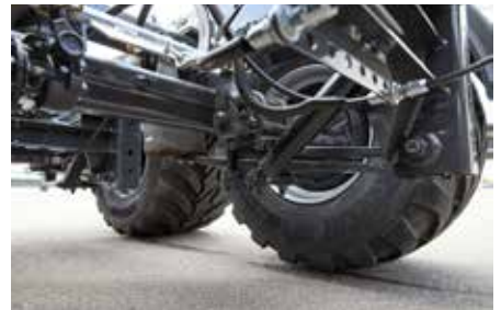
Den spesielle JUMBO-luftfjæringen sikrer lav støttehøyde.
