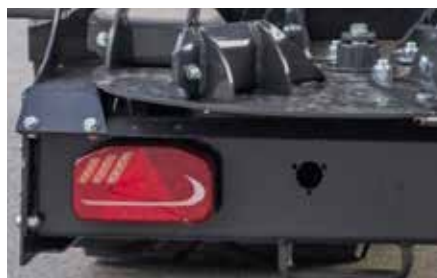
Full-LED baklys «Dynamic» med dynamisk blinklys i slagfast materiale
