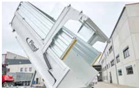
Hydraulisk bakvegg fra TMK 200 S XL Galvanisert, kompakt konstruksjon
