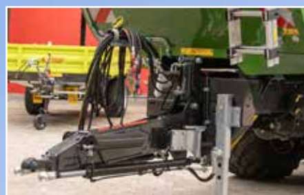
Drag med hydraulisk fjæring
