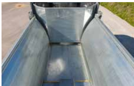
Minimal slitasje takket være hydraulisk avskyversystem – ingen medbringere
