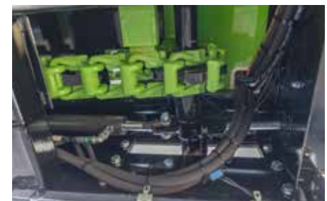
Hydraulisk kjedestramming Valgfritt for tandem og tridem (MuckControl)
