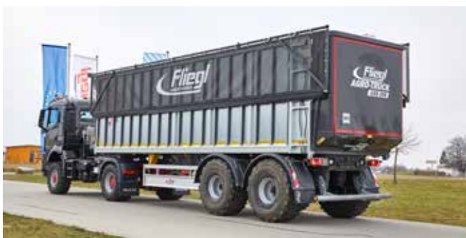
TOPLIFT LIGHT: Dekningsnett som kan foldes til siden
