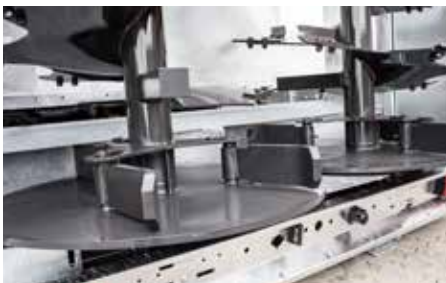
Spreddeaggregat Profi V2 med kastependel:
