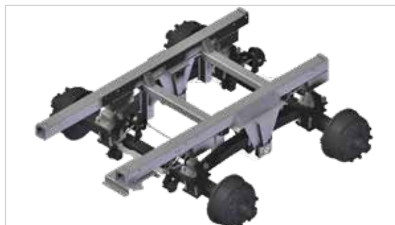
Titan-tandemaggregat for optimal jevnhet, smørefritt og vedlikeholdsfritt.
