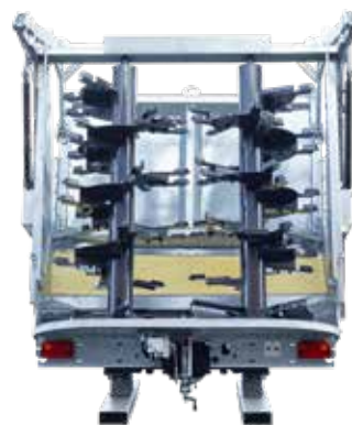
Freseruller med kasteskovler
