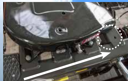
Mekanisk justering av svingskiva for enakslet og tandem-dolly
