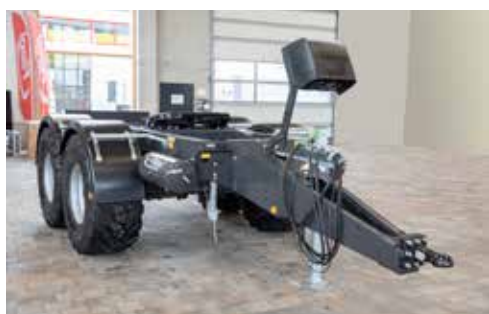
Tandem-Dolly med 17 t påsettlast og 20 t totalvekt
