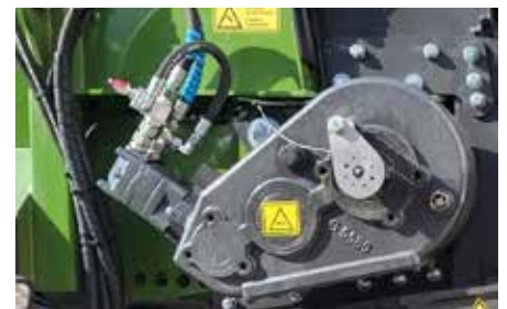
Bunnkjede Tannhjul og hydraulikkmotor i kjøreretningen til venstre
