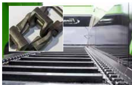
2 utvendige kjettinglenker av V2 kjedeledd med 50 tonn bruddbelastning
