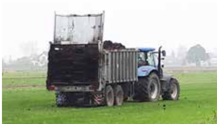
Spredeaggregat «Profi V2n» For avskyvervogn med 1500 mm bakvegg
