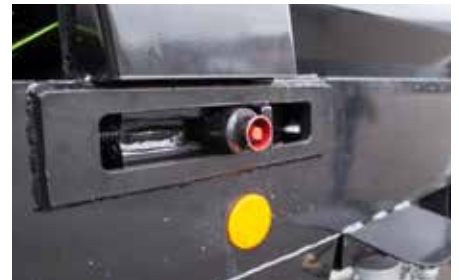
Lett tilgjengelige kjedetannhjul som kan smøres på begge sider gjennom akselen
