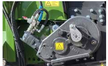
Kratzbodenantrieb Stirnradgetriebe und Hydraulikmotor in Fahrtrichtung links
