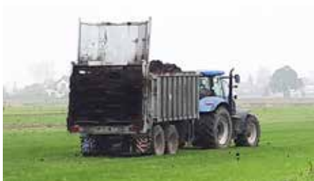
Streuwerk "Profi V2n" für Abschriebewagen mit 1500 mm Muldenhöhe.
