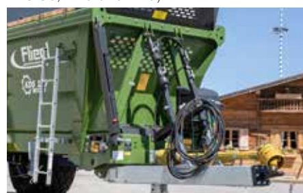
Hydraulisch gefederte Zugdeichsel Die Anhängenhöhe kann bequem eingestellt werden
