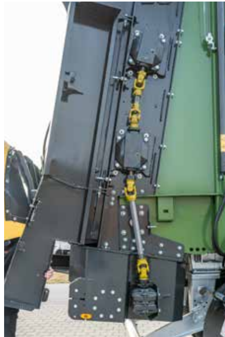
Fräswalzenantrieb über Gelenkwelle (Fräswalzendurchmesser 770 mm)
