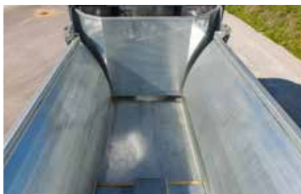
Geringster Verschleiß durch hydraulisches Schiebesystem – kein Kratzboden
