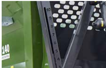
Die Stauschieberöffnungsskala an der Stirnseite zeigt die Öffnungssposition des Stauschiebers an
