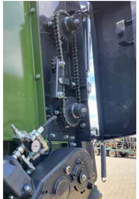
Fräswalzenverbindung über Kette (Fräswalzendurchmesser 560 mm)
