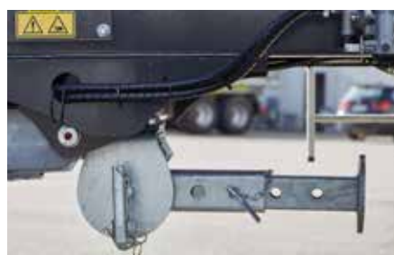
Fallstützfuss Verstellbar mittig nach hinten klappbar für beste Standsicherheit
