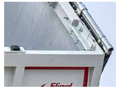
Doppelgelenkscharnier und zweifache Hakenverriegelung
