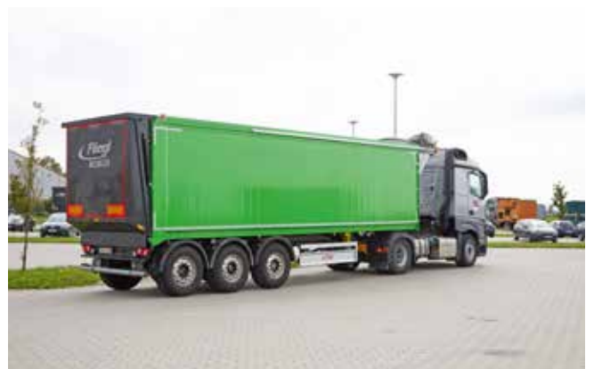
ASS 398 GreenTec mit Seitenwänden aus Aluminium
