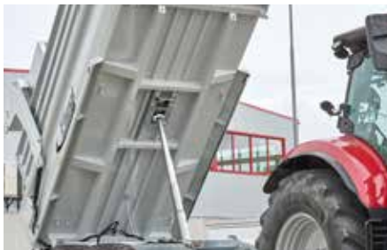
Schwerer Brückenrahmen für extreme Verwindungssteifheit
