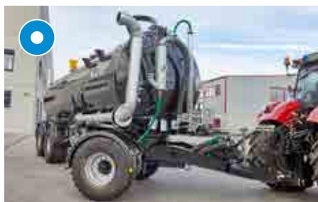
8“ Saugrüssel für komfortables Ansaugen
