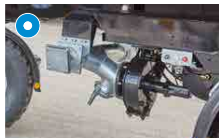
Turbobefüller 8“ für beidseitiges Ansaugen
