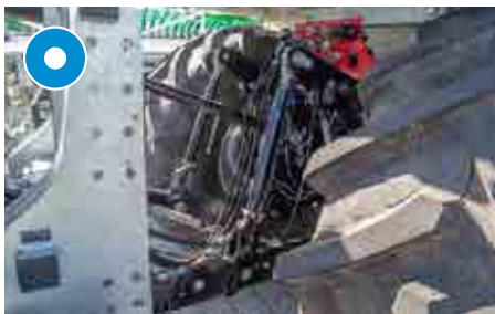
Dreipunkthydraulik wird beim Lenken der Achse mitgeführt
