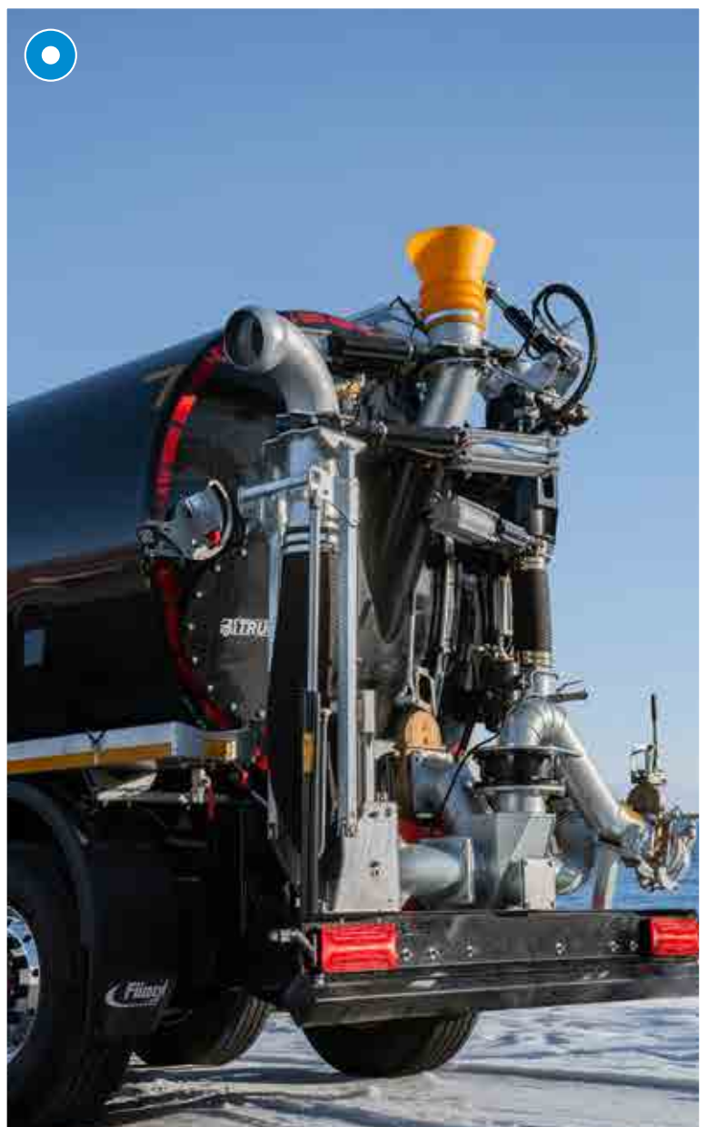
Saugrüssel ansteuerbar über Funkfernbedienung für bequemes ansaugen ohne abzusteigen
