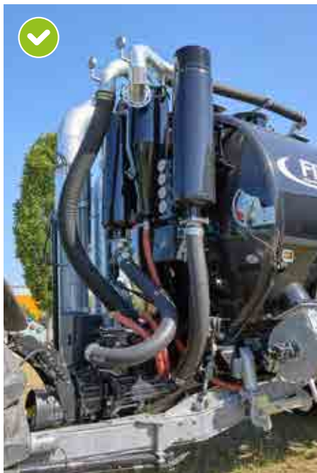
Schaumabscheider; Schalldämpfer mit Ölabscheider
