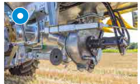
Bei Vakuumfass: Turbobefüller mittig unter dem Fass – für beidseitiges Ansaugen
