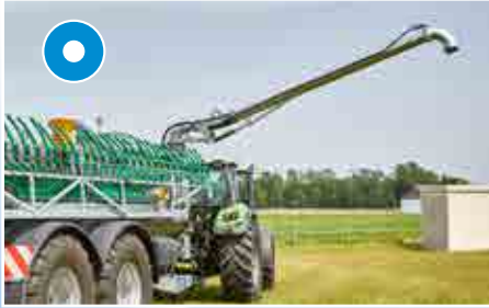
Nur für Pumpfässer: Absaugarm 8“, Länge 5 m
