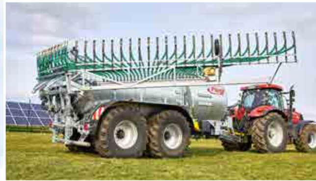
Keine abknickenden Auslaufschläuche durch speziellen Klappmechanismus
