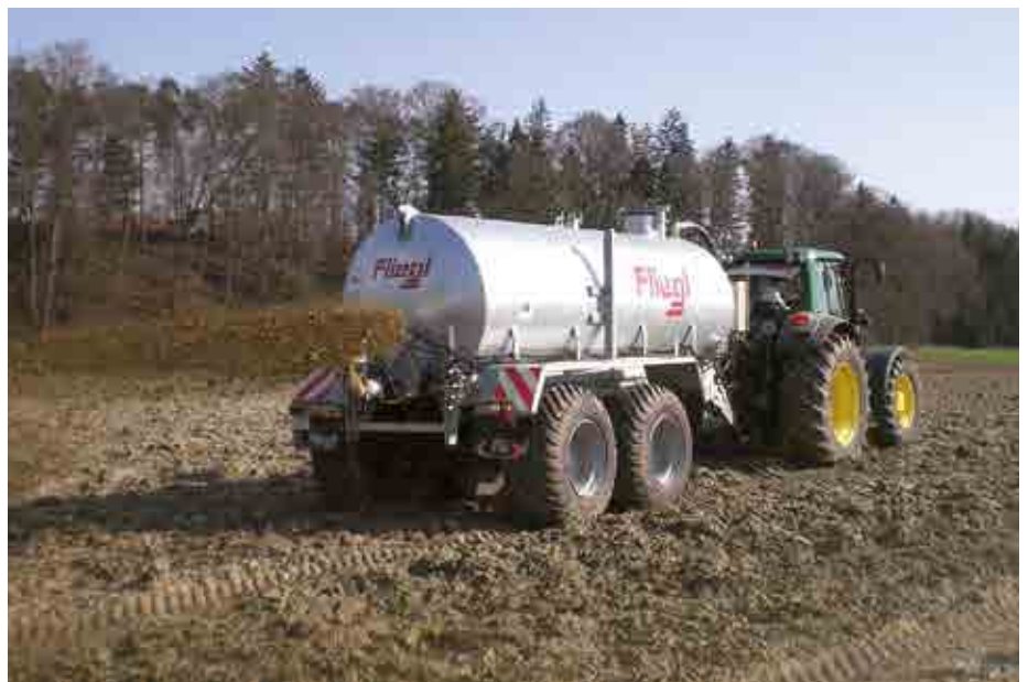
Pendelverteiler für grobtropfiges Ausbringen
