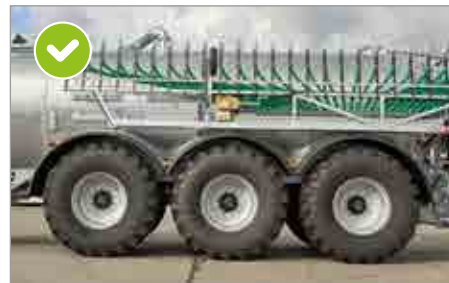
Einzelradausschnitt in Verbindung mit hydraulischer Federung
