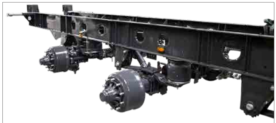
Spezielle Rahmenbauweise aus Feinkornstahl
