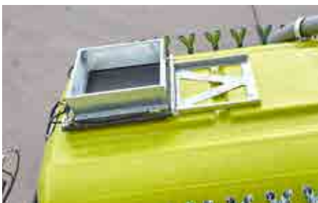
Schubdeckel 600 x 600 mm pneumatisch oder hydraulisch
