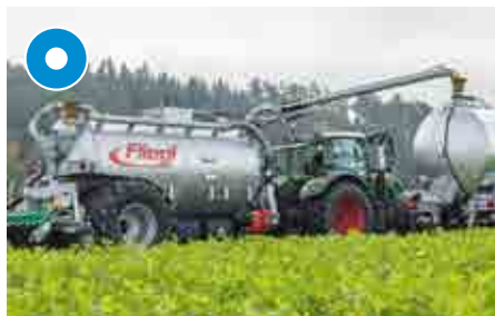
Absaugarm hydraulisch schwenkbar 8“
