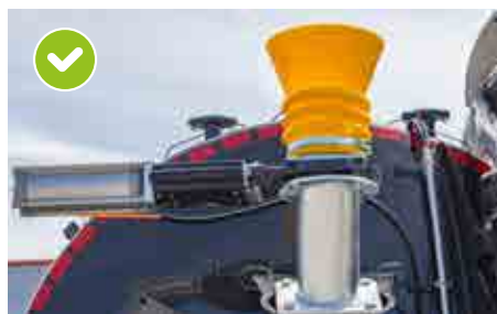
Andocktrichter hinten oben am Fass
