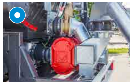
Leistungsstarke Drehkolbenpumpe von Vogelsang VX 186-260 Q mit Nachsaugfunktion zum Leersaugen des Gülleschlauches nach Vollmeldung
