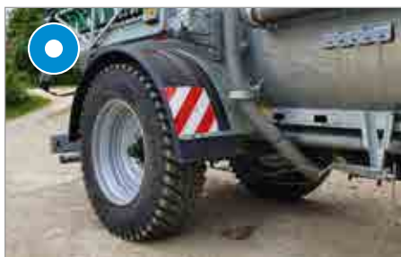
Bereifung für Ausbringung im Maisbestand
