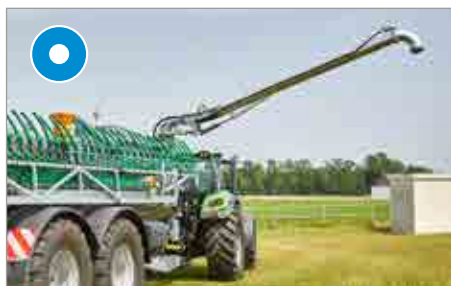
Nur für Pumpfässer: Absaugarm 8", Länge 5 m
