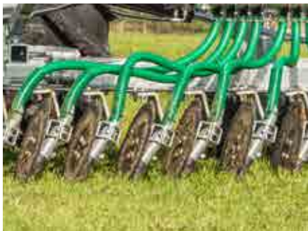
Stufenlose Einstellung der Scheiben
