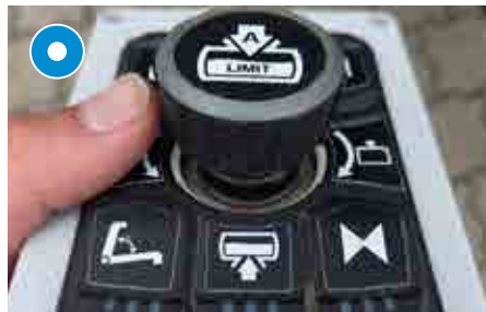
Proportionale Bedienung von Elefant über Joystick
