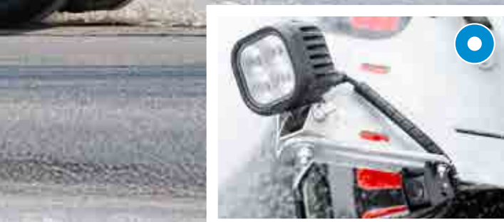
Arbeitsscheinwerfer und Kamera für optimale Sichtverhältnisse beim Saugen mit dem 8-Zoll-Saugarm
