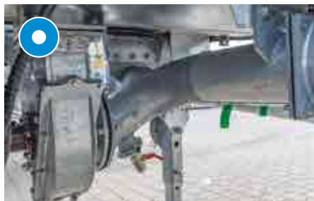
Turbobefüller hydraulisch, mittig unter dem Fass
