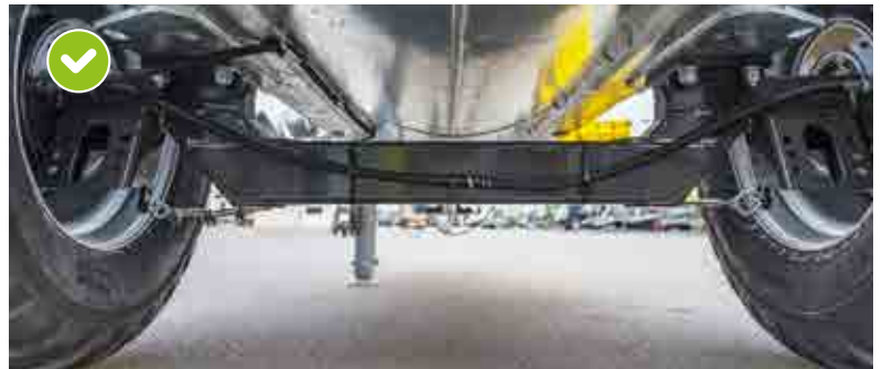
Gekröpfte Achse bei 5000 - 7500 Liter JUMBO Line (abhängig vom zulässigen Gesamtgewicht); der niedriger Schwerpunkt sorgt für optimales Fahrverhalten am Hang
