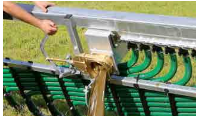
Staukasten für Fremdkörper, mechanische oder hydraulische Entleerung
