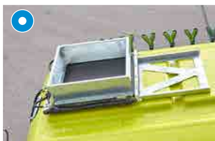
Schubdeckel 600 x 600 mm pneumatisch oder hydraulisch
