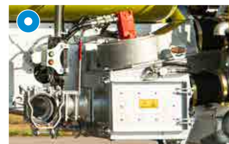
Schneidcutter inklusive Fremdkörperabscheider – ideal für Gülle mit extrem hohem Faser- oder Fremdkörperanteil
