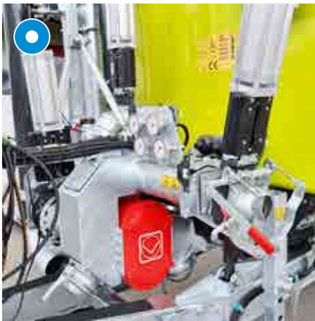
Drehkolbenpumpe "POLYFANT" mit hoher Wartungsfreundlichkeit
