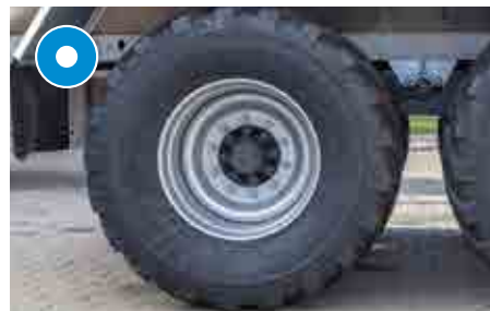
Bereifung bis max. 26.5" möglich
