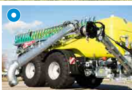
Doppelgelenkter 8" Saugrüssel "Elefant" mit einer Saugtiefe von mind. 3 Metern
