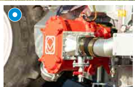
Für eine hohe Förderleistung sorgt die mechanisch angetriebene Vogelsang-Drehkolbenpumpe unterstützt durch den leistungsstarken Turbobefüller Pro Fill von Agrar Pro (BIG FOOT POLY Line auch mit Exzenter-schneckenpumpe verfügbar, nur ohne "Elefant" möglich)
