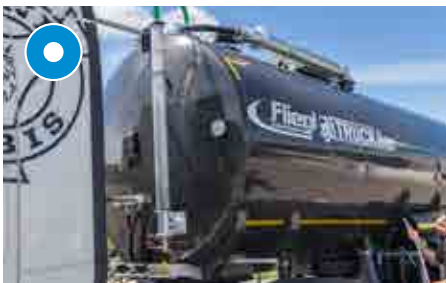
Zusätzliche Füllstandanzeige durch Plexiglasrohr
