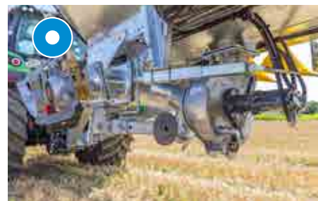
Turbobefüller mittig unter dem Fass – für beidseitiges Ansaugen
