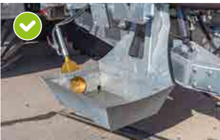
Oppsamlingskar for Transfill-sugearm med automatisk tømning på åkeren
