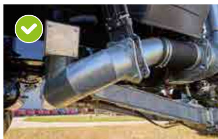
Bypass-system for turbofyllingsanordning med 2 x 10 tommer trykker, oppsuging og utpressing av gjødsl via sugearm Elefant er mulig
