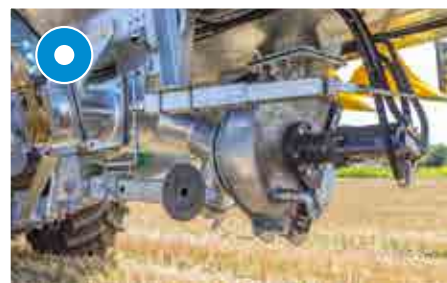
Ved vakumtank: Turbofyllingsanordning midt under tanken – for lasting på begge sider
