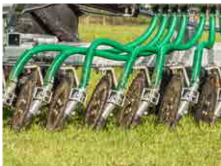
Trinnløs innstilling av skjivene
