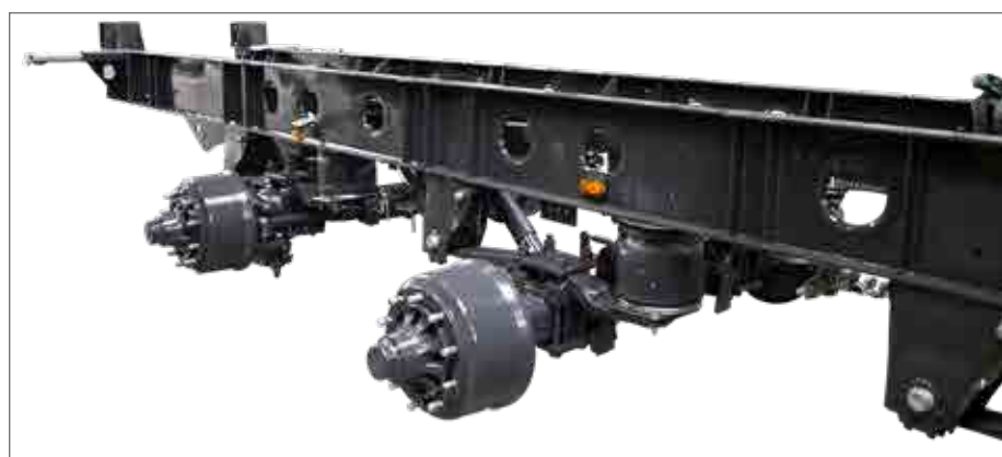
Spesiell rammekonstruksjon av finkornet stål
