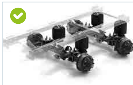
Luftfjæring Valgfritt: Hydraulisk fjæring
