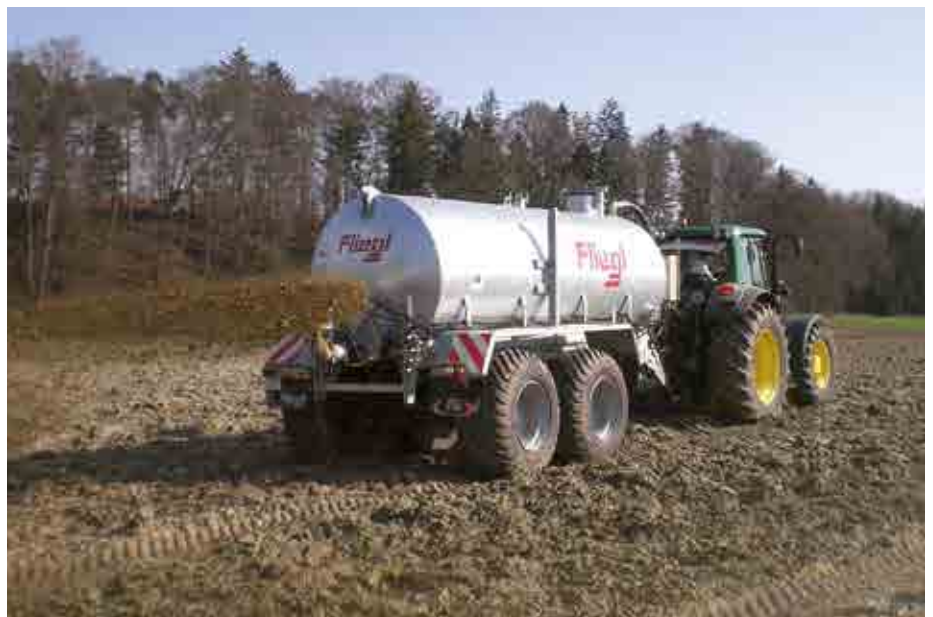
Pendelsprederr for grovdråpig spredning
