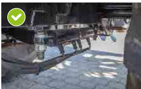
Sentralmontert aksel, hydraulisk styring for kjøring i hundegang
