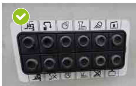
Styring via ekstern betjening (kun i kombinasjon med dreiestempelpumpe)
