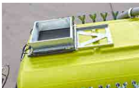
Skyvelokk 600 x 600 mm pneumatisk eller hydraulisk
