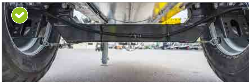
Krummet aksel ved 5000–8600 liter Lavt tyngdepunkt sikrer optimal kjøreegenskaper i bakker
