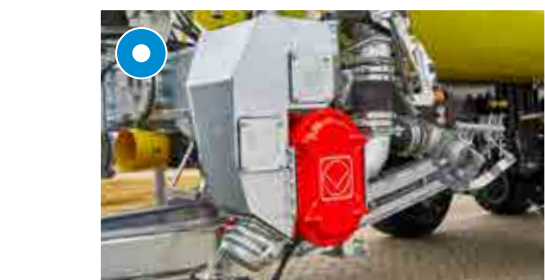
Dreiestempelpumpe mekanisk inkl. reduksjonsgir og lavt vedlikeholdsbehov
