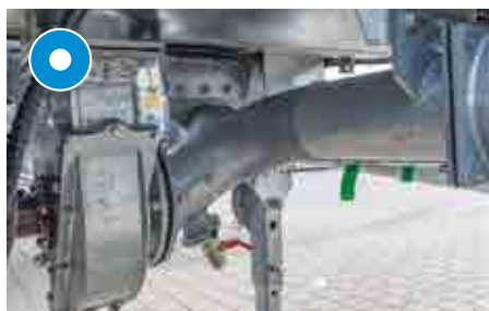
Hydraulisk turbo-fyllingsanordning, sentrert under tanken
