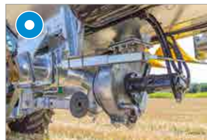
Ved vakumtank: Turbofyllingsanordning midt under tanken – for lasting på begge sider
