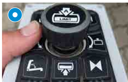
Proposjonal betjening av Elefant via joystick
