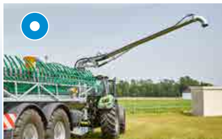
Kun for pumpetanker: Sugearm 8", lengde 5 m
