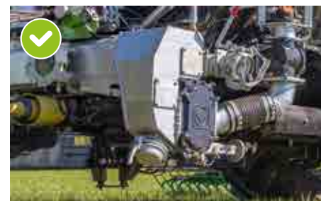
Svært vedlikeholdsvennlig: Mekanisk drevet roterende stempelpumpe inkl. reduksjonsgir
