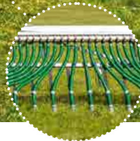
Jevn fordelingskvalitet takket være korte utløpsslanger
