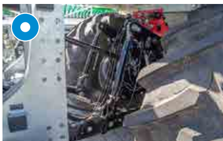
Trepunktshydraulikken følger med når akslen styres
