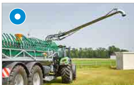
Kun for pumpetanker: Sugearm 8", lengde 5 m
