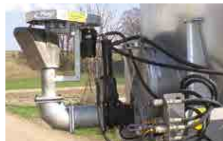
Hydraulisk pendelspreder med en arbeidsbredde på 12 til 18 m.
