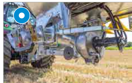
Ved vakumtankvogn: Turbofyllingsanordning midt under tanken – for suging fra begge sider
