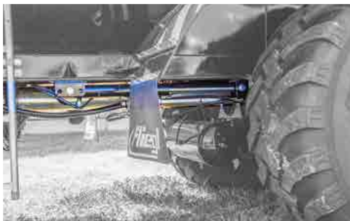
Hydraulisk forskyvning av akslene
