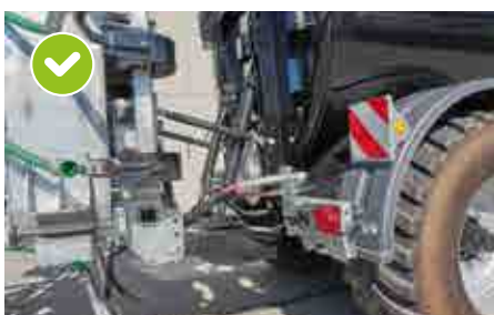
Firepunktshydraulikk Løftekraft ca. 6 tonn
