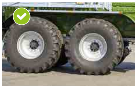
Hjulutskjæring og dekk Dekk 750/60-R30,5"
