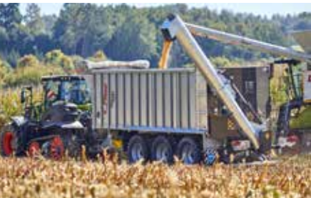
Überladeschnecke ÜLS 400 für Getreide Überladeleistung 7,5 t/min
