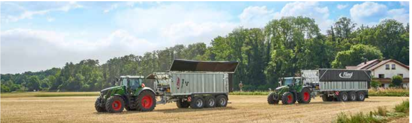
TopLift: Innerhalb kürzester Zeit können die beiden Planenhälften geöffnet und geschlossen werden
