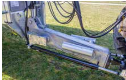
Optional: Hydraulische oder elektronische Zwangslenkung
