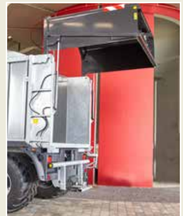
Unterfahrschutz hydraulisch klappbar: Beim Öffnen der Großraumrückwand klappt der Unterfahrschutz automatisch nach oben bzw. beim Schließen nach unten
