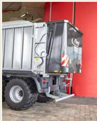
Unterfahrschutz hydraulisch klappbar: Beim Öffnen der Großraumrückwand klappt der Unterfahrschutz automatisch nach oben bzw. beim Schließen nach unten
