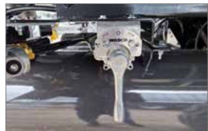
Heben- und Senken-Ventil bei Luftfederung
