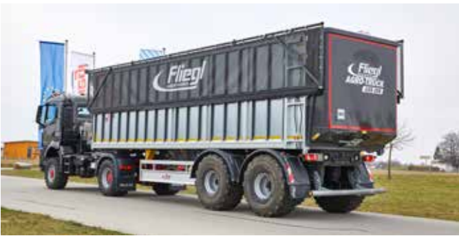
TopLift light: Abdecknetz seitlich klappbar
