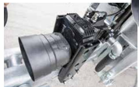
Bordhydraulik für max. Leistung unabhängig vom Zugfahrzeug
