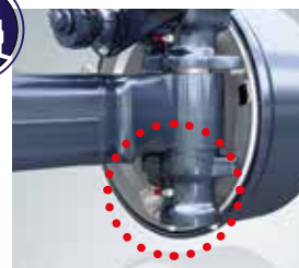
BPW-Achse in zentrierter Position
