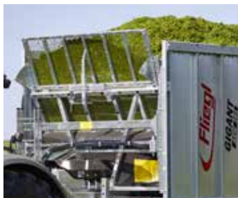
Abschiebesystem mit Sichtfenster „Insight“: Das großflächige Fenster aus schlagfestem Material garantiert Ihnen jederzeit besten Durchblick.
