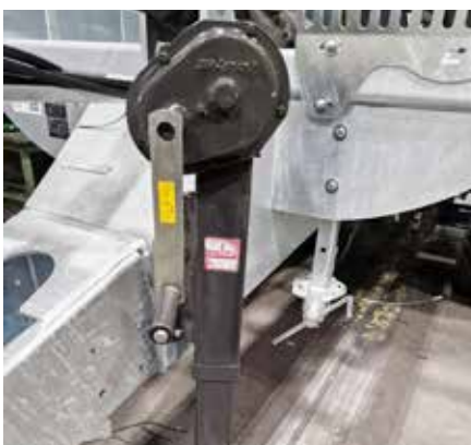
Stützfuß mit zwei Geschwindigkeiten
