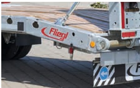
Brücke hinten auf ca. 900 mm abgeschrägt
