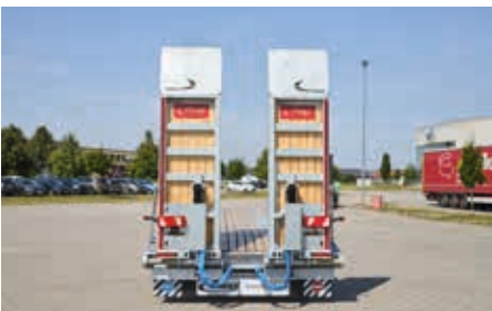
In Serie: Auffahrampen hydraulisch
