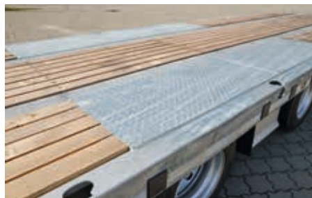
Auffahrampen und Brückenboden aus Weichholz
