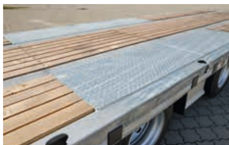
Rampes d'accès et plancher de pont en bois tendre
