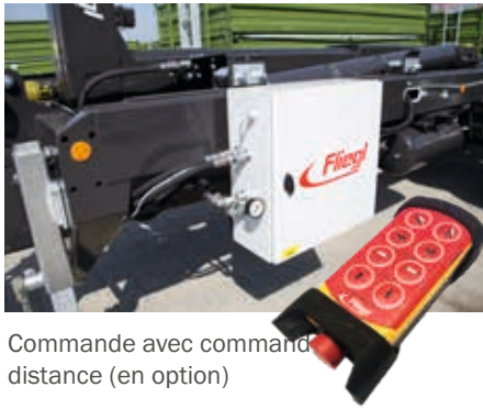
Suspension de timon hydraulique
