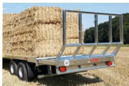
Grille à balles de série avec le type DPW 180 B. En option : expulsion arrière (1200 mm)
