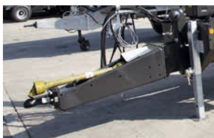
Barre de traction rotative pour attelage supérieur ou inférieur
