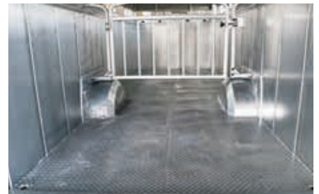
Grille de séparation réglable et fond en tôle gauffrée avec ouverture d'évacuation
