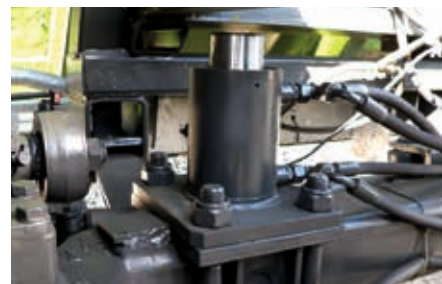
En option : support hydraulique sur l'essieu
