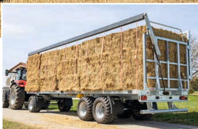
DPW 210 Ultra avec sécurisation de la charge fermée, ouverture possible à droite ou à gauche au choix.
