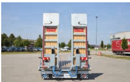
De série : Rampes d'accès hydrauliques
