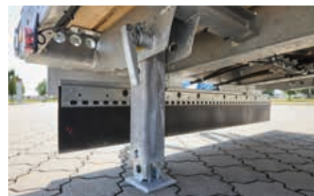
Zadní podpěra se 2 sklopnými podpěrami
