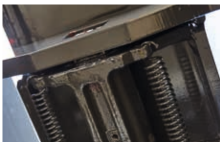
Automatické zajištění háku během sklápění
