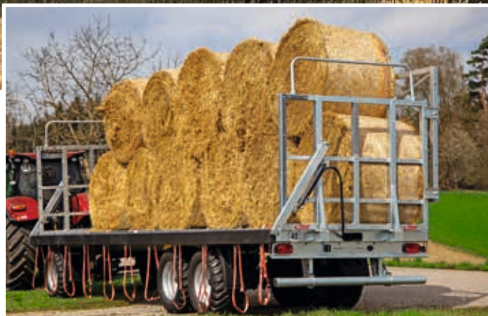
DPW 210 Ultra se zajištěním nákladu otevřeným
