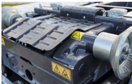
Velké výstupní válce z ocelolitiný (Ø 310 mm) s velkou středovou tyčí usnadňují natažení kontejnerů.
