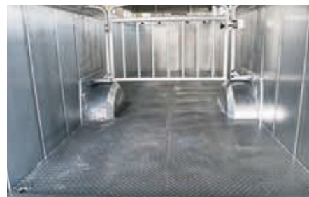
Slzičkový plech zajišťuje bezpečné stání zvířat
