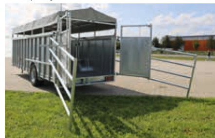
Zábradlí k manipulaci se zvířaty
