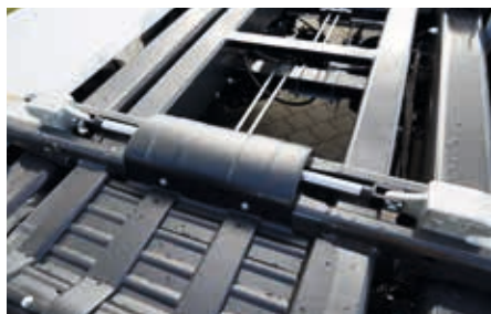
Systém zajištění se zásuvnými zámky pro zajištění zevnitř i zvenku
