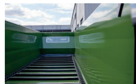
KDS 260: кузов из высокопрочной мелкозернистой стали
