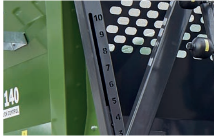
Шкала открытия заслонки на передней стороне показывает позицию открытия заслонки.
