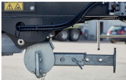
Опорная стойка Центрально регулируемая и складывающаяся назад для лучшей устойчивости.
