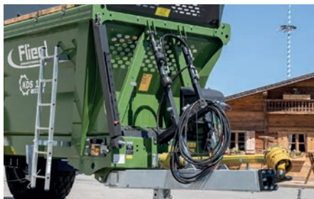
Гидравлически амортизированное дышло. Высота сцепки может быть удобно отрегулирована.
