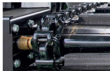
Звездообразные зубцы с низкой вероятностью загрязнения
