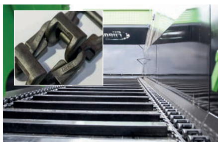
2 цепи внешнего крепления из V2 Звенья цепи с разрывной нагрузкой 50 тонн
