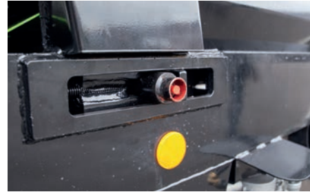
Удобно доступные и смазываемые с обеих сторон через вал звездочки цепи.
