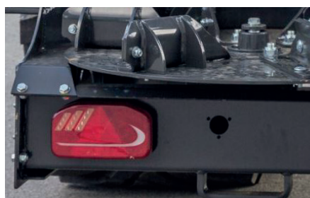
Полностью светодиодные задние фонари „Dynamic“ с динамическими поворотниками, выполненные из ударопрочного материала.
