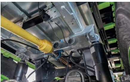
Для KDS Tandem и Tridem: Защита ходовой части (от навоза).
