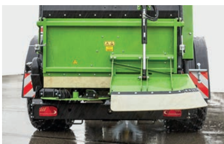
Ограничитель для разбрасывания по краю поля. Доступно для установки слева, справа или с обеих сторон
