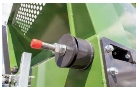
Натяжение цепи Достаточное и равномерное натяжение цепи — это основное условие для надежной транспортировки материала. Элементы натяжения расположены на передней части кузова.
