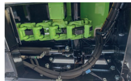
Гидравлическое натяжение цепи (опционально для Tandem и Tridem, MuckControl).
