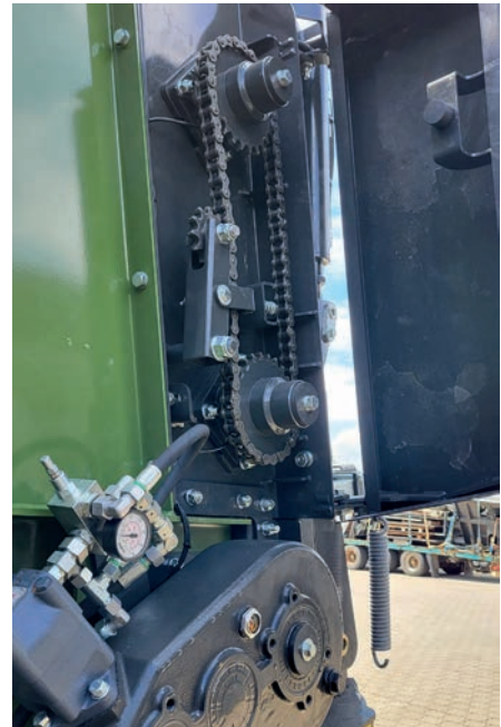
Соединение фрезерных валов через цепь (KDS 255).
