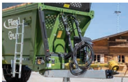
Timon de traction à suspension hydraulique pour épandeur Tiefbett/attelage bas. La hauteur d'attelage peut être réglée aisément.
