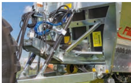
Suspension de timon hydraulique, meilleur confort de conduite
