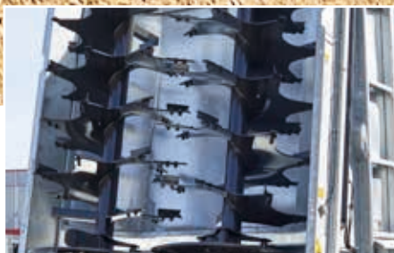
Les rouleaux fraiseurs broient le produit à désiler et garantissent un matériau homogène.
