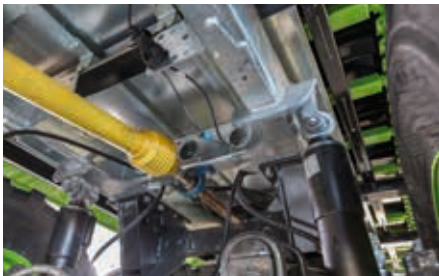
Pour KDS tandem et tridem : protection du châssis (contre le fumier)
