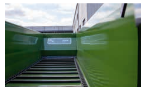
KDS 260: benne en acier à grain fin
