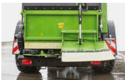
Dispositif d'épandage en bordure Disponible pour montage individuel à gauche/droite ou des deux côtés.
