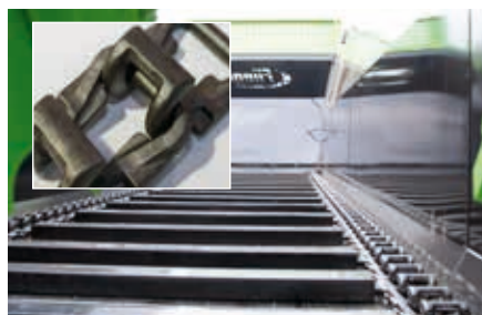
2 chaînes externes composées de maillons en acier inoxydable V2 avec une charge de rupture de 50 tonnes.
