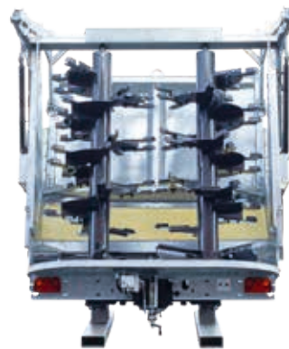
Rouleaux fraiseurs avec pales d'éjection
