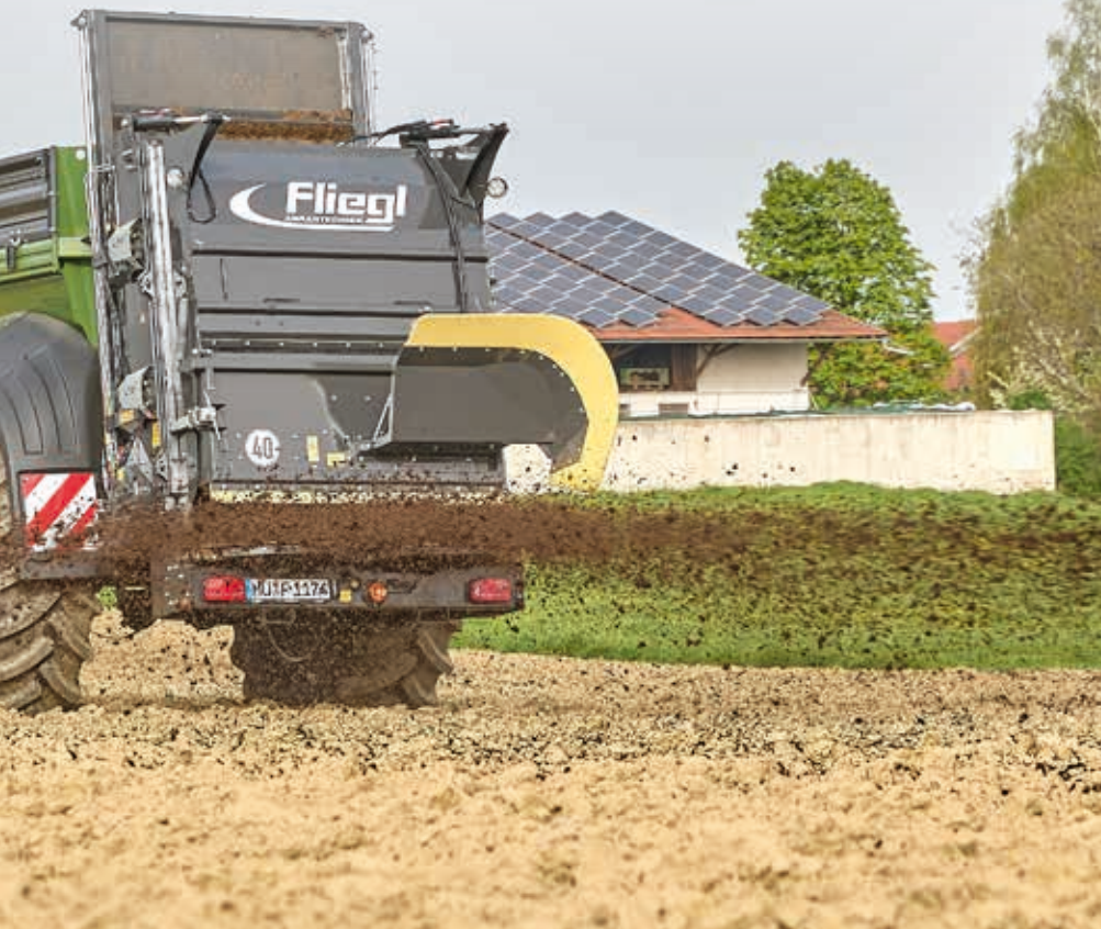
Trappe arrière hydraulique
