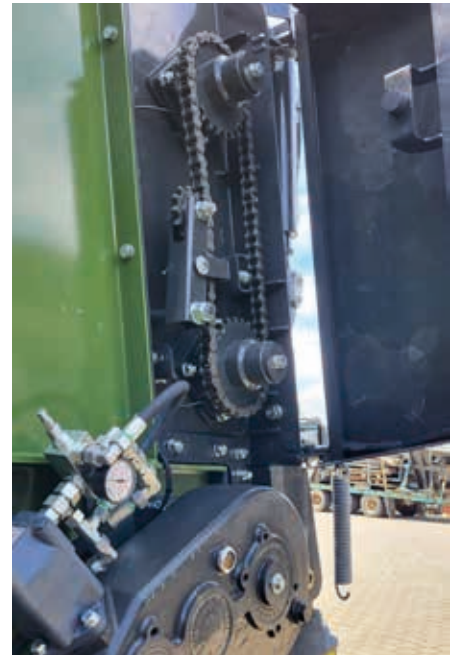
Connexion du rouleau de fraisage par chaîne (KDS 255)
