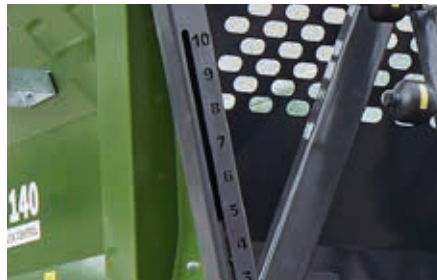
L'échelle d'ouverture de la porte guillotine à l'avant indique la position d'ouverture de la porte guillotine
