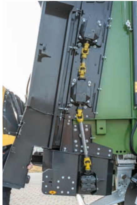
Entraînement du rouleau de fraisage via un arbre à cardan
