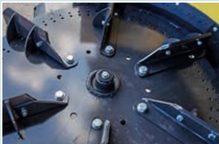
Ajustement des pales d'éjection
