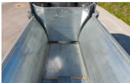
Très faible usure grâce au système de poussée hydraulique – pas de fond racleur.
