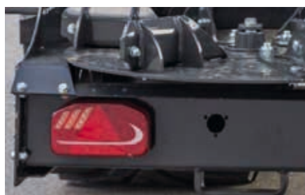
Feu arrière à LED « Dynamic » avec clignotant dynamique en matériau résistant aux chocs
