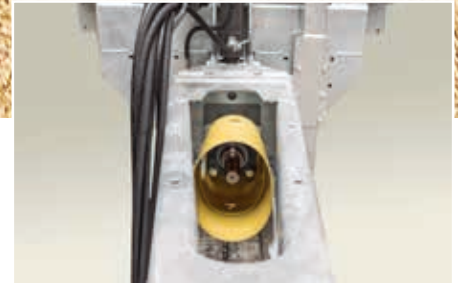
L'épandeur est entraîné mécaniquement par un entraînement par prise de force
