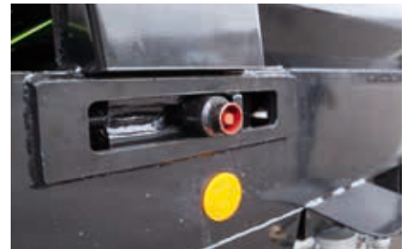
Pignons facilement accessibles et lubrifiables par l'arbre des deux côtés
