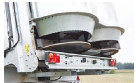
Rouleaux fraiseurs avec balanciers
