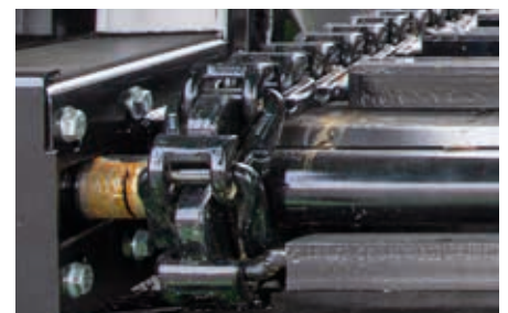
Pignons en étoile réduisant la sensibilité aux salissures.
