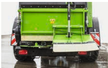
Hraniční rozmetací zařízení Dostupné jako samostatná montáž vlevo nebo vpravo nebo i na obou stranách.
