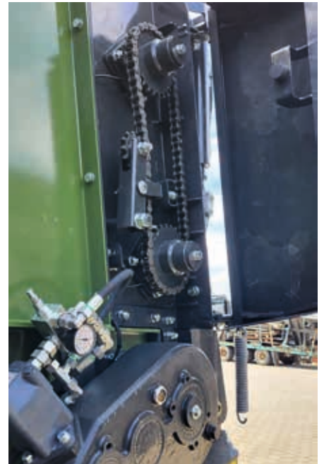
Propojení frézovacích válců pomocí řetězu (KDS 255)
