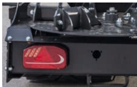
Kompletní LED zadní světla „Dynamic“ s dynamickým ukazatelem změny směru jízdy z odolného materiálu
