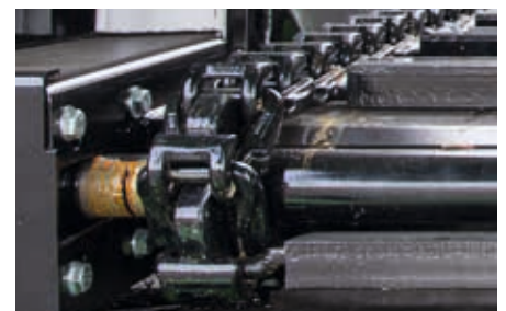
Hvězdicová řetězová kola s nízkou náchylností k znečištění.
