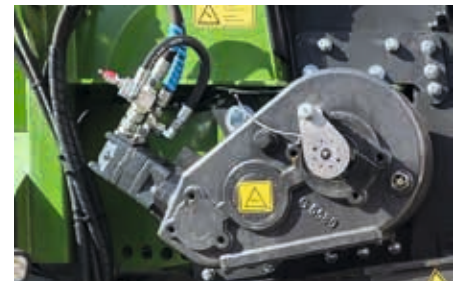
Pohon škrabkového dna Čelní převodovka a hydraulický motor umístěné na levé straně ve směru jízdy.
