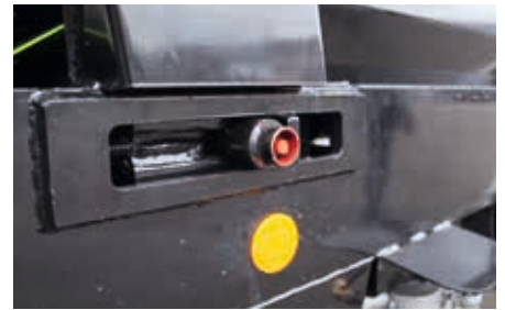
Pohodlně přístupná řetězová kola oboustranně mazaná z hřídele
