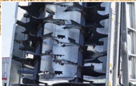
Svislé rozmetací válce frézují materiál a zajistí jeho homogenitu
