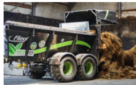
System ADS lze volitelně vybavit velkoobjemovou zadní stěnou 800 mm a využít jej jako přepravní návěs
