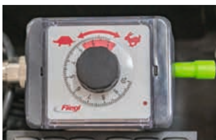
Elektrický potenciometr s nastavením rychlosti posuvu na ovládacím panelu.
