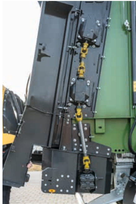
Pohon frézovacích válců přes kloubový hřídel
