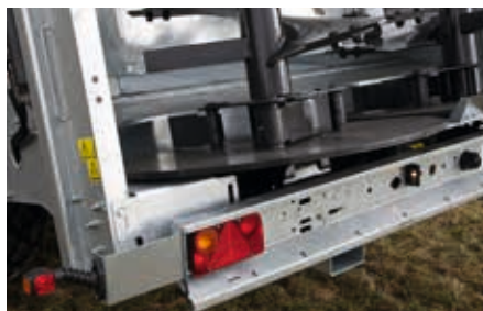
Lehké provedení: liníkové bočnice
