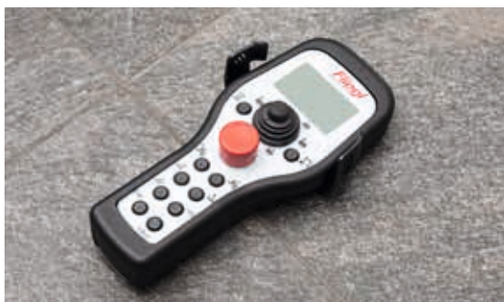
Ovládání: pomocí rádiového dálkového ovládání.
