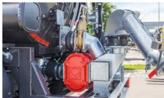
Výkonné rotační pístové čerpadlo Vogelsang VX 186-260 Q s funkcí dosávání pro úplné vyprázdnění hadice na kejdě po jejím naplnění.
