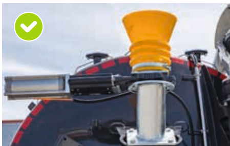
Skladovací nálevka vzadu nahoře na cisterně
