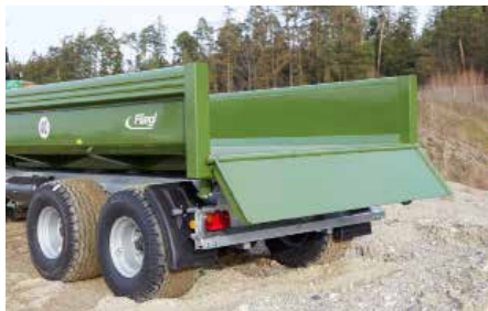
Schotterklappe bei TMK 130 S und TMK 200 S
