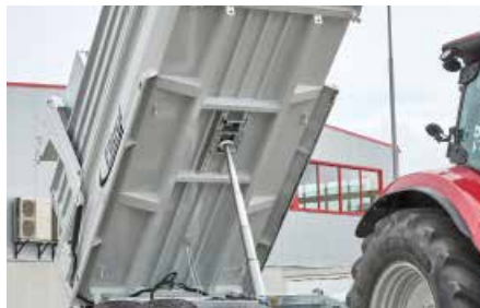
Schwerer Brückenrahmen für extreme Verwindungssteifheit
