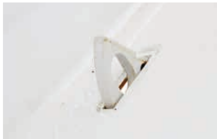
3 paires d'anneaux d'arrimage encastés dans le plancher du pont (disponibles pour les modèles TMK 130 S à TMK 200 S XL).
