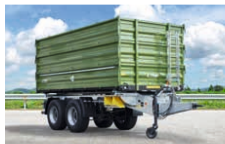
TDK 160 avec module 1800 mm (3 ridelles de 600 mm)
