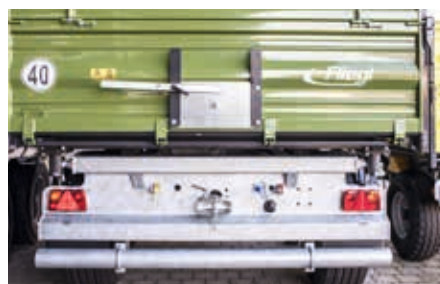
Version 40 km/h avec protection anti-encastrément et garde-boue
