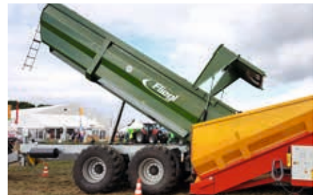
Langer Überhang bei TMK Potato zum Befüllen von Bunker
