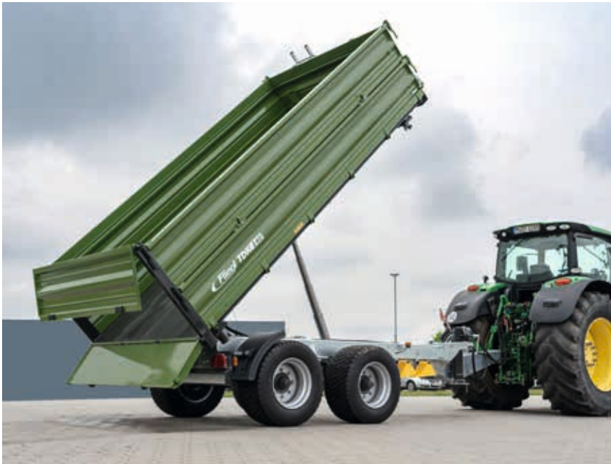
TDK 160 avec volet hydr. pour gravier 500 mm Pont : 5000 x 2320 x 2220 mm
