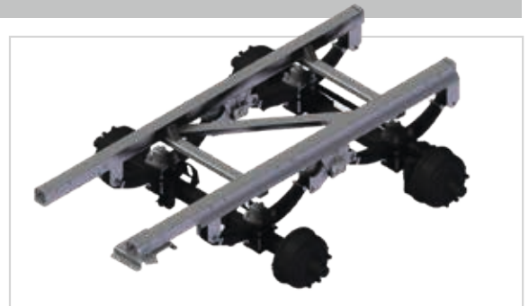
Tandemaggregat Gigant - Parabelfederung
