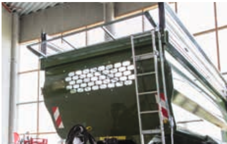
Grille de protection rabattable mécaniquement
