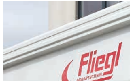
Profils de renfort pliés et arrondis en une seule pièce.
