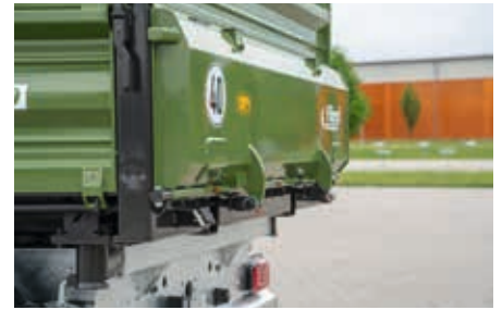
robuste klappe mit 2-Zylinder Ausführung
