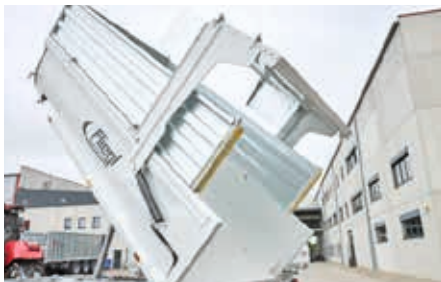
Porte arrière hydraulique à partir du modèle TMK 200 S XL. Structure galvanisée repliable.
