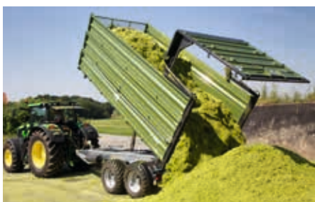
Benne d'ensilage avec paroi arrière hydraulique
