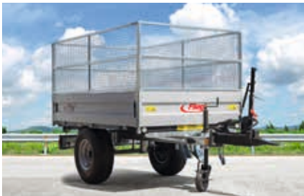
L'EDK 25 avec parois latérales en aluminium et fixation de vantail
