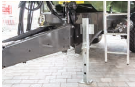
De série à partir du modèle TMK 256 : Suspension de timon hydraulique et béquille de sécurité mécanique
