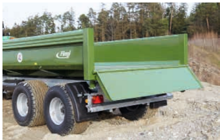
Trappe à gravats sur les modèles TMK 130 S et TMK 200 S.
