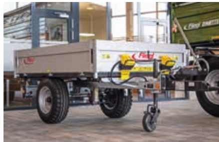
L'EDK 25 avec parois latérales en aluminium et fixation de vantail
