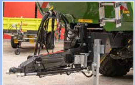
Hydraulicky odpružené závěsné zařízení.
