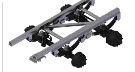
Tandemový agregát Gigant – listové pružiny
