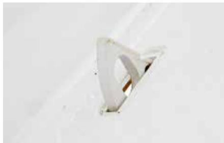
3 páry upevňovacích ok zapuštěných do podlahy korby (u modelů TMK 130 S až TMK 200 S XL).
