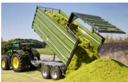
Silážní sklápěč s hydraulickou zadní stěnou
