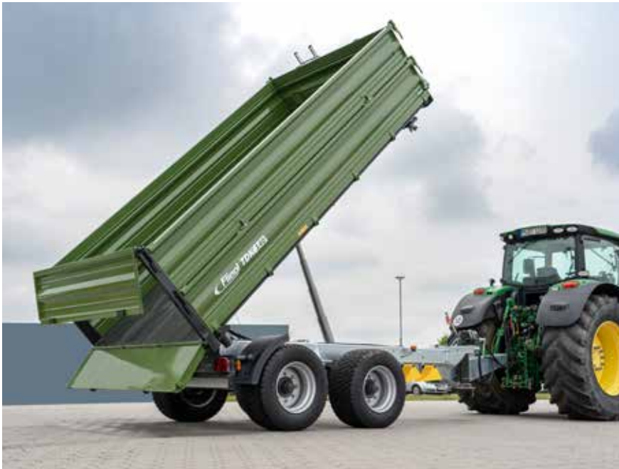
Verze štěrkové klapky s hydraulickou zadní výklopnou záďí 500 mm.
