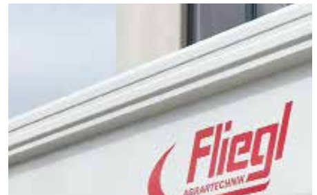
Ztužovací profily lisované a zaoblené z jednoho kusu.
