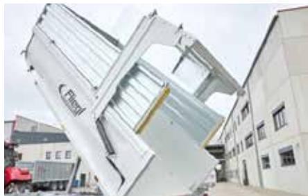
Hydraulické zadní čelo, od modelu TMK 200 S XL. Pozinkovaná sklopná konstrukce.
