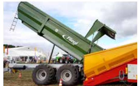
Delší ocas usnadňuje plnění bunkrů
