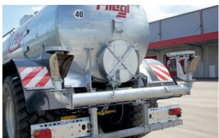
Гидравлический двойной маятниковый распределитель
