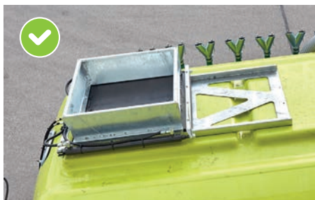
Гидравлическая сдвижная крышка
