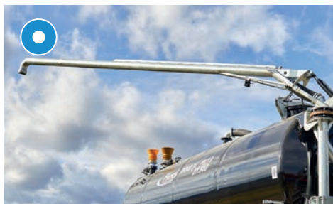
Перегрузочная стрела 6" / длина: 6 м
