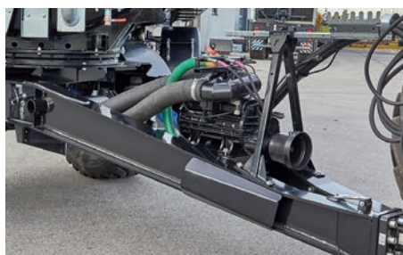
Жаропрочный компрессор 13 500, механический привод
