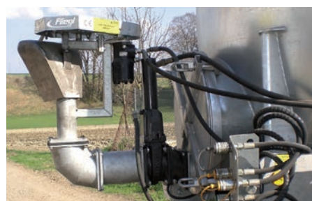
Гидравлический маятниковый распределитель с рабочей шириной 12–18 м.
