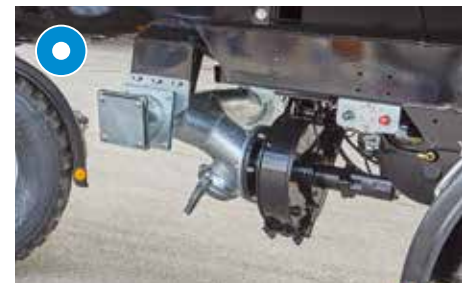
Turbobefüller 8" für beidseitiges Ansaugen
