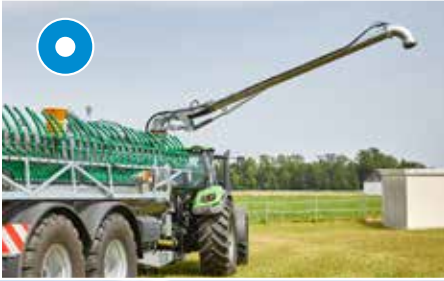
Nur für Pumpfässer: Absaugarm 8", Länge 5 m
