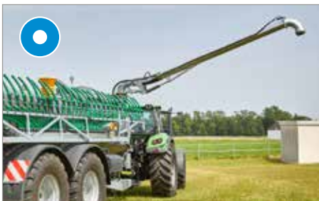
Nur für Pumpfässer: Absaugarm 8", Länge 5 m
