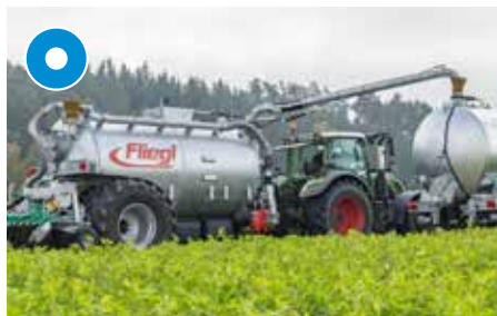
Absaugarm hydraulisch schwenkbar 8°
