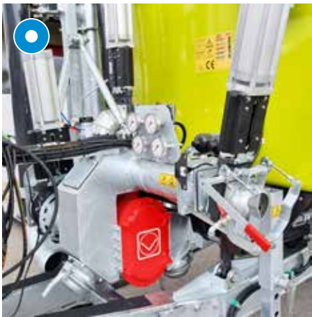
Drehkolbenpumpe »POLYFANT« mit hoher Wartungsfreundlichkeit
