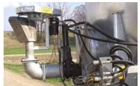
Hydraulischen Pendelverteiler mit einer Arbeitsbreite von 12 bis 18 m.
