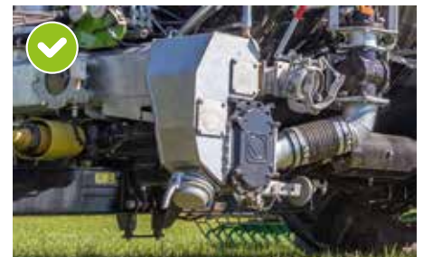
Äußerst wartungsfreundlich: Mechanisch angetriebene Drehkolbenpumpe inkl. Reduziergetriebe
