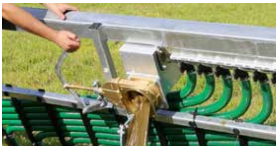
Staukasten für Fremdkörper, mechanische oder hydraulische Entleerung
