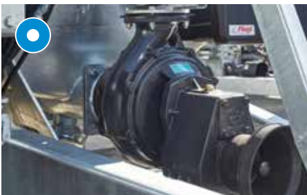
Kreiselpumpe zum Überladen
