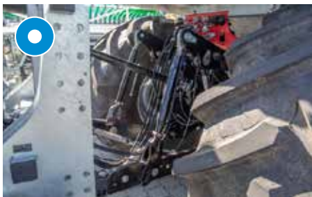
Dreipunkthydraulik wird beim Lenken der Achse mitgeführt
