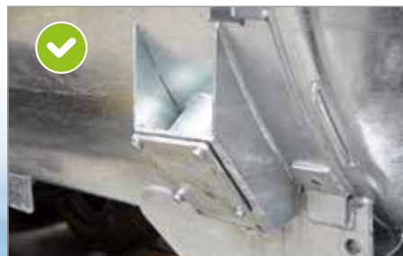
Nur bei Vakuumfass: Serienmäßig mit Blindflansch – vorne rechts und links sowie hinten
