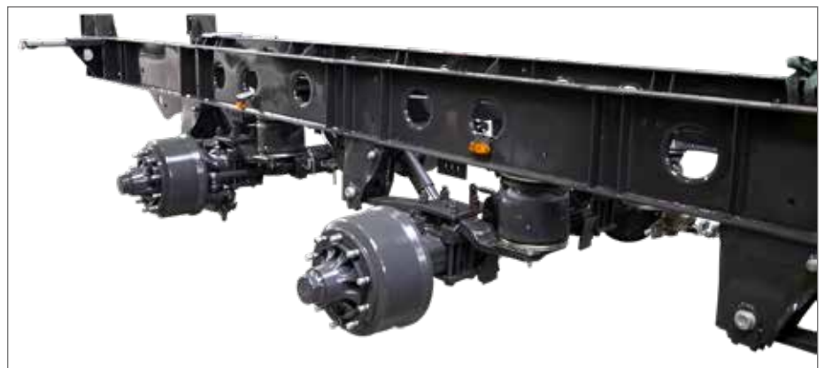
Spezielle Rahmenbauweise aus Feinkornstahl
