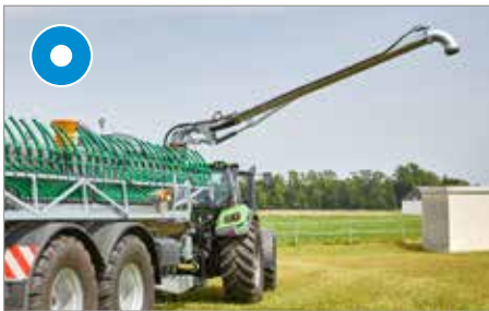
Nur für Pumpfässer: Absaugarm 8", Länge 5 m
