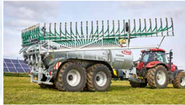
Keine abknickenden Auslaufschläuche durch speziellen Klappmechanismus
