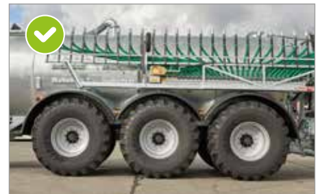
Einzelradausschnitt in Verbindung mit Hydr. Federung
