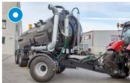
8" Saugrüssel für komfortables Ansaugen
