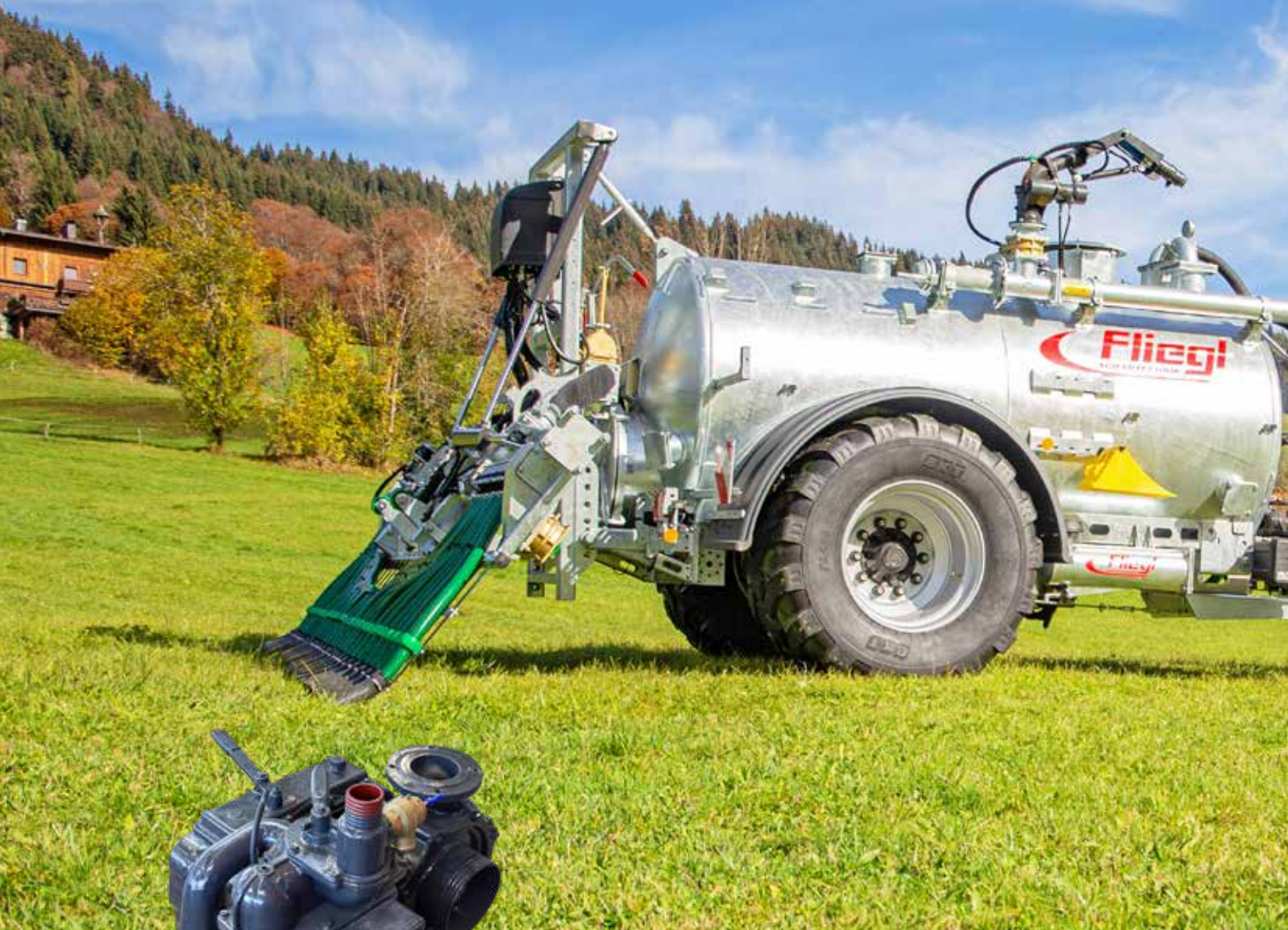
GARDA-Pumpe: Kombination aus Kreiselpumpe und Kompressor
