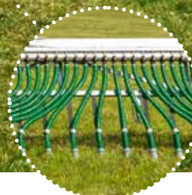
Gleichmäßige Verteilqualität durch kurze Auslaufschläuche
