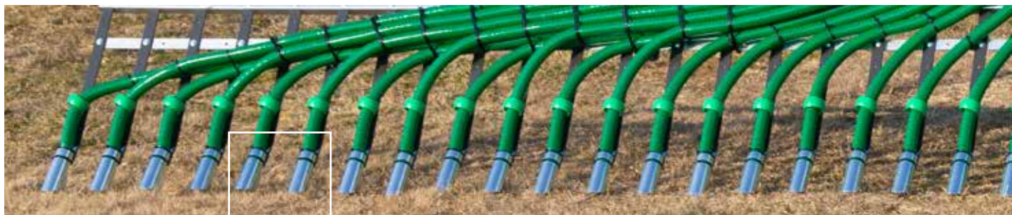
Schlitzkufenabstand von nur 187,5 mm
