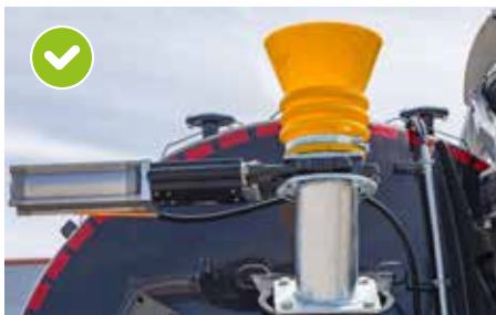
Andocktrichter hinten oben am Fass
