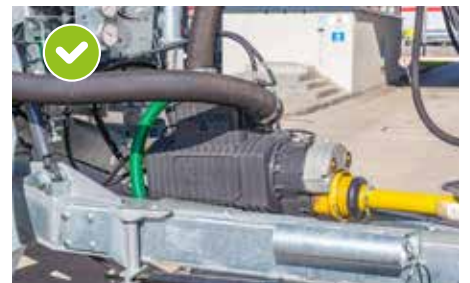
Hitzebeständiger Kompressor Optional: Wassergekühlter Kompressor
