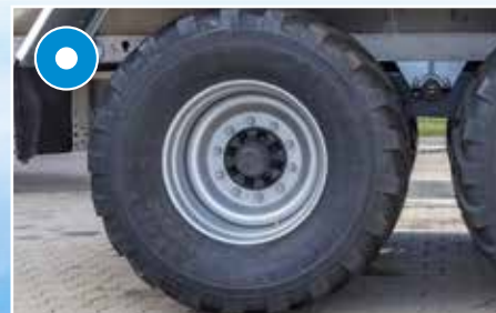
Bereifung bis max. 26,5" möglich
