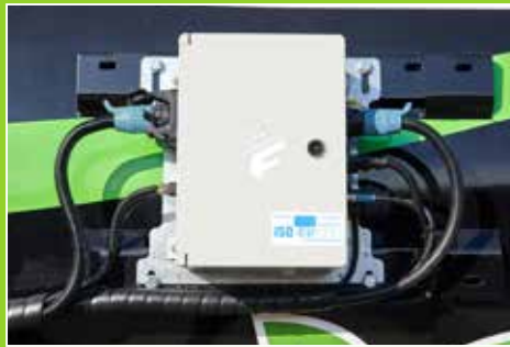
Schaltschrank FFC mit integriertem Jobrechner und ISOBUS-Schnittstelle
