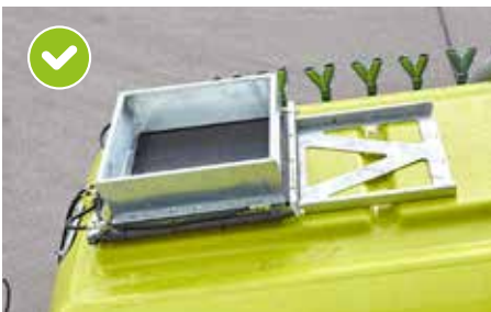
Schubdeckel für externe Befüllung
