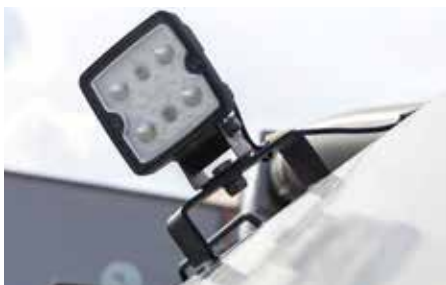
Arbeitscheinwerfer für Ausleuchtung des Verteilers
