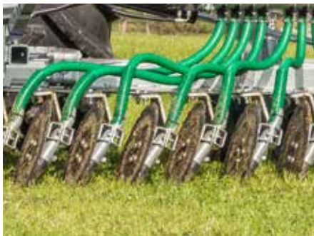
Stufenlose Einstellung der Scheiben
