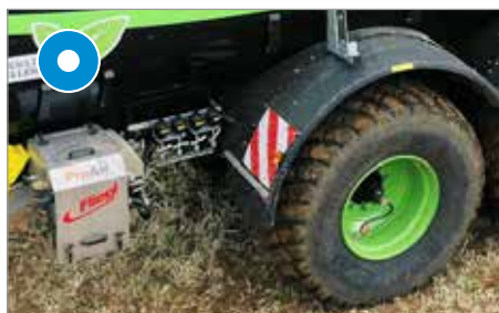
Systém regulace tlaku v pneumatikách
