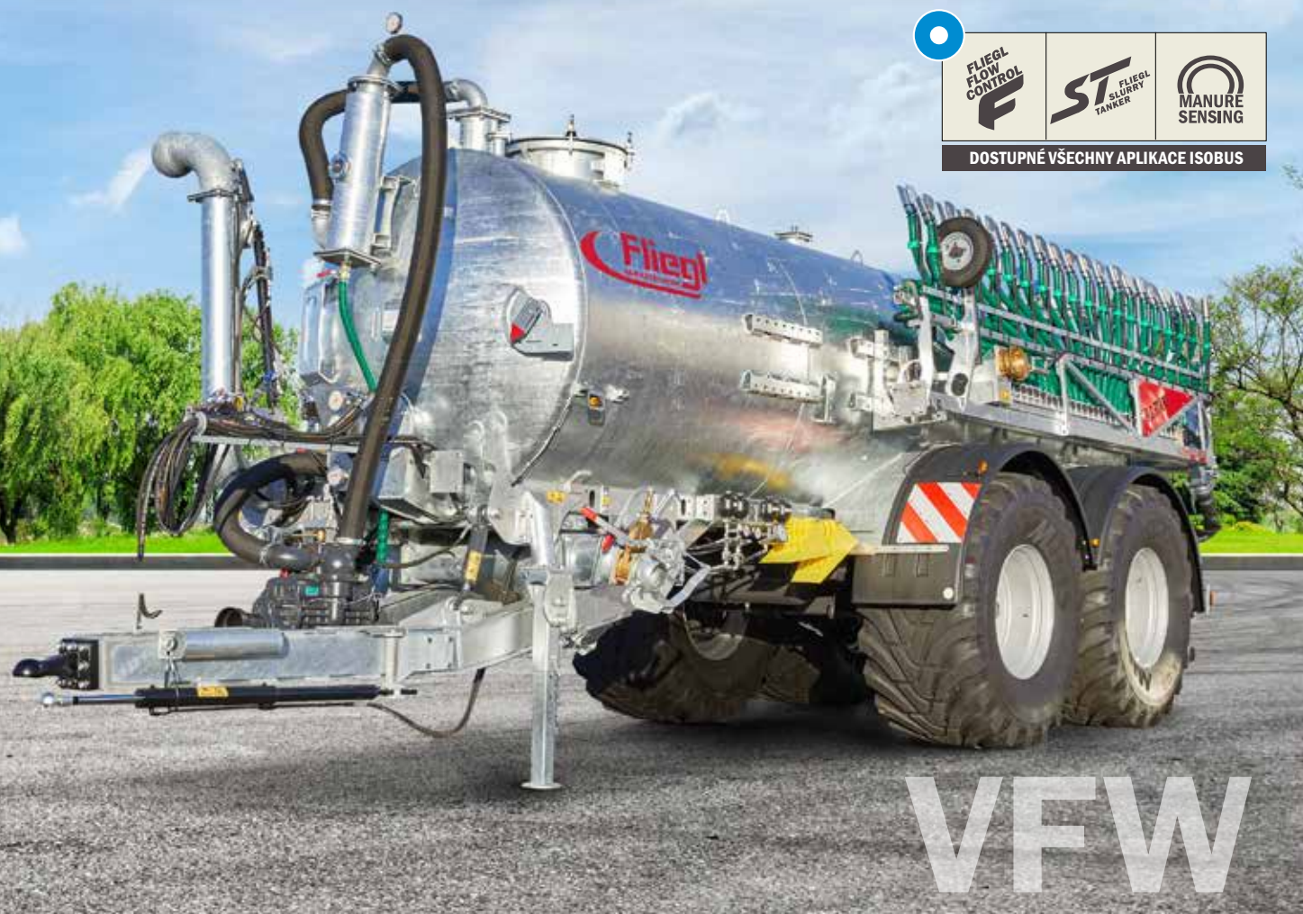
Vakuová cisterna: Turbo plnění uprostřed pod cisternou pro sání z obou stran
