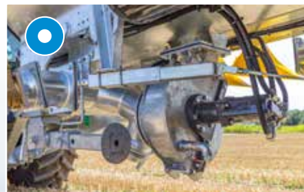
Vakuová cisterna: Turbo plnění uprostřed pod cisternou pro sání z obou stran
