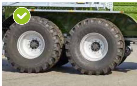
Výřez kola a pneumatiky Pneumatiky 750/60-R30,5"
