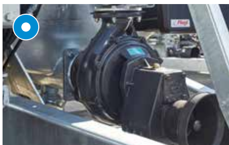
Rotační čerpadlo k provedení překládky
