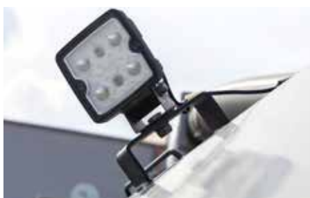
Pracovní reflektory pro osvětlení aplikátoru
