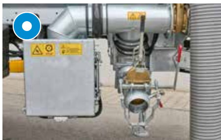
Řezací drtič: K oddělení cizích těles a drcení dlouhé slámy
