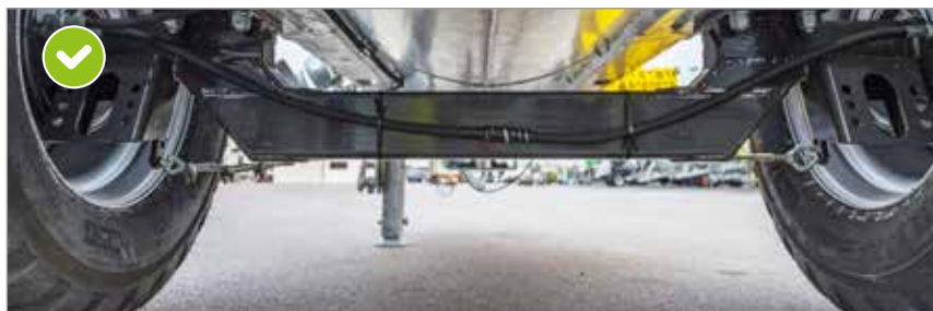
Zalomená náprava v provedení 5000 - 8600 litrů Nízko položené těžiště zajišťuje optimální jízdní vlastnosti při jízdě ve svahu
