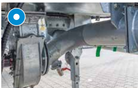
Turboplňení hydraulické, uprostřed pod cisternou
