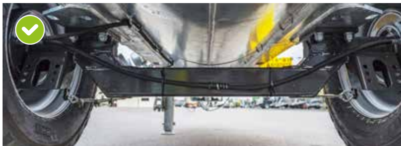
Zalomená náprava v provedení 5000 - 8600 litrů Nízko položené těžiště zajišťuje optimální jízdní vlastnosti při jízdě ve svahu
