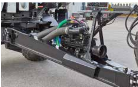
Tepelně odolný kompresor 13.500 mechanicky poháněný
