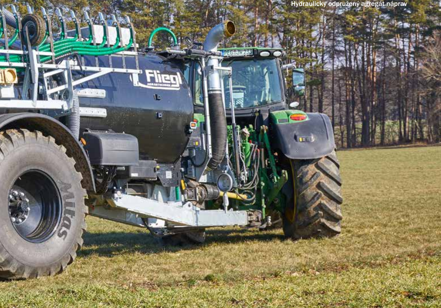
Hydraulicky odpružený agregát náprav
