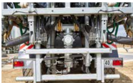
Fliegl SKATE 210 s naklápěcím rámem pro lepší vyrovnání svahů (jen u typu SKATE 210/240)
