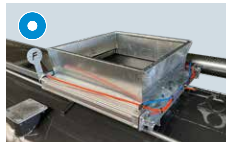
Pneumatické posuvné víko pro externí plnění shora
