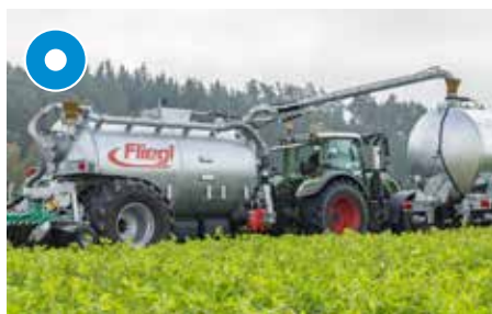
Hydraulické otočné sací rameno 8"
