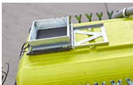
Posuvné víko 600 x 600 mm pneumatické nebo hydraulické
