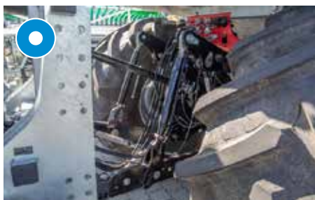
Tříbodová hydraulika je při natáčení nápravy vedena spolu s nápravou
