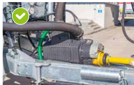
Vývěva odolná proti vysokým teplotám Volitelně: Vodou chlazená vývěva
