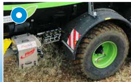
Systém regulace tlaku v pneumatikách
