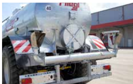
Dvojitý otočný rozprašovač hydraulický
