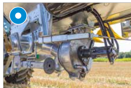
Vakuová cisterna: Turboplnění uprostřed pod cisternou pro sání z obou stran
