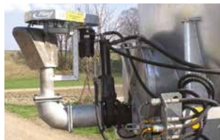
Hydraulický otočný rozprašovač s pracovní šířkou 12 až 18 m.
