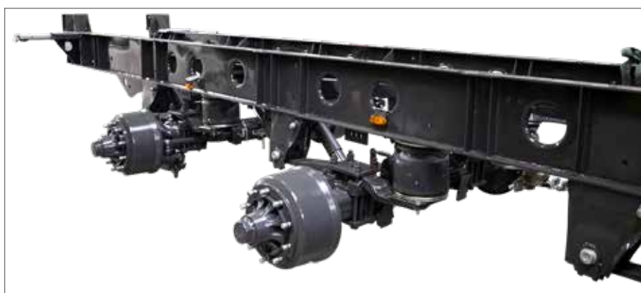
Speciální rámová konstrukce z jemnozrnné oceli
