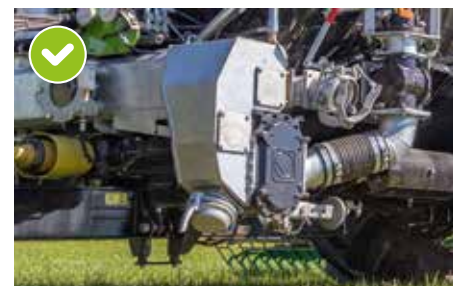
Mimořádně snadná údržba: Mechanicky poháněné čerpadlo s otočným pístem vč. redukční převodovky
