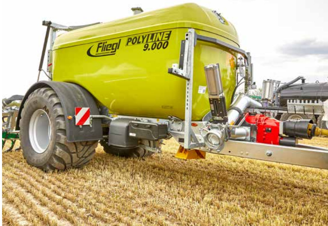
Cisterna Poly Line 9000 jednonápravová s rotačně pístovým čerpadlem
