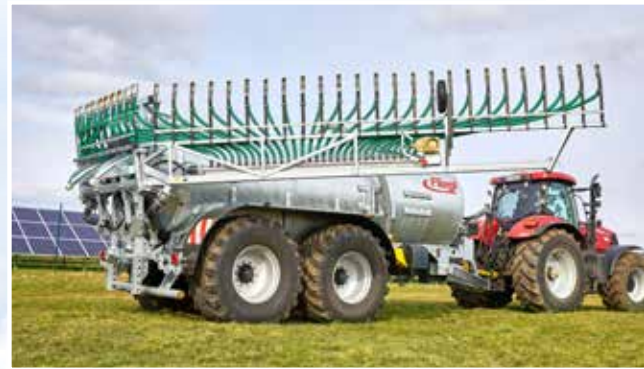
Žádné zlomené výtokové hadice pomocí speciálního sklápěcího mechanismu
