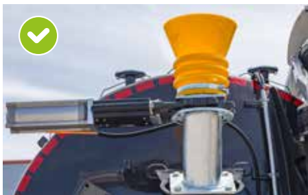
Skladovací nálevka vzadu nahoře na cisterně
