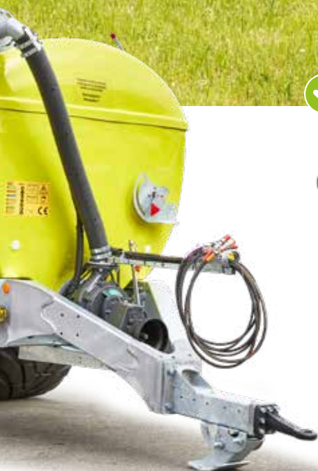
Rotační čerpadlo Elba Battioni 3500 nebo 6500 l/min.
