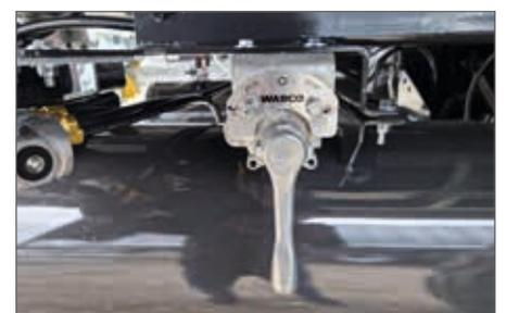
Heben- und Senkenventil bei Luftfederung
