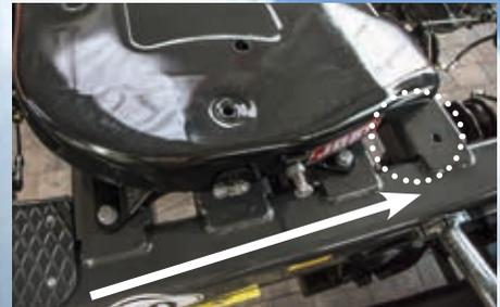
Mechanische Sattelplattenverstellung für Einachs- und Tandem-Dolly
