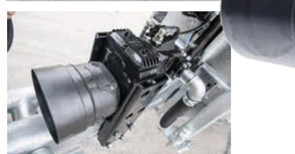
Bordhydraulik für max. Leistung unabhängig vom Zugfahrzeug
