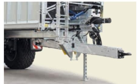
Durchgehend hydr. gefederte Zugeinrichtung für Untenanhängung
