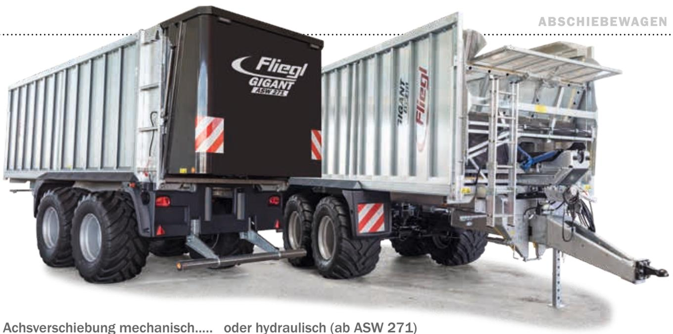
Achsverschiebung mechanisch..... oder hydraulisch (ab ASW 271)
