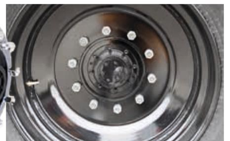
Der Radialkolbenmotor sorgt bei Bedarf für zusätzliche Antriebsleistung.
