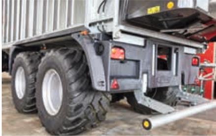
Kotflügel, Radabdeckungen und Heckschürze aus speziell gefertigten Kunststoffteilen sorgen für eine saubere Oberfläche und geringeres Verletzungsrisiko für Mensch und Maschinen.
