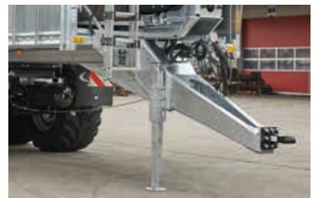
Zugholm ungefedert, drehbar für Oben- und Untenanhängung
