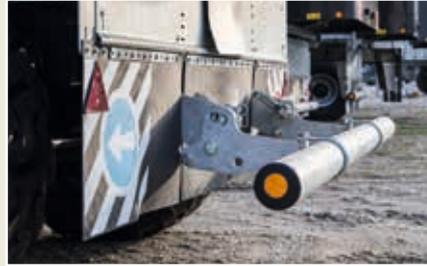
Unterfahrerschutz mechanisch klappbar
